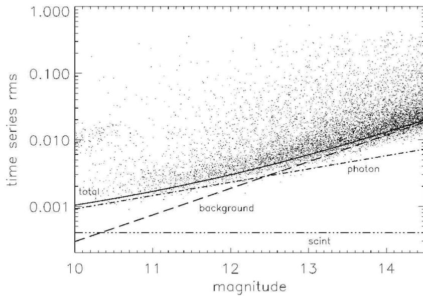
FIGURE 6.24 – Diagramme RMS-magnitude obtenu avec le télescope de 20 cm BEST, sur des poses de 240 s pendant 3 heures d’observations [Rauer et al., 2004]. La précision est de  $\sim 1$  mmag pour les magnitudes 10. Les bruits de photon, de fond de ciel et de scintillation sont indiqués.
