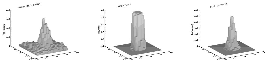
FIGURE 2.16 – Photométrie d'ouverture effectuée par SimPhot, dans le cas d'une ouverture circulaire, pour une étoile de magnitude 14, un temps de pose de 30 s et un télescope de diamètre 40 cm. L'image initiale (gauche) est multipliée par une ouverture, par exemple circulaire avec un poids pour les pixels de bord (milieu), pour extraire le signal de l'étoile cible (droite).
