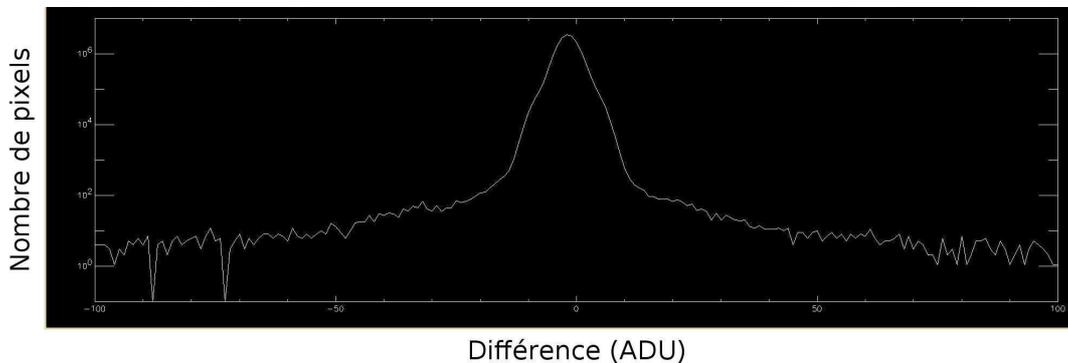
FIGURE 3.14 – Histogramme de la différence de deux darks moyens réalisés à 1 mois d'intervalle, pour la caméra ASTEP Sud.
