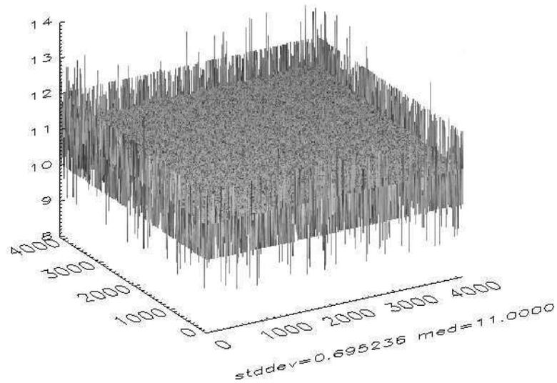
FIGURE 6.9 – Soustraction de deux bias pris avec une différence de température de  $\sim 4^\circ\text{C}$ . La déviation standard de 0.7 ADU montre qu'il n'y a pas de dépendance spatiale de la variation du bias avec la température de l'électronique de la caméra.
