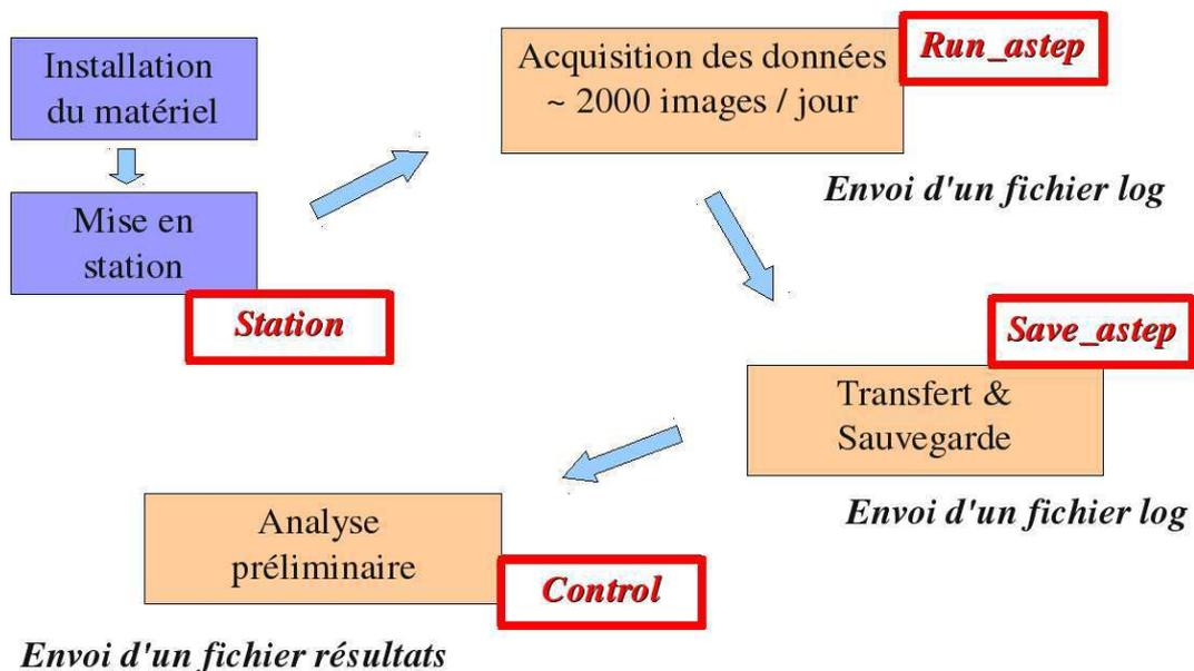
FIGURE 4.18 – Principe de fonctionnement d'ASTEP Sud. Les opérations réalisées pendant l'été sont en bleu, et les étapes du fonctionnement pendant l'hiver en orange. Les logiciels utilisés sont notés en rouge.
