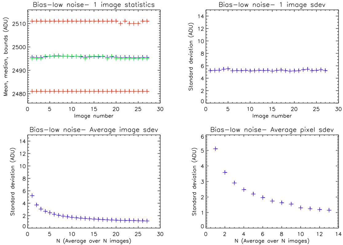
FIGURE 3.8 – Statistiques sur les images de bias prises en lecture lente pour la caméra ASTEP 400. Moyenne (bleu), médiane (vert), et intervalle contenant 99 % des pixels (rouge), pour chacune des  $\sim 30$  images (haut gauche), déviation standard pour chacune des  $\sim 30$  images (haut droite), déviation standard d’une image moyenne faite à partir de  $N$  images (bas gauche), et déviation standard par pixel sur plusieurs images moyennes de  $N$  images (bas droite).
