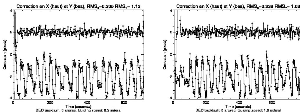
FIGURE 8.1 – Correction appliquée en X et Y, équivalente à la distance au point de fonctionnement, pour une étoile à  $45^\circ$  de déclinaison, avec différents paramètres pour la vitesse de guidage : 0.5 s (gauche) et 1 s (droite). Le backlash n'est pas compensé. Les courbes sont centrées sur  $\pm 2$  px pour une bonne lisibilité.
