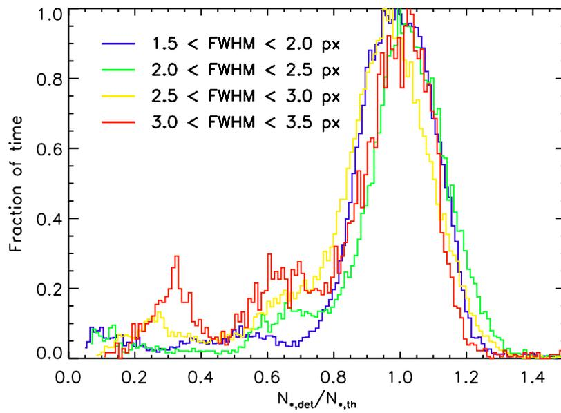
FIGURE 5.6 – Histogramme du rapport du nombre d'étoiles détectées sur le nombre d'étoiles théorique pour les différentes plages de FWHM, dans la 2<sup>de</sup> approche. Un critère *ad hoc* serait là encore nécessaire pour déduire la fraction de temps photométrique, et une incertitude serait engendrée par les résultats différents pour chaque plage de FWHM.
