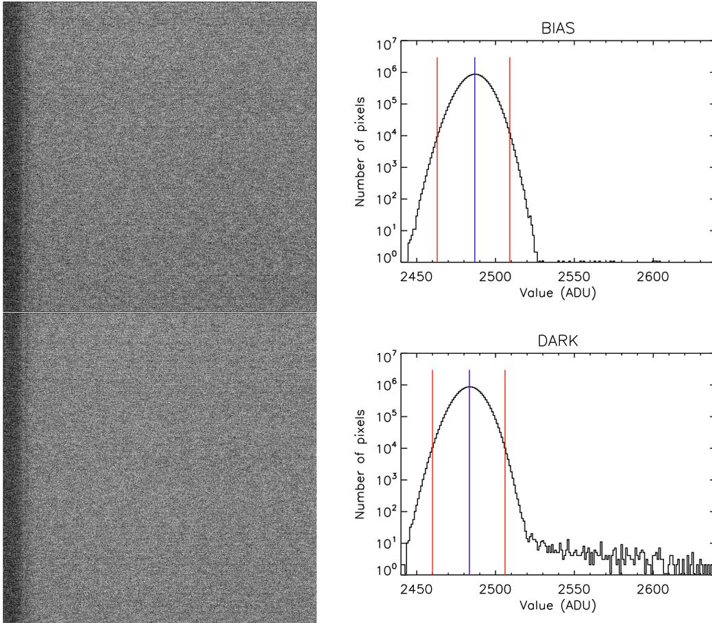
FIGURE 6.4 – Exemple de bias (haut) et de dark (bas) accompagnés de leur histogramme. La médiane est indiquée en bleu et les limites contenant 99 % des pixels en rouge. Les pixels chauds constituent la queue de l’histogramme du dark.
