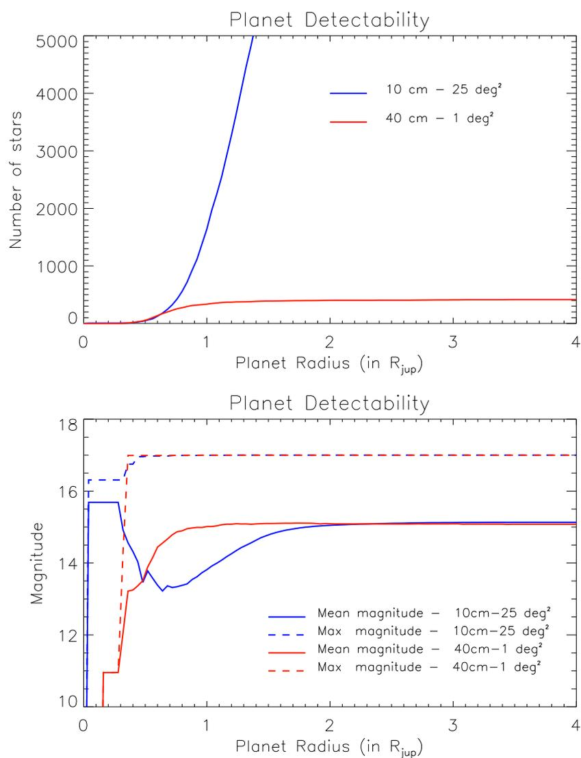
FIGURE 4.3 – Haut : Nombre d'étoiles pour lesquelles une planète de rayon  $R_p$  serait détectée. Bas : Magnitudes moyenne (ligne pleine) et maximale (ligne pointillée) de ces étoiles. Les courbes rouges et bleues correspondent respectivement aux configurations 40 cm /  $1^\circ^2$  et 10 cm /  $25^\circ^2$ .
