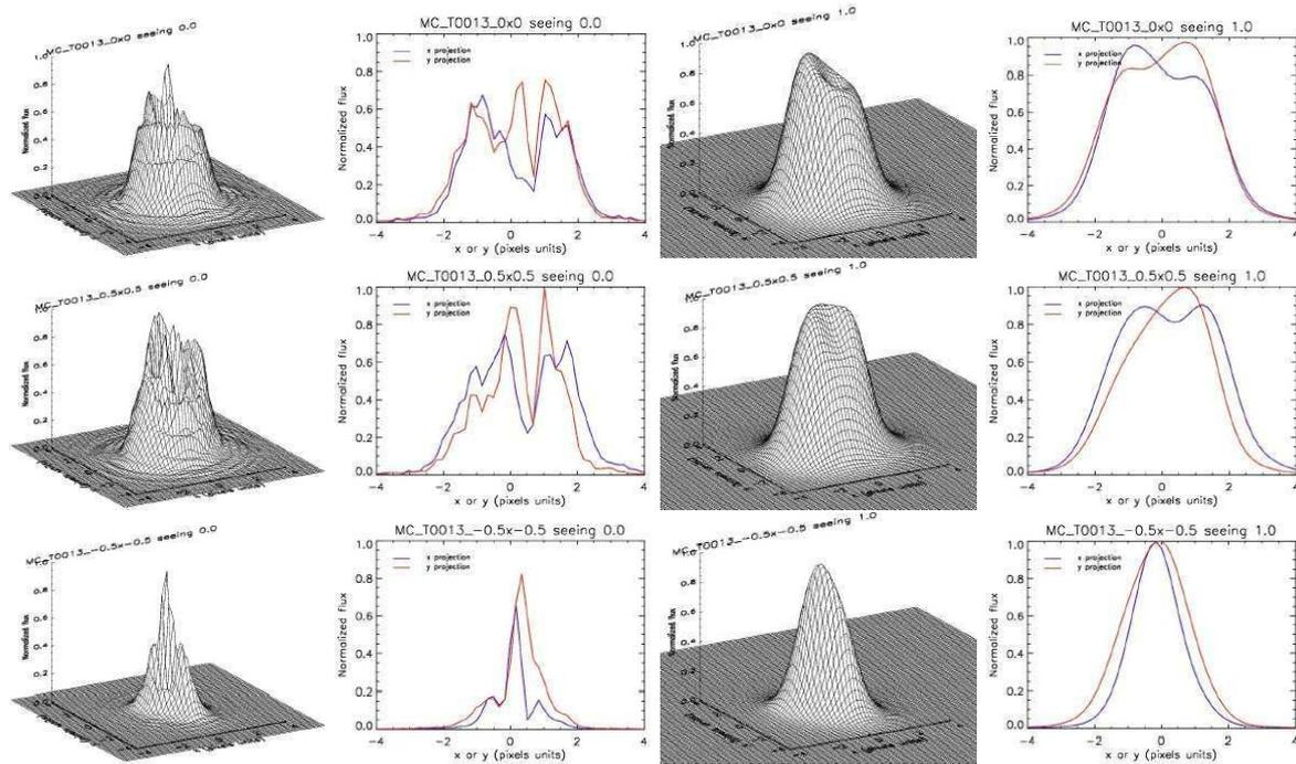
FIGURE 7.13 – PSF issue des simulations de tolérancements et utilisée pour les simulations photométriques, en 3 dimensions et en coupe selon  $x$  (bleu) et  $y$  (rouge), avant (gauche) et après (droite) convolution avec une gaussienne de 1 arcseconde, au centre du champ (haut), dans la diagonale à  $0.5^\circ \times 0.5^\circ$  (milieu) et à  $-0.5^\circ \times -0.5^\circ$  (bas).
