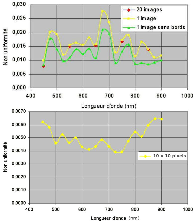
FIGURE 3.16 – Non-uniformités globales (haut), sur une image (bas), sur une moyenne de 20 images (rouge) et sur 1 image en excluant les bords (vert), puis locales (droite), sur une région de  $10 \times 10$  pixels au centre du CCD, pour le CCD ASTEP Sud.
