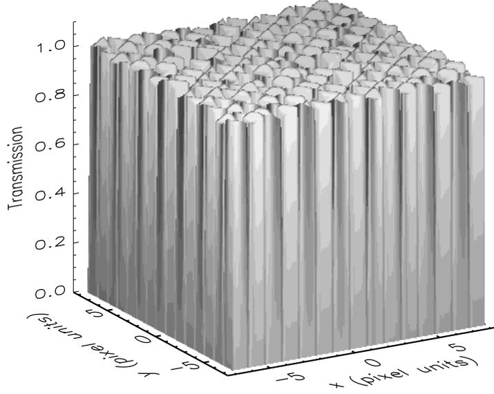
FIGURE 2.12 – Matrice CCD de  $15 \times 15$  px simulée par SimPhot. Les bruits inter et intrapixel sont fixés à 1 % et les électrodes occupent 30 % de la surface du pixel.
