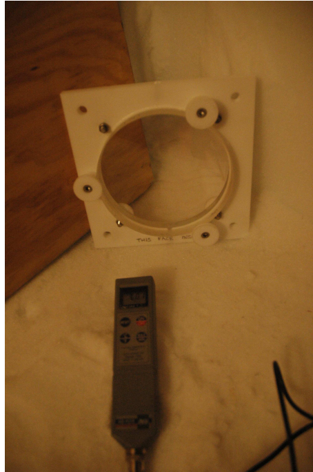
FIGURE 4.10 – Test du hublot dans un congélateur à -80^{\circ}\text{C} . On n’observe aucune formation de givre entre les deux lames.
