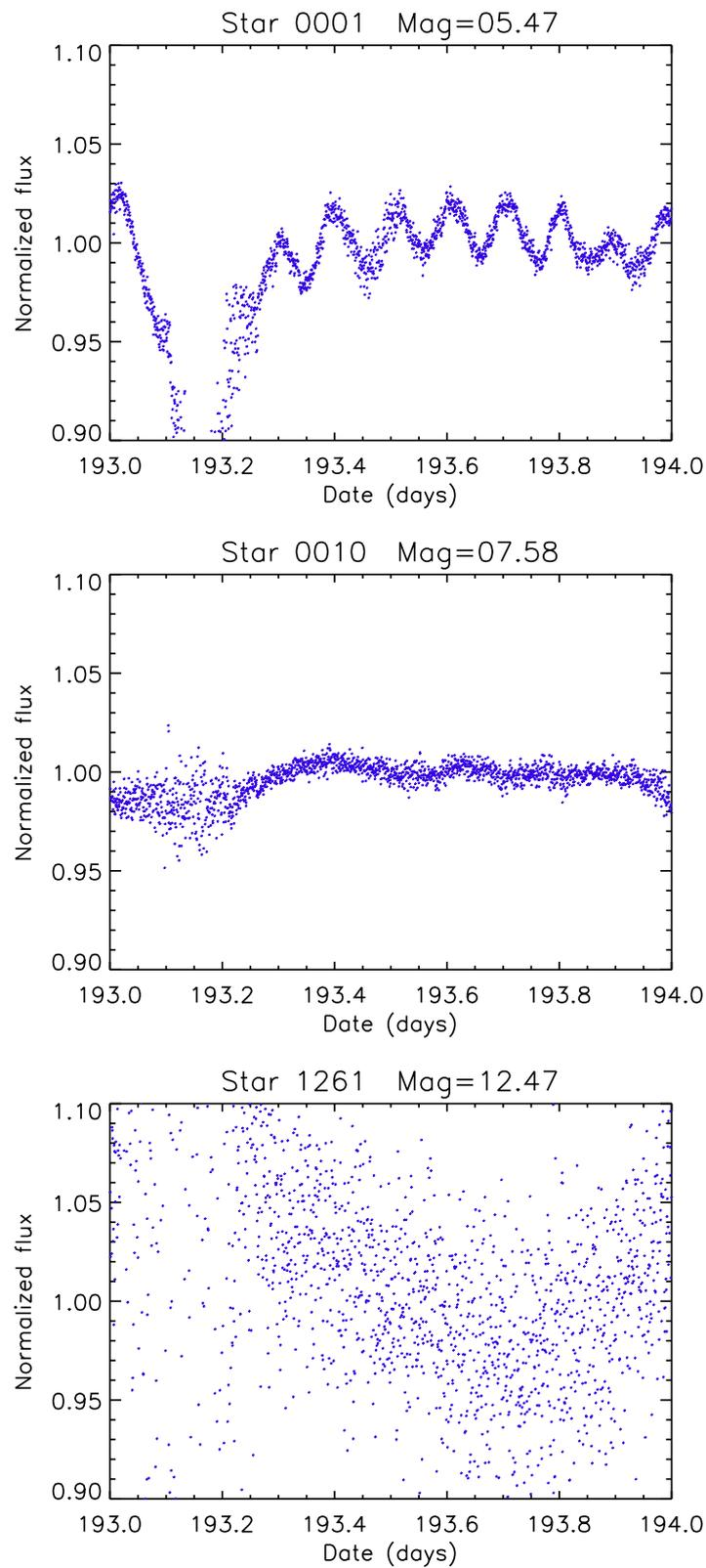
FIGURE 6.14 – Exemples de courbes de lumière obtenues sur la journée de 12 juillet 2008 :  $\sigma$  Octantis, de magnitude 5.47 (haut), une étoile brillante de magnitude 7.58 (milieu), et une étoile de magnitude 12.47 (bas).
