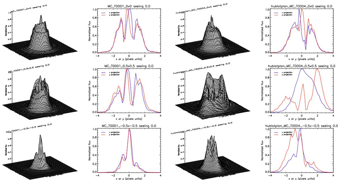
FIGURE 7.14 – PSF issues des simulations de tolérancements classiques avec un hublot ménisque (gauche) et plan (droite), en 3 dimensions et en coupe selon  $x$  (bleu) et  $y$  (rouge), au centre du champ (haut), dans la diagonale à  $0.5^\circ \times 0.5^\circ$  (milieu) et à  $-0.5^\circ \times -0.5^\circ$  (bas).
