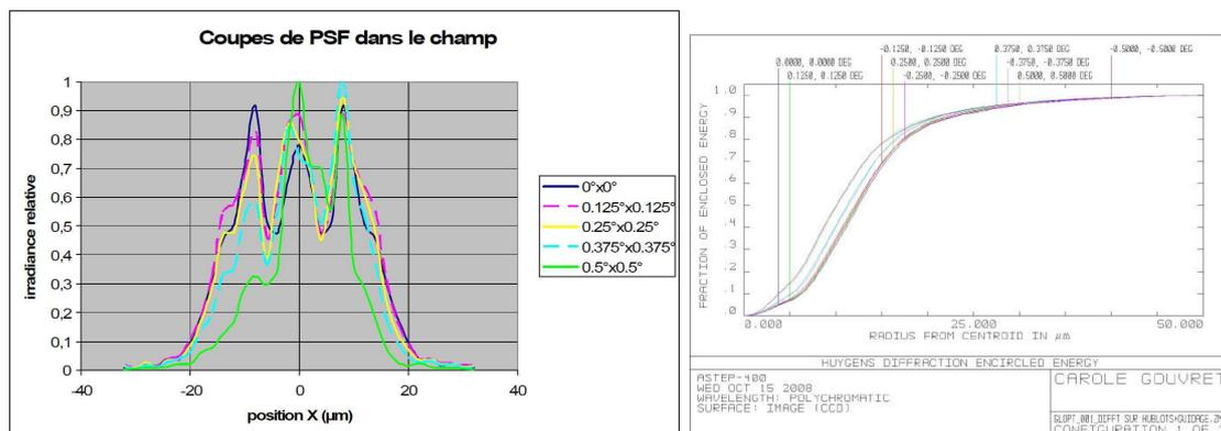
FIGURE 7.2 – PSF finale vue en coupe selon la direction x (gauche), et énergie intégrée en fonction du rayon d'intégration (droite), en différents points de la diagonale du champ :  $0^\circ$  (bleu foncé),  $0.125^\circ$  (rose),  $0.25^\circ$  (jaune),  $0.375^\circ$  (bleu clair),  $0.5^\circ$  (vert).
