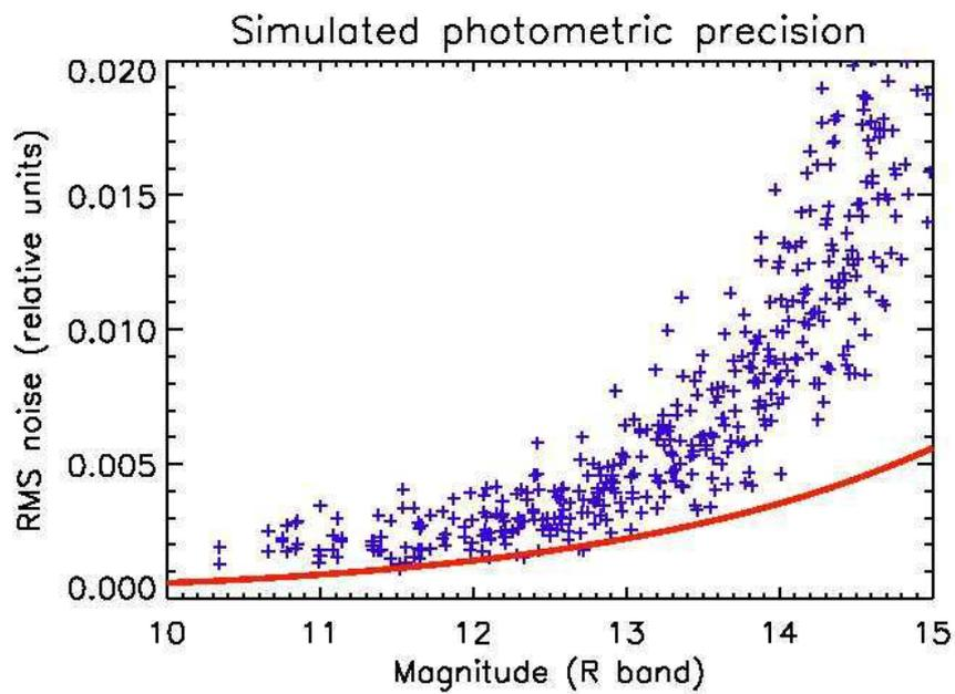
FIGURE 4.5 – Bruit RMS des courbes de lumière simulées en fonction de la magnitude. Chaque étoile dans une zone de  $1^{\circ 2}$  autour du pôle sud céleste est représentée par une croix. La courbe rouge indique le bruit de photons.
