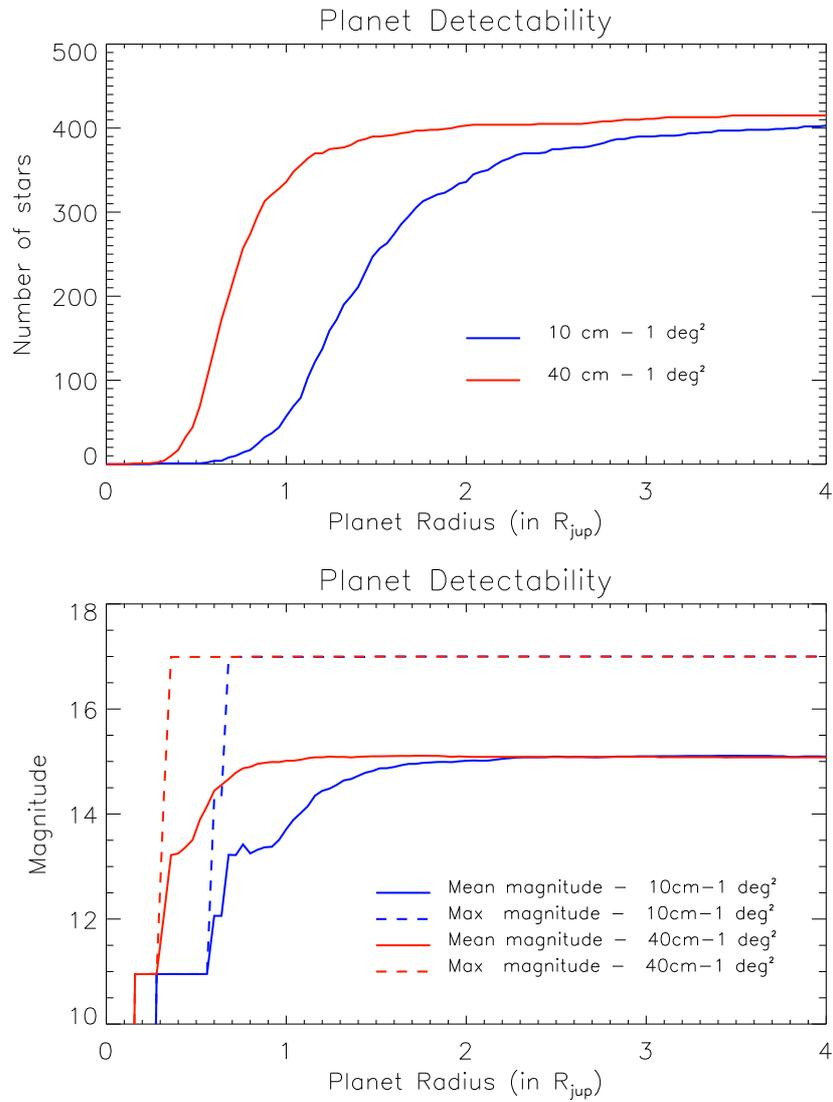
FIGURE 4.4 – Haut : Nombre d'étoiles pour lesquelles une planète de rayon  $R_p$  serait détectée. Bas : Magnitudes moyenne (ligne pleine) et maximale (ligne pointillée) de ces étoiles. Les courbes rouges et bleues correspondent respectivement aux 40 cm et 10 cm, avec un champ identique de  $1^{\circ 2}$ .
