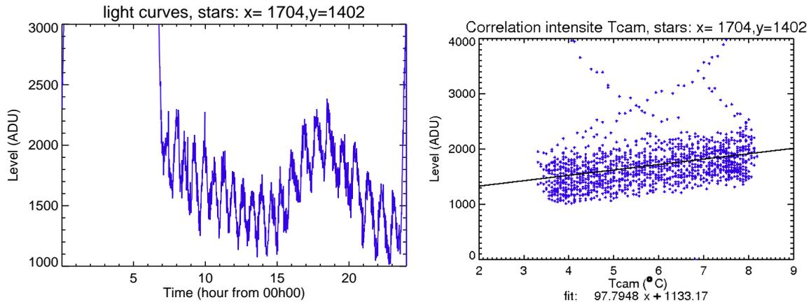
FIGURE 6.8 – Courbes de lumière sur une zone de  $6 \times 6$  px sans étoiles (gauche), et corrélation avec la température de l'électronique de la caméra (droite). On observe des oscillations de 500 ADU, soit  $\sim 100$  ADU/°C, sur une période d'une heure.
