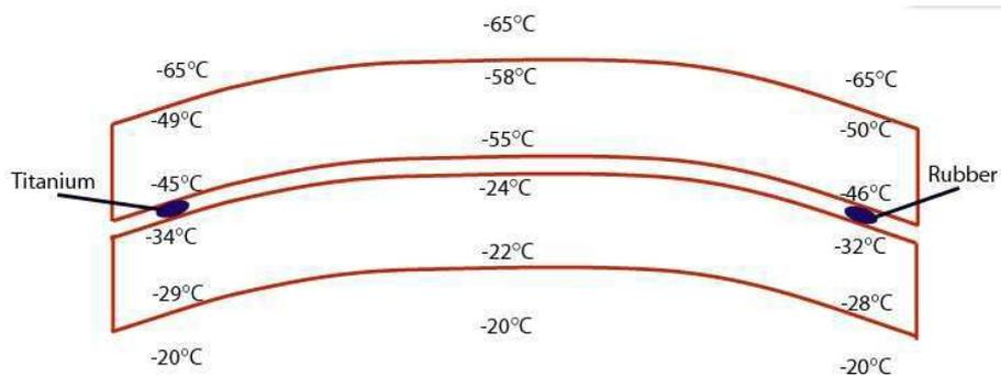
FIGURE 7.9 – Température des différentes couches et interfaces du hublot double vitrage, dans la configuration thermique envisagée à Concordia (température extérieure :  $-65^{\circ}\text{C}$ , température de l’enceinte :  $-20^{\circ}\text{C}$ ).
