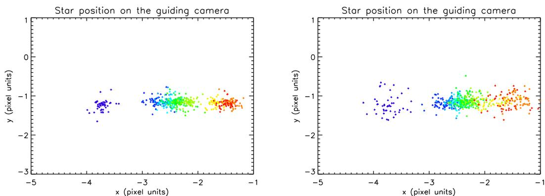
FIGURE 7.20 – Position du centre de l'étoile guide sur des images simulées par SimPhot dans le cas d'une étoile fixe, pour des PSF de différentes focalisations :  $-500$  (indigo),  $-300$  (bleu roi),  $-100$  (bleu),  $-50$  (turquoise),  $0$  (vert),  $+50$  (vert clair),  $+100$  (jaune),  $+300$  (orange) et  $+500$  (rouge)  $\mu\text{m}$ , pour une étoile guide de magnitude 8 (gauche) et 10 (droite). Chaque point représente la position de l'étoile guide sur une image.
