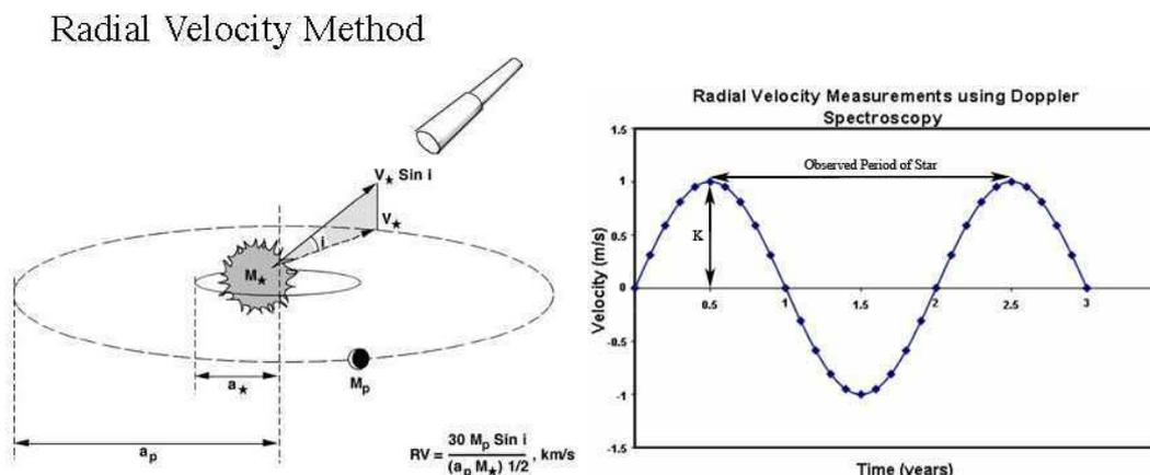
FIGURE 1.1 – Détection d'une planète extrasolaire par vitesses radiales. L'étoile et la planète sont en mouvement autour du barycentre du système (gauche), et l'amplitude  $K$  de la courbe de vitesses radiales (droite) permet de connaître la masse de la planète à un facteur  $\sin i$  près.
