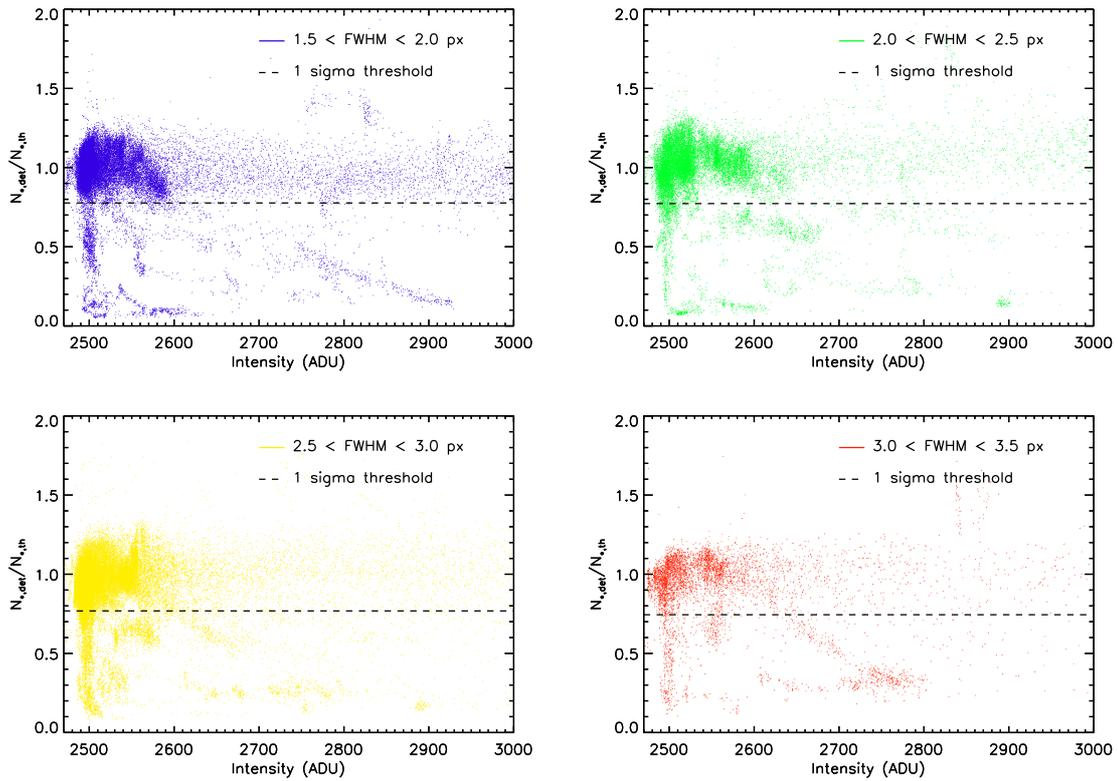
FIGURE 5.4 – Rapport du nombre d'étoiles détectées sur le nombre d'étoiles théorique en fonction de l'intensité pour les différentes plages de FWHM, dans la 2<sup>nde</sup> approche. La limite à  $1\sigma$  est indiquée en pointillés.
