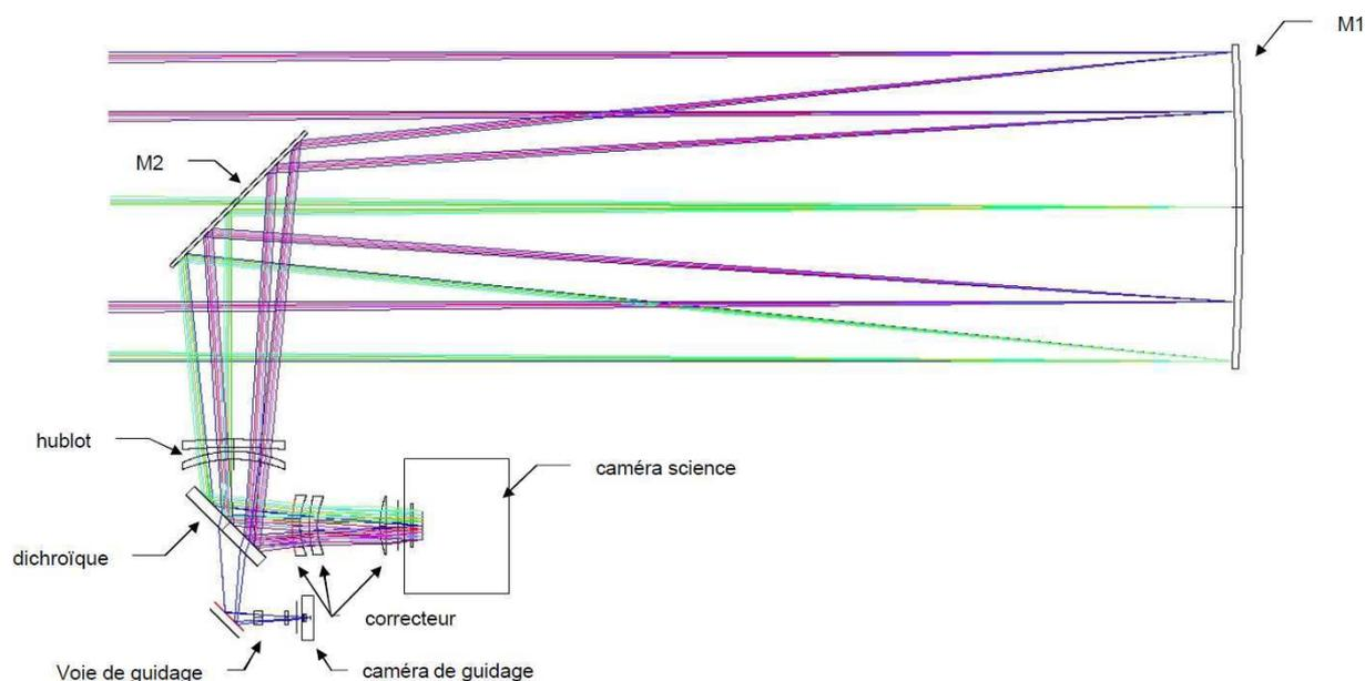
FIGURE 7.1 – Schéma optique du télescope ASTEP 400.
