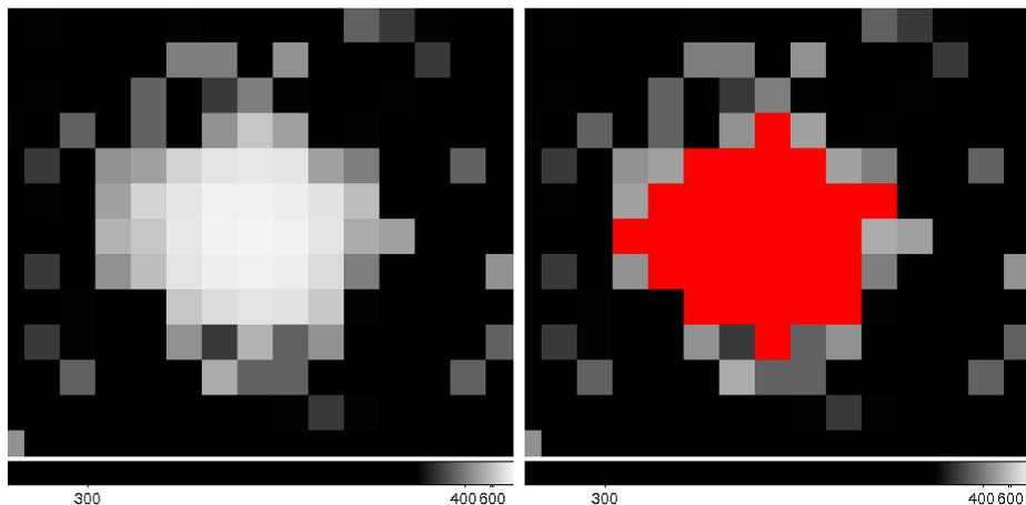
FIGURE 2.6 – Exemple d'extraction du signal à partir des pixels brillants. Sur l'image originale (gauche), un seuil à  $3\sigma$  au dessus du fond de ciel permet d'isoler les pixels contenant le signal, représentés en rouge (droite).
