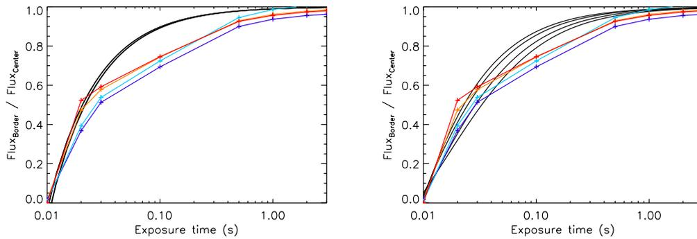
FIGURE 3.19 – Tentatives d’ajustement (en noir) du rapport des flux entre le bord et le centre de l’image en fonction du temps de pose (mêmes couleurs que figure 3.18), par une fonction  $r = 1 - t_s/t$  pour  $t > t_s$  et  $r = 0$  sinon (gauche), et  $r = 1 - t_s/(t - t_0)$  pour  $t > t_s$  et  $r = 0$  sinon (droite). L’ajustement n’est pas parfait, et il pourrait en fait s’agir d’un comportement bi-modal.
