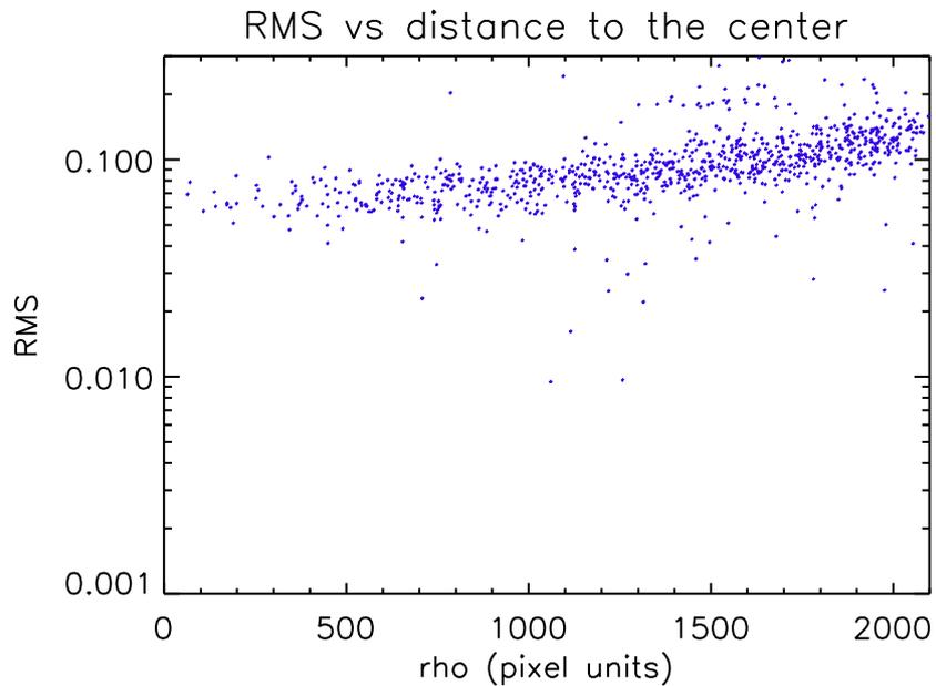
FIGURE 6.19 – Bruit RMS en fonction de la distance radiale  $\rho$  pour les étoiles dans la plage  $13 < m_R < 13.5$  après amélioration de l’algorithme de reconnaissance de champ. On gagne un facteur 2 en bord de champ (voir figure 6.16), et on a un facteur 2 entre le centre et le bord du champ. Le bruit reste élevé.
