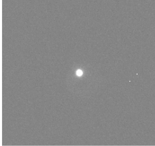
FIGURE 8.10 – Exemple d'imagerie de \sim 250 \times 250 px obtenue à l'issue des premiers réglages optiques d'ASTEP400 à Concordia, le 28 novembre 2009, au centre du champ. Seule l'étoile Canopus est visible de jour, grâce à un filtre H\alpha .
