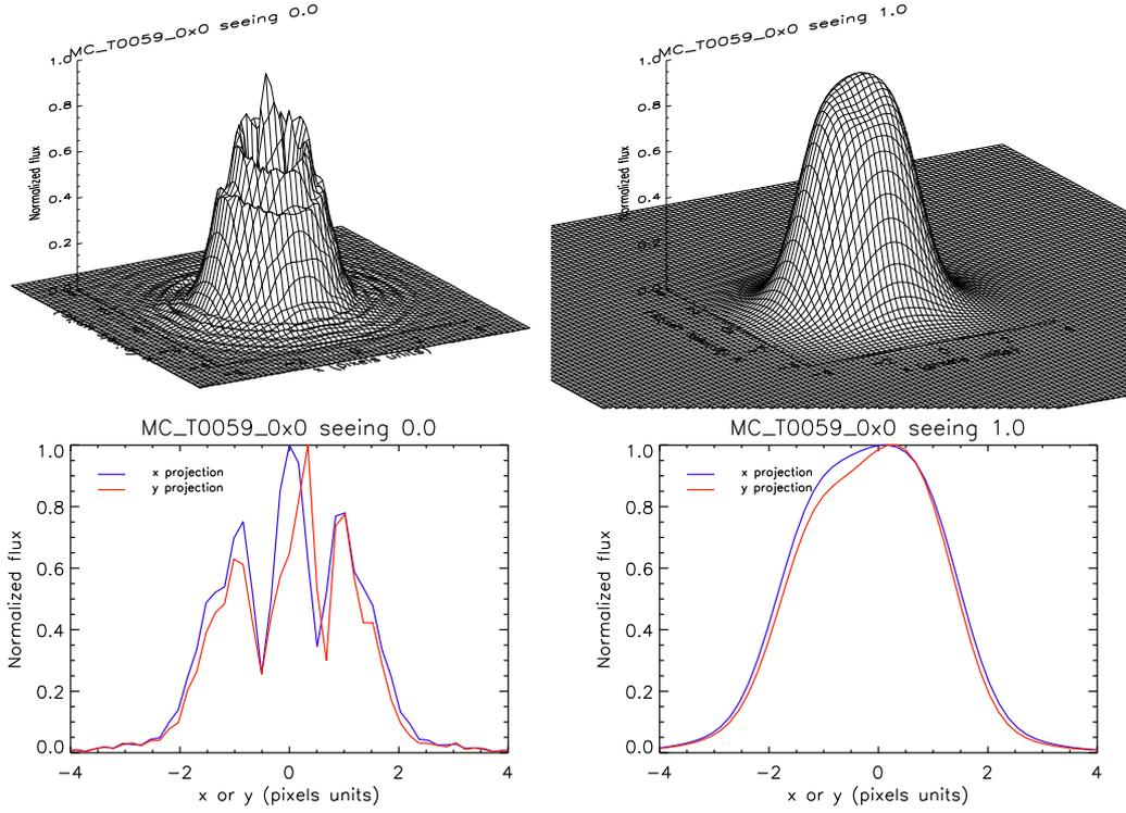
FIGURE 2.13 – Exemple de PSF avant (gauche) et après (droite) convolution par un seeing de 1 arcsec, vue en 2 dimensions (haut) et en coupe (bas) selon x (bleu) et y (rouge). Le seeing est modélisé par une gaussienne de 1 arcsec de largeur à mi-hauteur.
