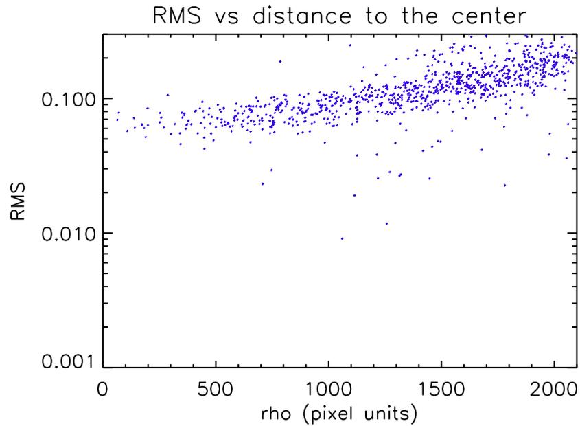
FIGURE 6.16 – Niveau de bruit pour les étoiles de magnitude  $13 < m_R < 13.5$  en fonction de la distance radiale  $\rho$ . La dispersion augmente avec  $\rho$ , d'un facteur 4 entre le centre et le bord du champ.
