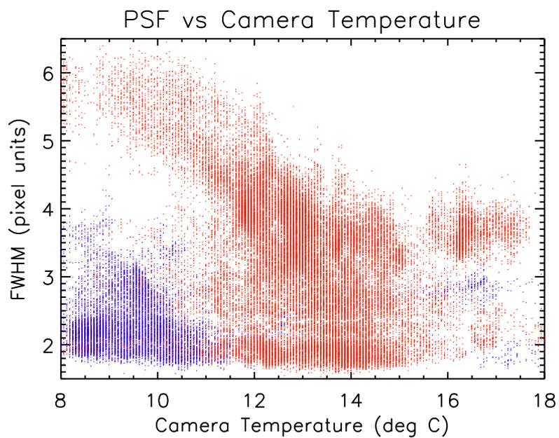
FIGURE 5.12 – Corrélation entre la taille des PSF et la température de la caméra pour l'ensemble des données acquises entre le début de la campagne et le 1<sup>er</sup> juillet 2009, avant (bleu) et après (rouge) le 21 mai. Après le 21 mai, la PSF est dégradée et la corrélation apparaît clairement.
