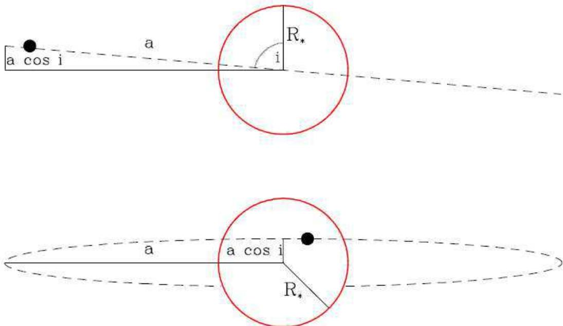
FIGURE 1.5 – Géométrie d'un transit, avec  $a$  le demi-grand axe orbital,  $i$  l'inclinaison, et  $R_*$  le rayon de l'étoile, vu de côté avec l'observateur à gauche (haut), et vu de face (bas). La planète est en noir et l'étoile en rouge. Figure adaptée de Sackett [1999].
