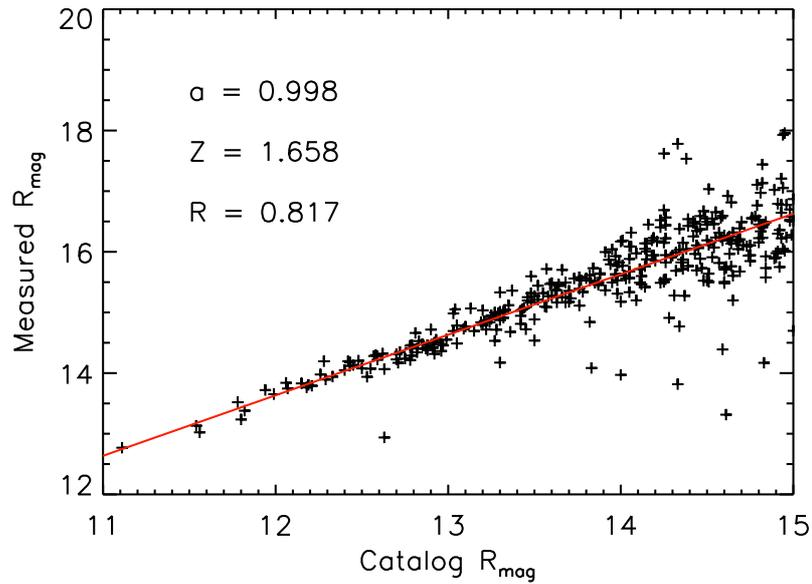
FIGURE 6.21 – Comparaison entre magnitudes instrumentales et magnitudes du catalogue GSC2.2. L’ordonnée à l’origine  $Z$  de la régression linéaire permet de calibrer les magnitudes instrumentales.
