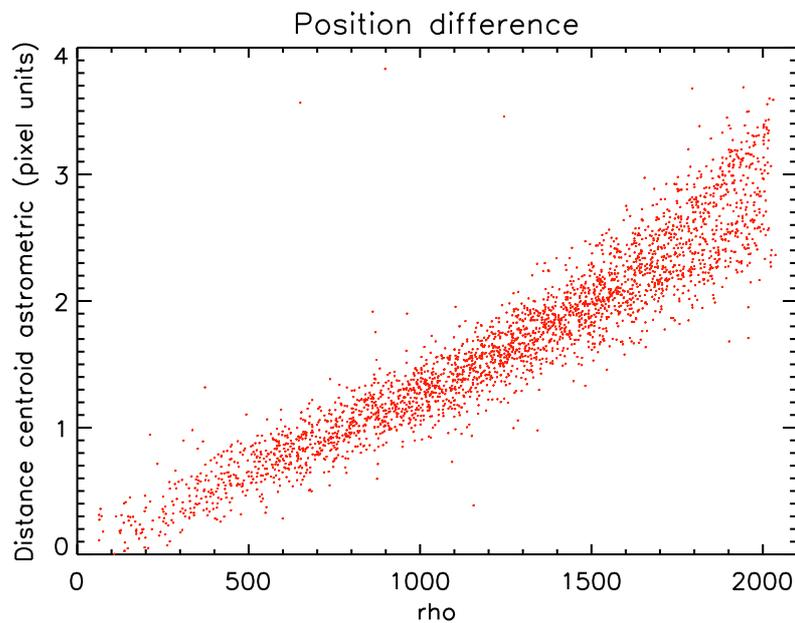
FIGURE 6.17 – Différence entre les positions calculées par l'algorithme de reconnaissance de champ et par détermination du centroïde, en fonction de la distance radiale  $\rho$ . On a une corrélation nette.
