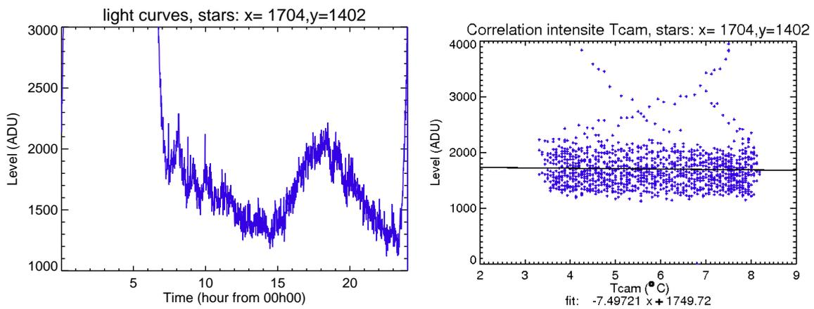
FIGURE 6.10 – Courbes de lumière sur une zone de  $6 \times 6$  px sans étoiles (gauche), et corrélation avec la température de l'électronique de la caméra (droite), après correction de l'effet des variations de cette température. On diminue largement les oscillations, avec un résidu de  $-7.5$  ADU/ $^\circ\text{C}$  (soit  $0.2$  ADU/ $^\circ\text{C}/\text{px}$ ).
