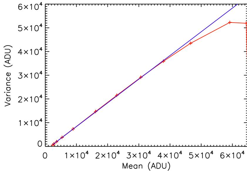
FIGURE 3.5 – Mesure du gain pour la caméra ASTEP 400, ici à 600 nm et à  $-30^\circ\text{C}$  (rouge). Les mesures sont effectuées en lecture lente (vitesse de lecture de 1 MHz). Un ajustement linéaire (bleu) permet d’obtenir la valeur du gain dans la zone de linéarité et la limite de linéarité. On remarque un léger offset ; l’offset présent dans les images est étudié section 3.4.
