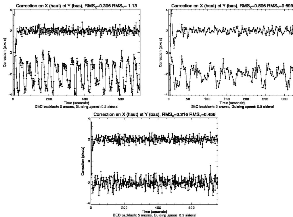
FIGURE 8.2 – Correction appliquée en X et Y, équivalente à la distance au point de fonctionnement, pour une étoile à  $45^\circ$  de déclinaison, avec différents paramètres pour la compensation du backlash en déclinaison : 0 arcsec (gauche), 3 arcsec (milieu) et 5 arcsec (droite). La vitesse de guidage est de 0.5 s. Les courbes sont centrées sur  $\pm 2$  px pour une bonne lisibilité.
