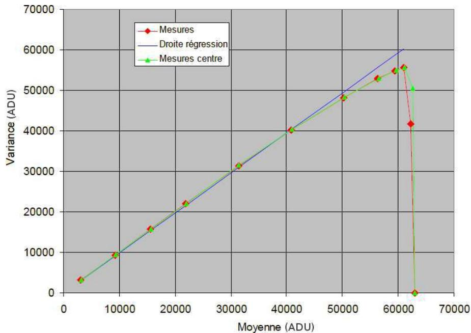
FIGURE 3.6 – Mesure du gain pour la caméra ASTEP Sud, à partir de l’image complète (rouge), et de la partie de  $1000 \times 1000$  px au centre (vert). Les résultats sont identiques. Un ajustement linéaire (bleu) permet de mesurer le gain et la limite de linéarité. Les mesures sont effectuées en lecture lente (vitesse de lecture de 1 MHz).
