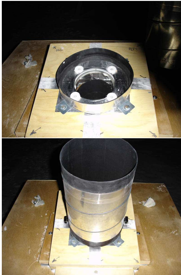
FIGURE 6.28 – Installation du pare-lumière autour du hublot de l'enceinte thermalisée d'AS-TEP Sud, au cours de l'hiver 2009. Le but est d'éliminer les reflets parasites. Le pare-lumière fait environ 40 cm de haut.
