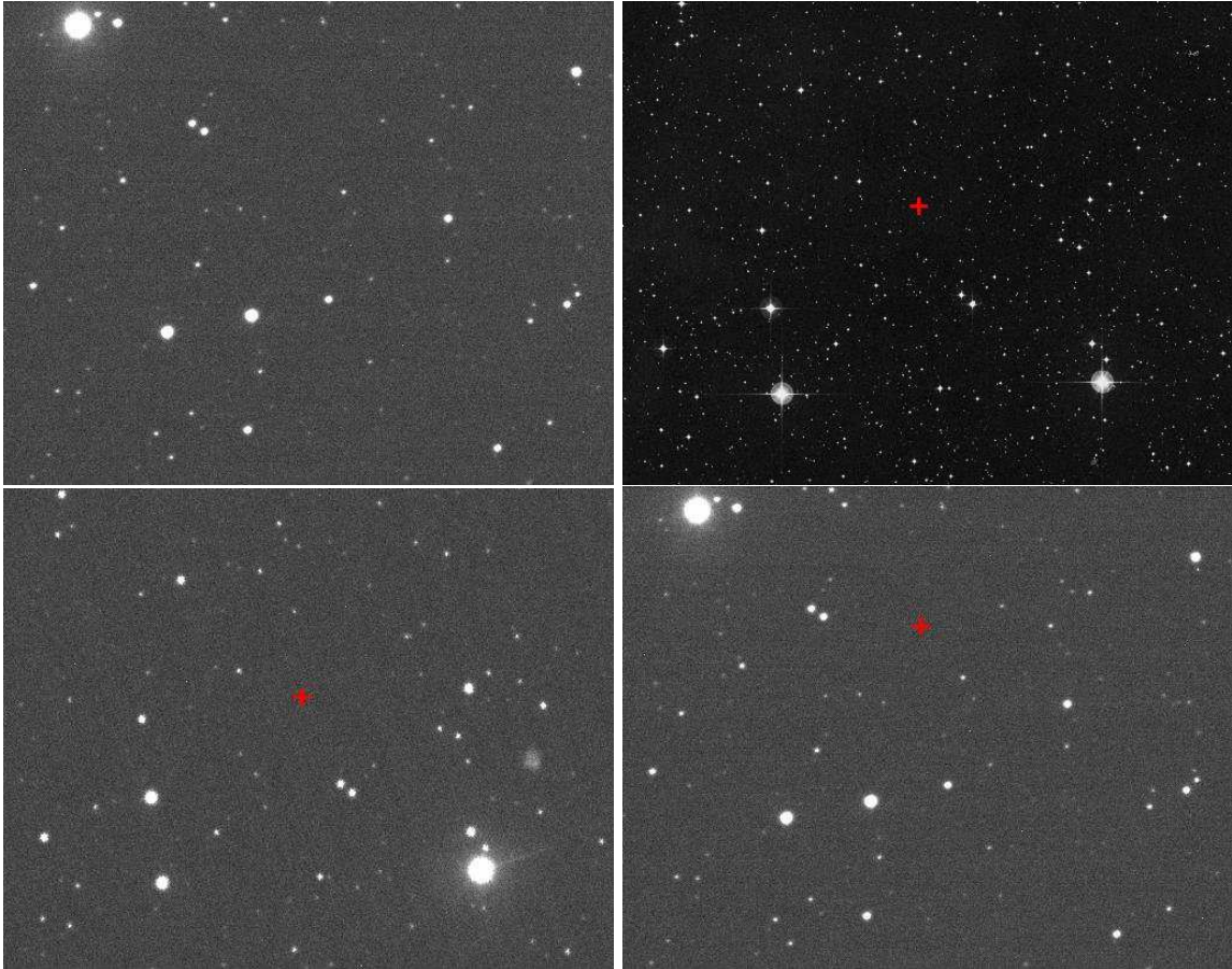
FIGURE 4.13 – Principe de la reconnaissance de champ. On cherche la transformation qui permet de faire correspondre l'image ASTEP Sud (haut gauche) à un catalogue standard (haut droite, ici représenté par une image du Digitized Sky Survey). Une fois la transformation trouvée (bas gauche), on détermine la position du pôle sur l'image initiale par l'inverse de cette transformation appliquée au pixel (2048, 2048) (bas droite). Le pôle sud est représenté par une croix rouge.
