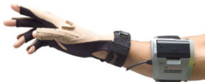
Figure 47: Le gant CyberGlove de Cyber Gloves Systems .
