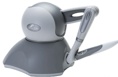
Figure 51: Un bras haptique PHANTOM de Sensable Technologies .
