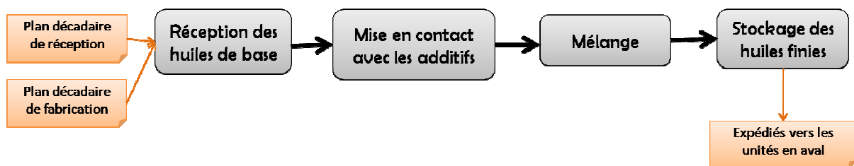
Figure 1.4. Processus de fabrication des huiles finies
