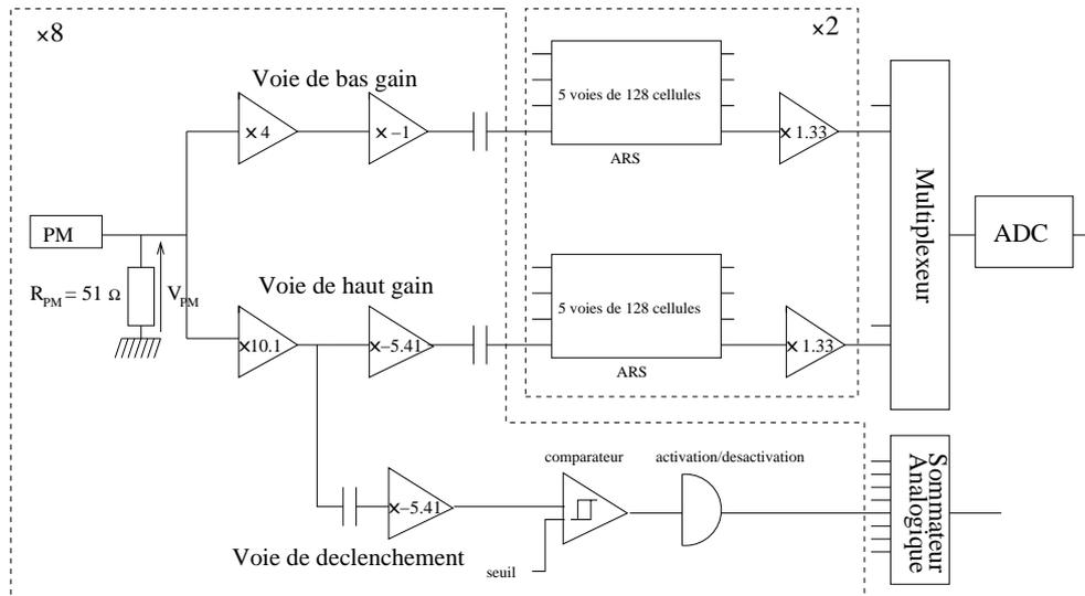
FIGURE 4.16 – *Synoptique de l’électronique d’une carte analogique de la caméra, incluant deux voies d’acquisition d’amplification différentes, et une voie de déclenchement (figure tirée de Rolland 2005).*
