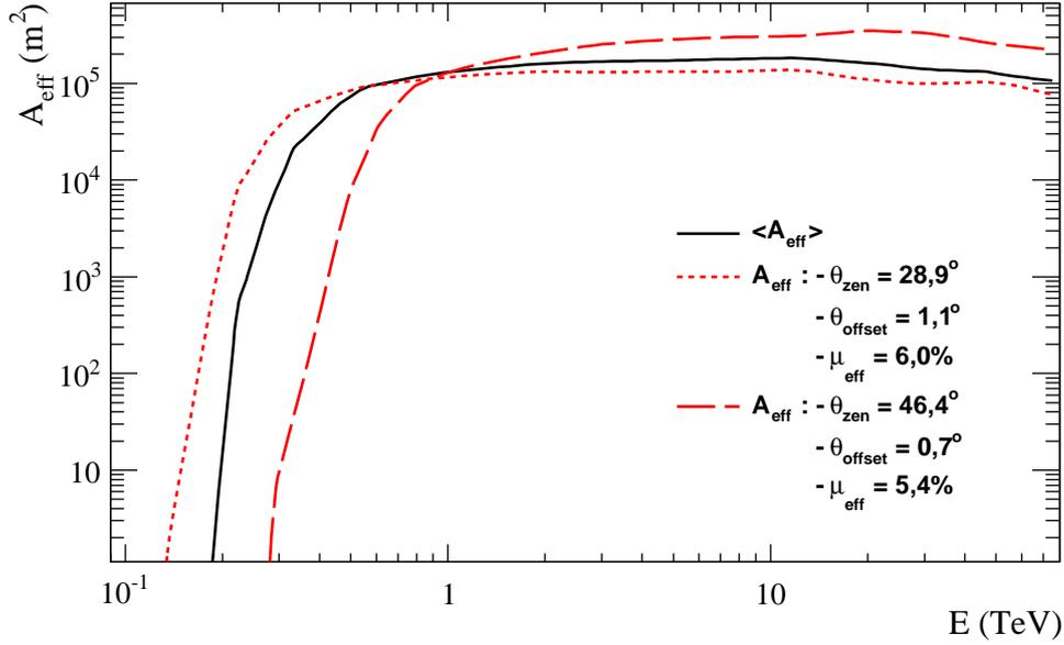
FIGURE 7.7 – Aire effective en fonction de l'énergie des rayons  $\gamma$ . Les courbes rouges tiretée et pointillée représentent les aires effectives limites de toutes les prises de données, dont les paramètres observationnels sont indiqués dans la légende (l'angle zénithal  $\theta_{\text{zen}}$ , l'angle hors-axe  $\theta_{\text{offset}}$  et l'efficacité muonique  $\mu_{\text{eff}}$ ). La courbe noire représente l'aire effective moyenne de toutes les prises de données.
