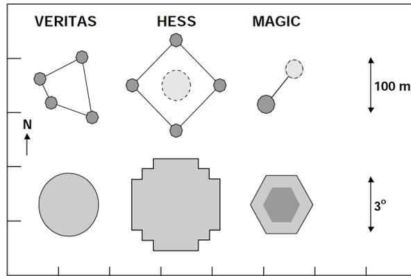
FIGURE 4.6 – *Disposition des télescopes des trois principales expériences imageant le rayonnement Cherenkov produits par les gerbes atmosphériques électromagnétiques, et tailles relatives des détecteurs photosensibles situés au plan focal des télescopes. Les pointillés indiquent les télescopes en construction. La région plus sombre du détecteur de MAGIC indique la région où la pixellisation est plus fine (figure tirée de Hinton 2009).*
