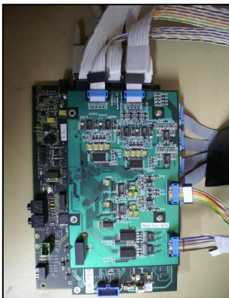
figure III.19 : cartes DSK 6713, MPAB\_NUM et MPAB\_ANA superposées
