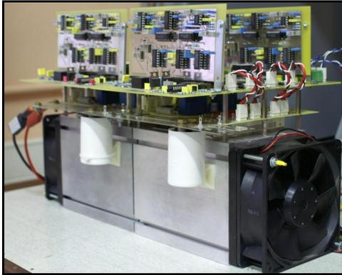
figure III.37: onduleur 4 bras à briques modulaires
