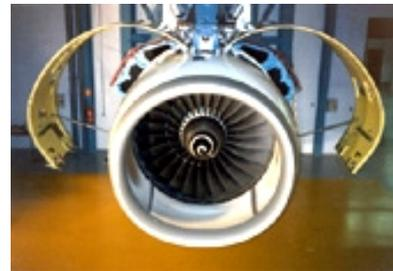
figure I.11 : ouverture des capots nacelle (©Aircelle)
