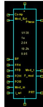
figure I.30 : symbole du modèle instantané MLI
