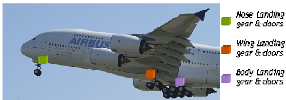
figure I.13 : placement des trains d'atterrissages sur un A380
