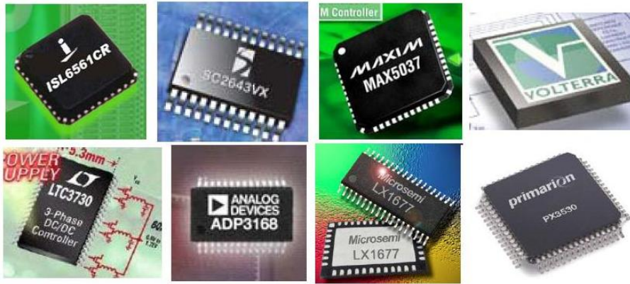
FIG. 4.4 – Exemples de circuits de commandes multiphasées
