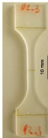
Figure 2.12 : Géométrie des éprouvettes monofilamentaires
