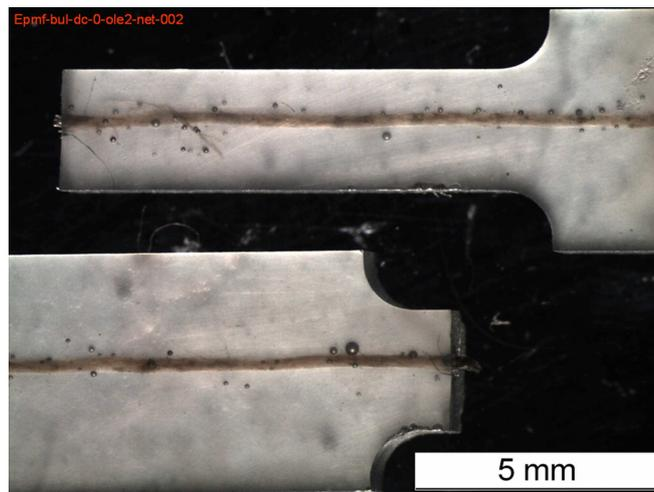
**Figure 2.13 : Marqueurs naturels des éprouvettes de fragmentation chanvre/époxy : bulles d'air, fibrilles de chanvre.**
