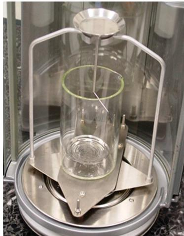
**Figure 2.2 : Dispositif expérimental pour la mesure de densité.**
