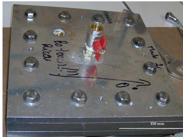
**Figure 2.40 : Elaboration de composite par moulage sous pression (réalisés par l'entreprise VALAGRO) (moule de mise en œuvre).**
