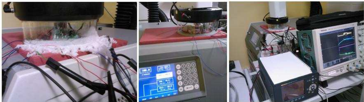
Figure IV- 45 : Test du système complet aux températures extrêmes ; de gauche à droite : (1) carte électronique et supercondensateurs dans l'enceinte climatique (2) panneau de contrôle de l'enceinte (3) appareil de mesure (multimètres NORMA et oscilloscope à mémoire)
