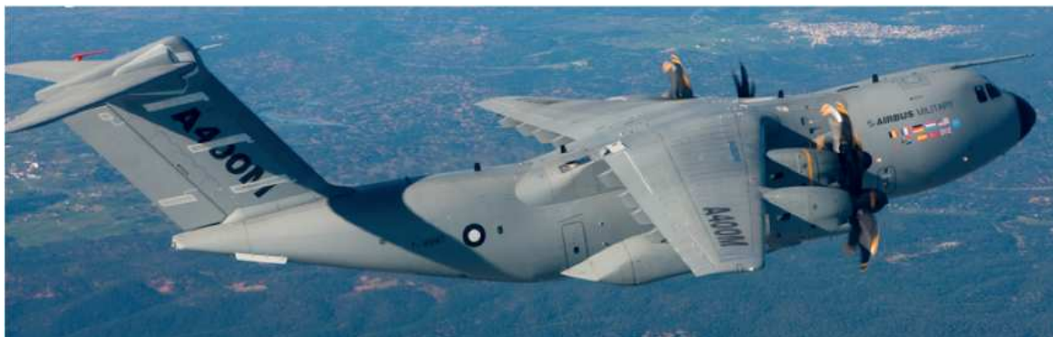
Figure I- 2 : A400M d'essais en vol. A noter l'instrumentation provisoire de la dérive, © Airbus Military 2009_A400M first flight, photo by A. Doumenjou / Exm Company.
