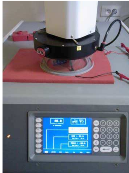
Figure III- 5 : La chambre climatique de chez Thermostream
