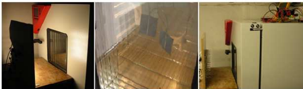
Figure II- 30 : Photos de l'environnement des mesures : à gauche hublot de porte éclairé, au milieu cellules dans la chambre, à droite vue générale avec électronique de mesure sur la chambre climatique
