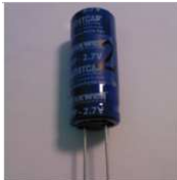
Figure III- 16 : Le supercondensateur BCAP0050 de chez Maxwell
