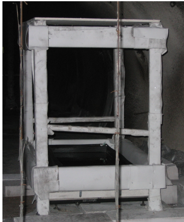
FIG. III.3 – Vue de la couverture du foyer heptane
