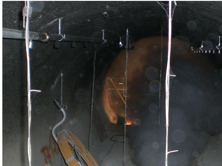
FIG. III.12 – Vue de la fixation des thermocouples
