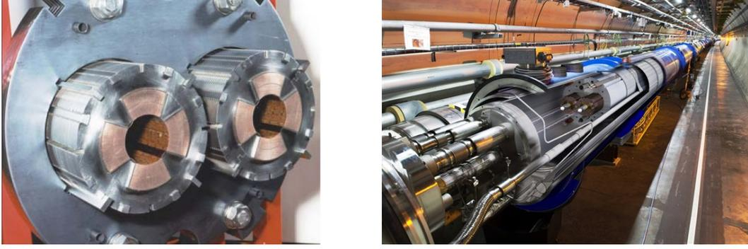
FIG. 2.2 – Coupe transversale d'un aimant dipolaire supraconducteur (gauche) et vue de dipoles installés dans le tunnel du LHC (droite).
