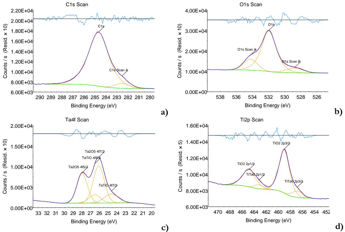
**Figure 4-22 : Résultats d'extraction XPS sur l'échantillon intégrant 100 nm de TiTaO. En (a), les pics liés au Carbone, en (b), les pics liés à l'Oxygène, en (c), les pics liés au Tantale et en (d), les pics liés au Titane.**
