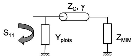
Figure 5-3 : Modèle du dispositif dans le cas d'une extraction via l'impédance ramenée.
