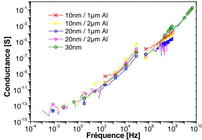
**Figure 5-12 : Extraction de la conductance pour les dispositifs MIM intégrant différentes épaisseurs d'HfO<sub>2</sub>.**
