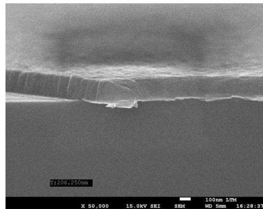
Figure 2-29 : Observation MEB en vue tiltée du flanc de gravure du premier niveau métallique. Accélération 15 kV. L'image montre le profil de gravure, une épaisseur de 206 nm d'Al est bien déposée.
