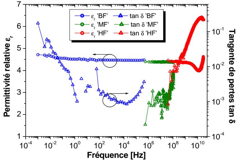
**Figure 4-5 :** Caractéristiques très large bande de la permittivité relative  $\epsilon_r$  et de la tangente de pertes  $\tan \delta$  d'un film de 40 nm de  $\text{Si}_x\text{N}_y$  en structure MIM.
