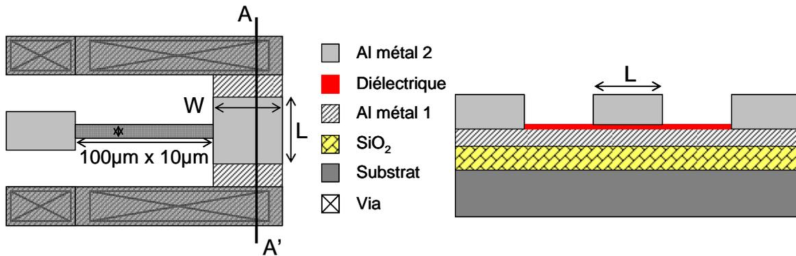
Figure 2-13 : Vue de dessus (gauche) et en coupe selon le plan (AA') (droite) des capacités un port réalisées.
