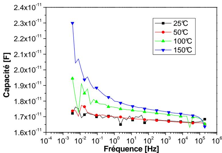
Figure 5-9 : Capacité en fonction de la fréquence à différentes températures pour une épaisseur de 30 nm d' $\text{HfO}_2$
