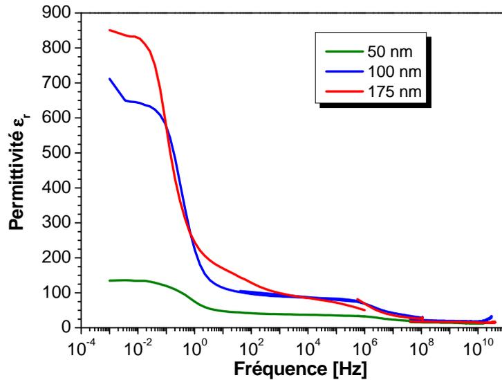
**Figure 4-27 : Dépendance fréquentielle et avec l'épaisseur de la permittivité relative des échantillons intégrant du TiTaO.**
