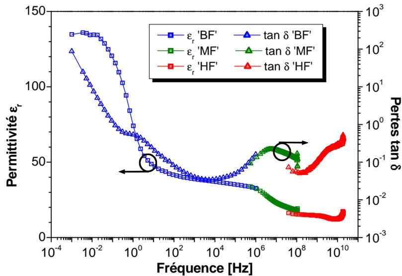
Figure 4-23 : Caractéristiques très large bande de la permittivité relative (carrés) et de la tangente de pertes (triangles) de l'échantillon intégrant 50 nm de TiTaO.
