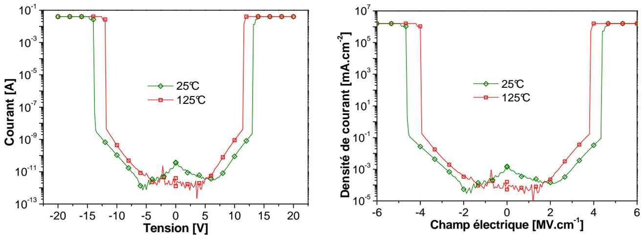
**Figure 5-6 :** Comparaison entre les mesures à 25 °C et 125 °C pour l'échantillon intégrant 30 nm d' $\text{HfO}_2$ . À gauche, les courants de fuites  $I$  en fonction de la tension  $V$  appliquée sont présentés et à droite la densité de courant  $J$  en fonction du champ électrique  $E$  est calculée.
