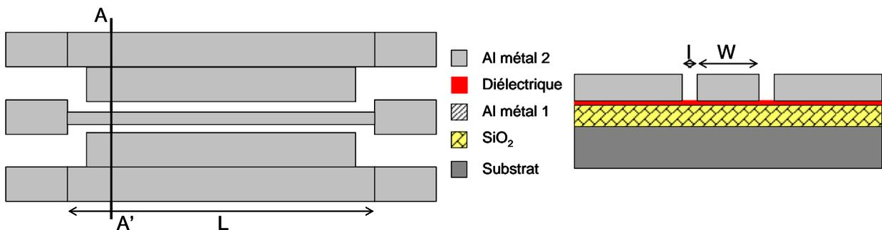
Figure 2-5 : Lignes coplanaires de largeur  $W$ , de longueur  $L$  et d'espacement interligne  $I$  permettant la caractérisation du matériau diélectrique en configuration « massive ». Vue de dessus à gauche et en coupe selon le plan (AA') à droite.
