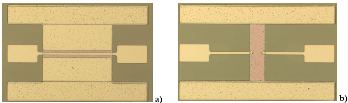
**Figure 4-21 : Résultats de fabrication des échantillons intégrant du TiTaO. En (a), une ligne de transmission de 10 µm de large et de 200 µm de long est présentée. En (b), un motif « SHORT » avec les deux vias réalisés à l'IBE est montré.**
