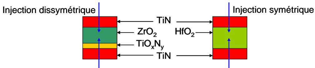
Figure 5-15 : Différence d'empilement et de trajet d'injection de courant entre les échantillons de  $\text{ZrO}_2$  et d' $\text{HfO}_2$ .
