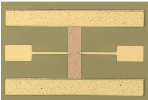
Figure 2-32 : Motifs de de-embedding SHORT final sur un échantillon intégrant 175 nm de TiTaO. Les vias de 10  $\mu\text{m}$  x 10  $\mu\text{m}$  au niveau du court-circuit sont parfaitement sortis lors de la gravure IBE et l'alignement des trois masques est bon.
