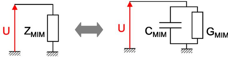
**Figure 3-4 :** Schéma électrique équivalent du dispositif mesuré. L'impédance  $Z_{MIM}$  mesurée est modélisée par une capacité  $C_{MIM}$  et une conductance  $G_{MIM}$  en parallèle.
