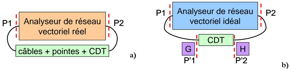
**Figure 3-13 : Profils réel (a) et idéal (b) du VNA**
