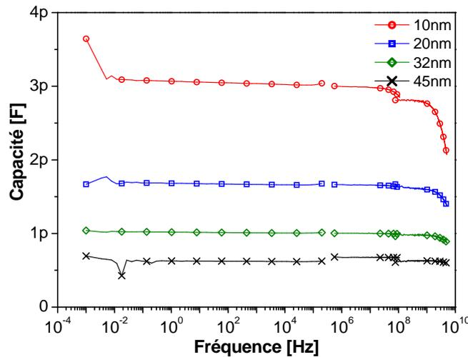
Figure 5-21 : Extraction de la capacité pour la MIM intégrant du  $\text{ZrO}_2$  en couplant des mesures sur des capacités plots en basses fréquences et des capacités parallèles à un port de  $100 \mu\text{m}^2$  en moyennes et hautes fréquences.
