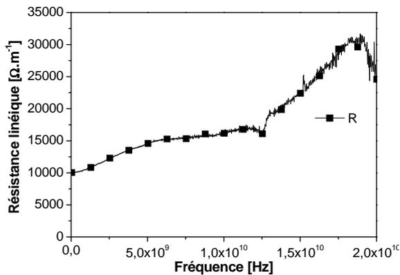
Figure 4-13 : Extraction de la résistance linéique du DST.
