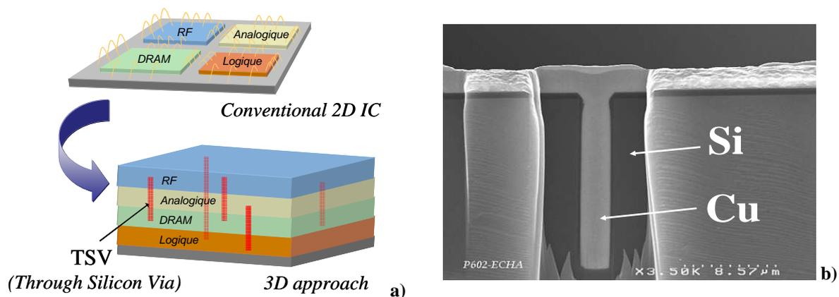
**Figure 1-5 : Intérêt de l'intégration 3D par rapport à une approche « traditionnelle » 2D (a) et vue en coupe au MEB d'un TSV de 15  $\mu\text{m}$  de profondeur et de 3  $\mu\text{m}$  de large (b), cliché STMicroelectronics.**
