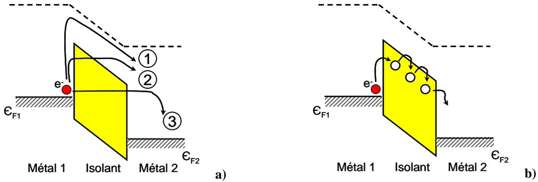
Figure 1-13 : Diagrammes de bandes d'énergie pour une capacité MIM polarisée dans le cas de conduction de type (a,1) Schottky, (a,2) Fowler-Nordheim, (a,3) tunnel direct ou (b) Poole-Frenkel.
