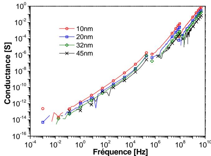
Figure 5-22 : Extraction de la conductance pour la MIM intégrant du  $\text{ZrO}_2$  en couplant des mesures sur des capacités plots en basses fréquences et des capacités parallèles à un port de  $100 \mu\text{m}^2$  en moyennes et hautes fréquences.
