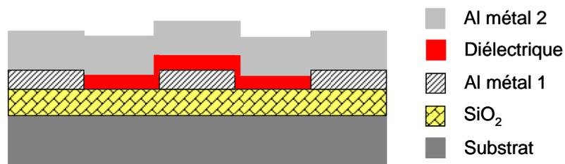
**Figure 2-20 : Dépôt d'aluminium pour le niveau métal 2 (électrode supérieure). Ce dépôt est directif, les motifs (creux et bosses des niveaux inférieurs) sont reproduits au niveau du dépôt métallique**
