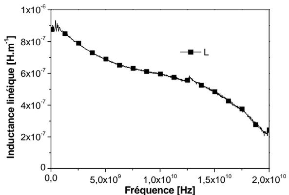
Figure 4-14 : Extraction de l'inductance linéique du DST.
