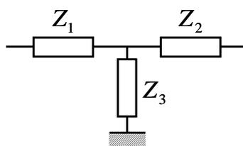
Figure 3-22 : Schémas en T du DST.
