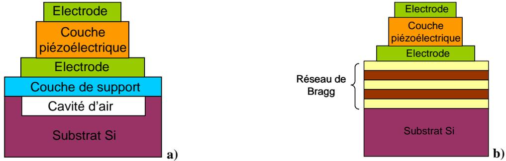
Figure 1-10 : Résonateur FBAR (a) et SMR (b).
