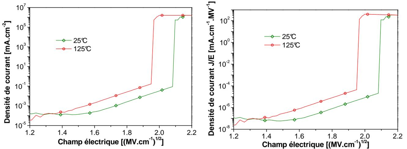
Figure 5-7 : à gauche, densité de courant  $J$  en fonction de la racine carrée du champ électrique  $E$ ,  $J(\sqrt{E})$  à 25 °C et 125 °C. A droite, densité de courant  $J$  divisée par le champ électrique  $E$  en fonction de la racine carrée du champ électrique,  $J/E(\sqrt{E})$ , à 25°C et 125°C.
