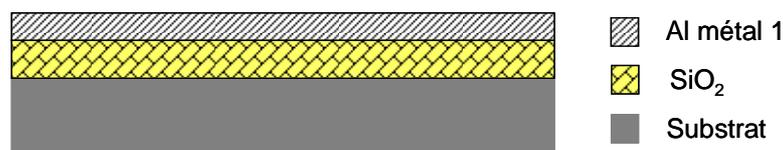
**Figure 2-19 : Dépôt d'aluminium pour le niveau métal 1 (électrode inférieure).**
