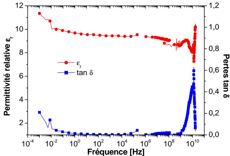
**Figure 4-18 :** Caractéristiques très large bande de la permittivité relative et de la tangente de pertes de la couche de 100 nm d'AlN. Des valeurs moyennes aux alentours de 9 pour la permittivité relative et de  $10^{-2}$  pour les pertes sont obtenues. La résonance acoustique à 12 GHz est bien mise en évidence.
