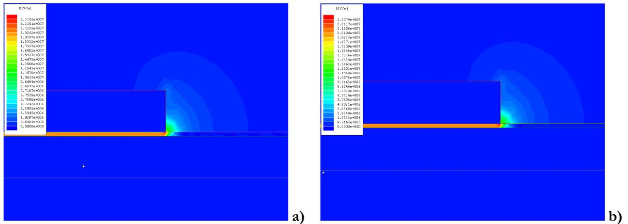
Figure 2-8 : Simulations avec Maxwell 2D d'Ansoft du champ électrique E dans une structure de type ligne micro ruban à 10 Hz en (a) et à 10 GHz en (b). Le maximum de champ est concentré entre les deux électrodes en traversant le diélectrique dans le sens transversal.
