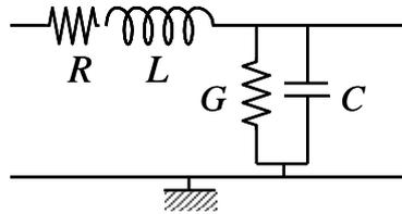
**Figure 5-23 : Schéma électrique équivalent idéal de la capacité parallèle à un port mesurée en hautes fréquences.**
