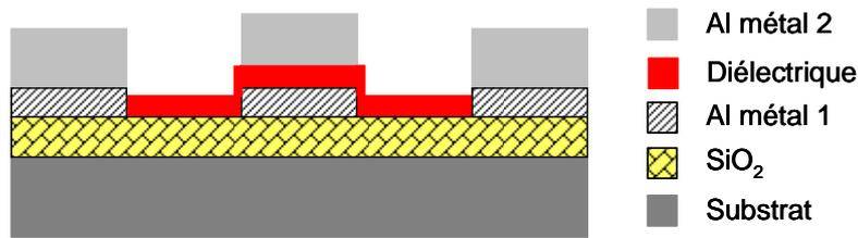
Figure 2-25 : Niveau métallique supérieur. L'échantillon est alors terminé et il est prêt à être caractérisé.
