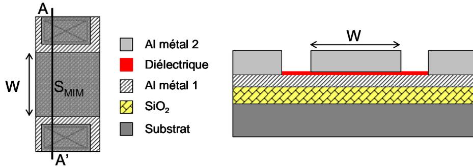
Figure 2-4 : Capacité un port pour la caractérisation en moyennes fréquences (entre 100 kHz et 110 MHz). Les pointes RF se connectent sur les trois plots, le central correspondant au signal et les deux extérieurs à la masse. Vue de dessus à gauche et en coupe selon le plan (AA') à droite.
