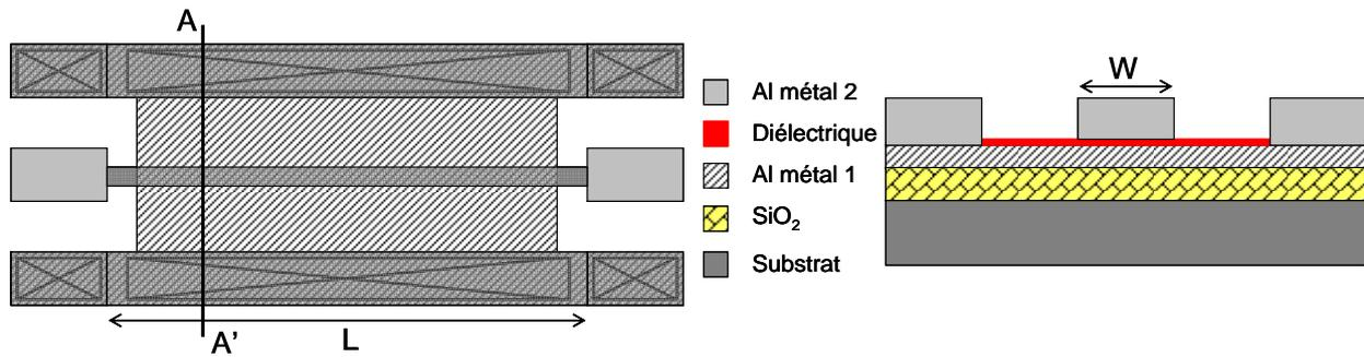
Figure 2-10 : Lignes micro ruban standards de largeur  $W$  et de longueur  $L$  permettant la caractérisation "in-situ" du matériau diélectrique intégré. Vue de dessus à gauche et en coupe selon le plan (AA') à droite.
