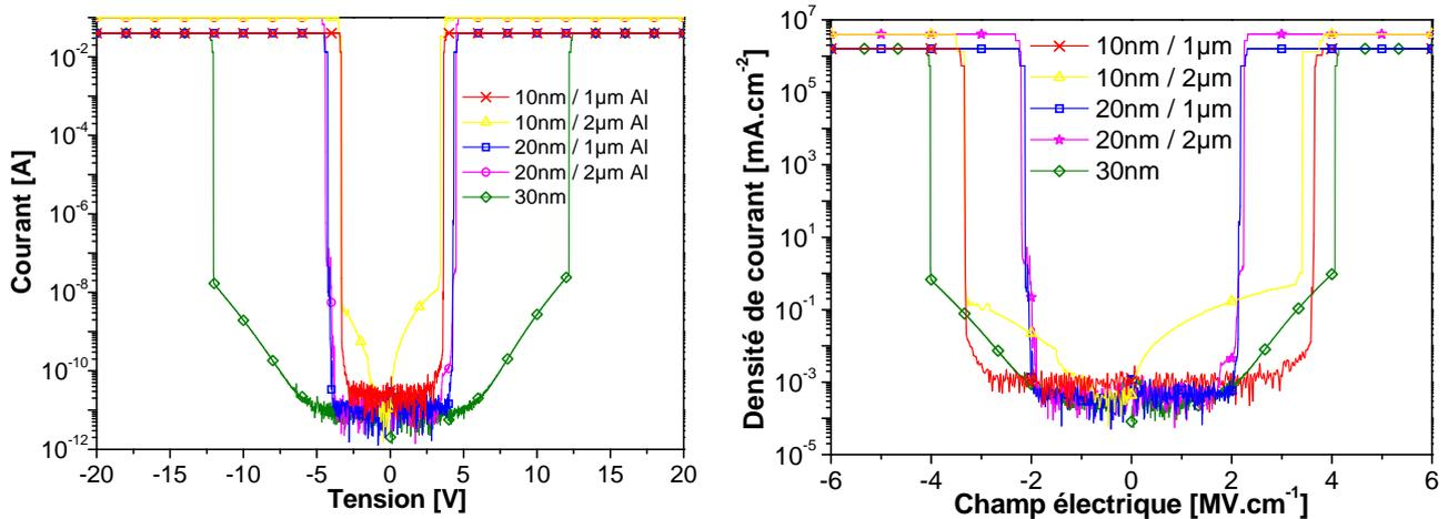
Figure 5-5 : Mesures à  $T = 25\text{ }^\circ\text{C}$ , courbes du courant de fuite  $I$  en fonction de la tension appliquée  $V$ ,  $I(V)$ , à gauche et calculs de la densité de courant  $J$  en fonction du champ électrique appliqué  $E$ ,  $J(E)$ , à droite.
