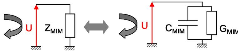
**Figure 3-9 : Schéma électrique équivalent du dispositif un port mesuré en moyennes fréquences.**
