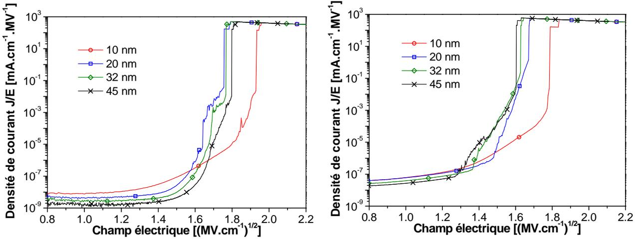
Figure 5-17 : À gauche, densité de courant  $J$  divisée par le champ électrique  $E$  en fonction de la racine carrée du champ électrique  $E$ ,  $J(\sqrt{E})$ , à  $25^\circ\text{C}$ . À droite, densité de courant  $J$  divisée par le champ électrique  $E$  en fonction de la racine carrée du champ électrique  $E$ ,  $J/E(\sqrt{E})$ , à  $125^\circ\text{C}$ .
