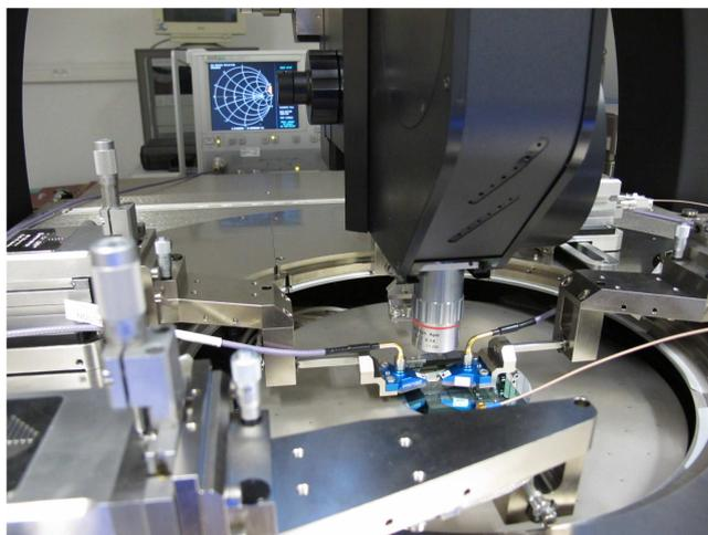
**Figure 0-4 :** Station sous pointes et analyseur de réseau vectoriel pendant une mesure à hautes fréquences (40 MHz à 40 GHz) sur un échantillon intégrant du TiTaO en structure MIM.
