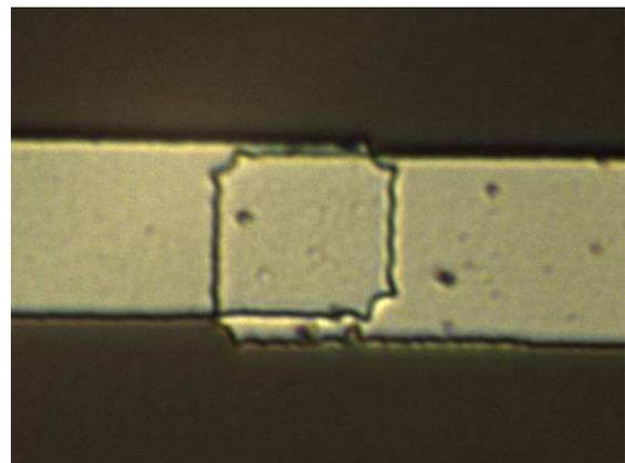
Figure 2-33 : Via de 10  $\mu\text{m}$  x 10  $\mu\text{m}$  d'un motif SHORT sur un échantillon intégrant 10 nm de  $\text{Si}_3\text{N}_4$ . L'alignement est toujours excellent et la gravure IBE a permis de bien réaliser le via.
