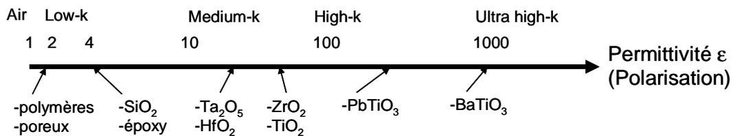
Figure 1-11 : Axe définissant l'échelle de permittivité utilisé, des « low-k » aux « Ultra high-k ».
