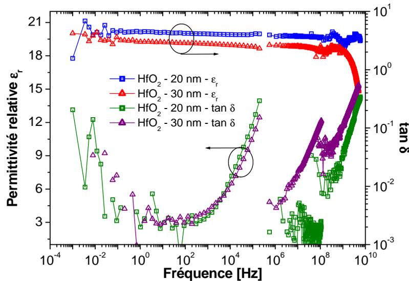
**Figure 5-10 : Extraction très large bande (de  $10^{-3}$  Hz à 5 GHz) de la permittivité relative  $\epsilon_r$  et de la tangente de pertes  $\tan \delta$  pour deux épaisseurs d' $\text{HfO}_2$ .**
