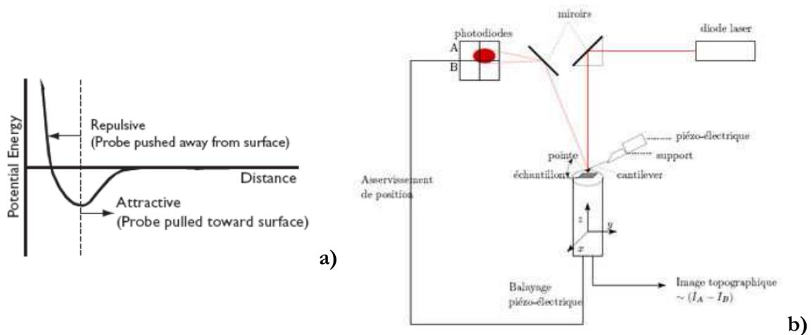
**Figure I-1 : Diagramme du potentiel d'énergie entre la pointe et la surface en (a) et Principe de fonctionnement de l'AFM en (b).**
