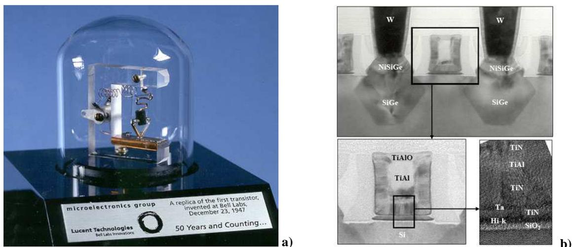
**Figure 1-1 : Réplique du premier transistor réalisé chez Bell Labs Innovations en 1947 (a) et une coupe TEM du dernier transistor 45 nm fabriqué par Intel® en 2008 (b) intégrant un diélectrique de grille  $\text{HfO}_2$  et une double grille métallique.**
