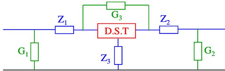
**Figure 3-14 :** Circuit électrique équivalent du dispositif mesuré complet proposé par Van Damne.  $G_1$  et  $G_2$  correspondent à l'effet des plots.  $G_3$  est le couplage entre les deux ports de mesure et  $Z_1$ ,  $Z_2$  et  $Z_3$  sont les effets liés aux accès.
