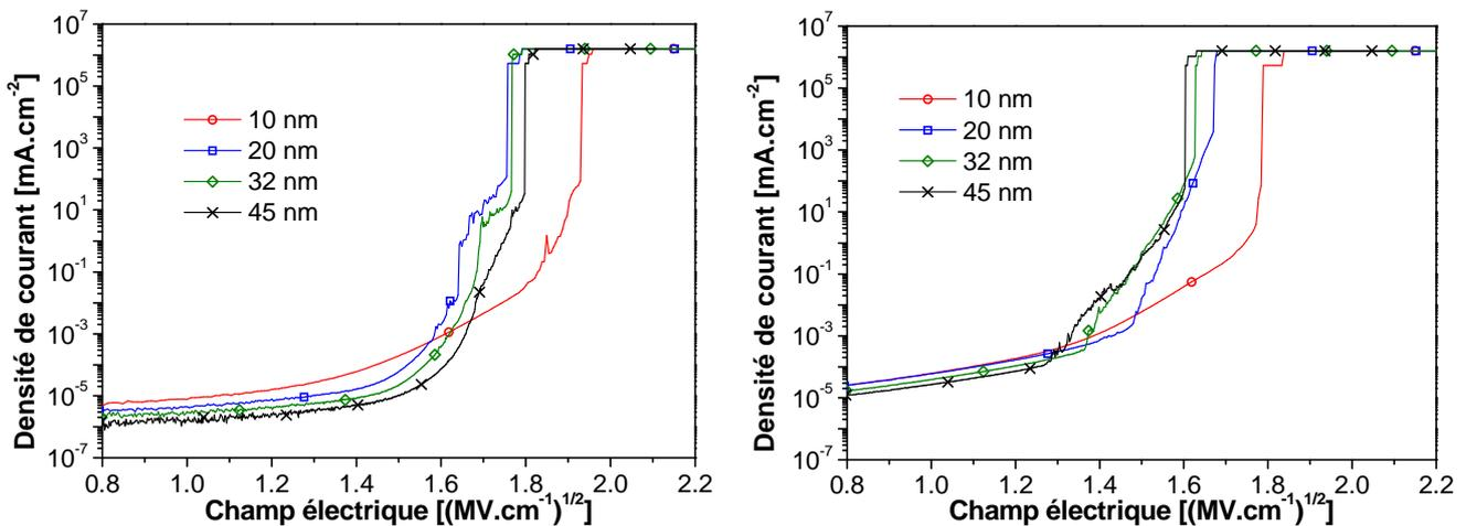
Figure 5-16 : À gauche, densité de courant  $J$  en fonction de la racine carrée du champ électrique  $E$ ,  $J(\sqrt{E})$ , à  $25^\circ\text{C}$ . À droite, densité de courant  $J$  en fonction de la racine carrée du champ électrique  $E$ ,  $J/E(\sqrt{E})$ , à  $125^\circ\text{C}$ .
