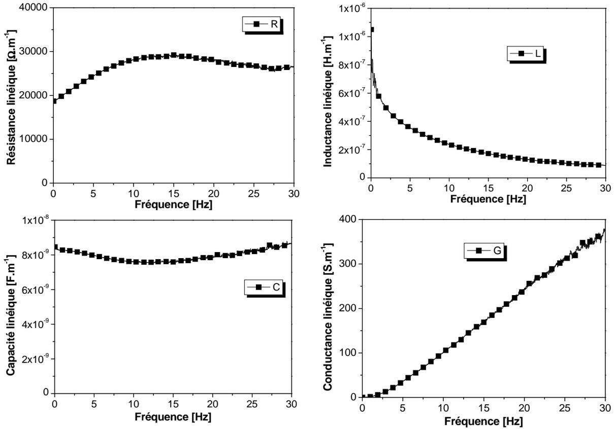
Figure 4-4 : Paramètres RLCG extraits à partir de deux lignes micro-ruban de largeur de 10  $\mu\text{m}$  et de longueurs 200  $\mu\text{m}$  et 1000  $\mu\text{m}$  intégrant 40 nm de  $\text{Si}_x\text{N}_y$ .
