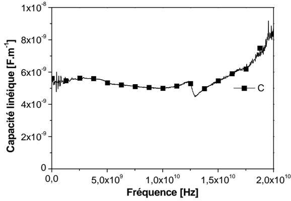
Figure 4-15 : Extraction de la capacité linéique du DST.
