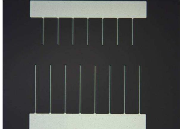
Figure 2-31 : Réseau de lignes de 2,5  $\mu\text{m}$  de largeur au niveau métallique 1.
