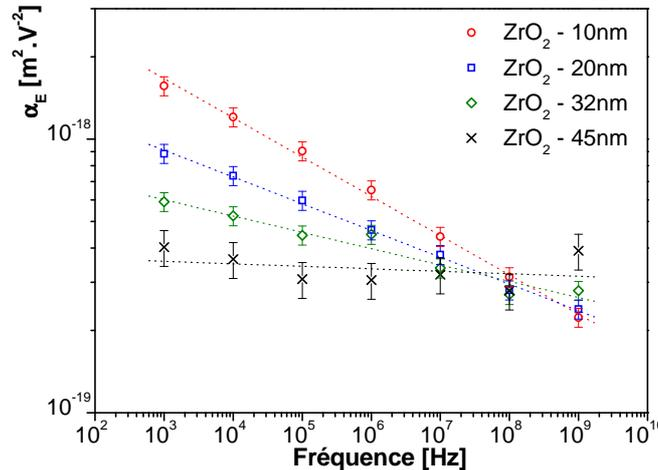
**Figure 5-32 : Variation du paramètre  $\alpha_E$  avec la fréquence. Les lignes en pointillés représentent un fit exponentiel sur les points expérimentaux.**
