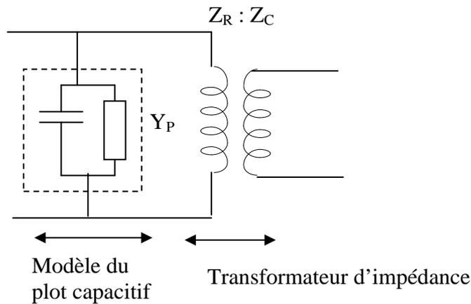
**Figure 3-18 : Schéma électrique de la transition ligne-plot.**
