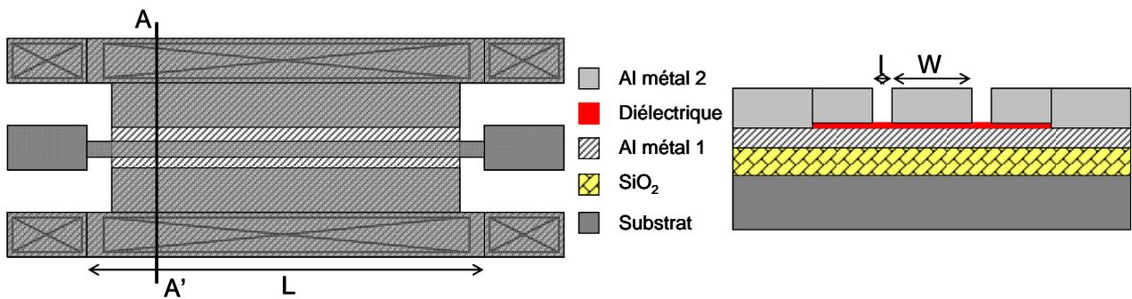
Figure 2-11 : Lignes micro-ruban « blindées » de largeur  $W$  et de longueur  $L$  permettant la caractérisation "in-situ" du matériau diélectrique intégré. Vue de dessus à gauche et en coupe selon le plan (AA') à droite.
