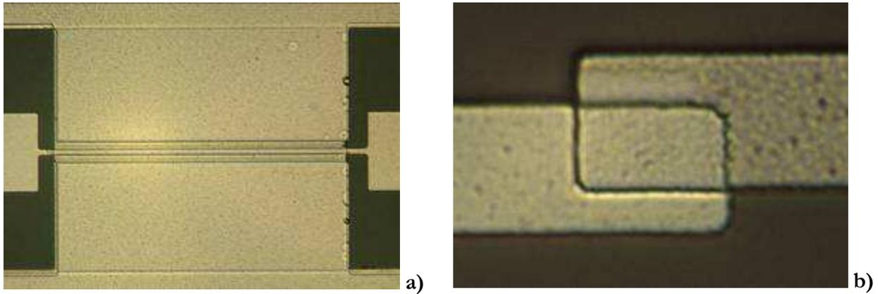
**Figure 4-1 : Résultats de fabrication pour des échantillons intégrant 40 nm de  $\text{Si}_x\text{N}_y$ . En (a), un motif de ligne micro-ruban « blindée » de 200  $\mu\text{m}$  de long et de 5  $\mu\text{m}$  de large est présent. En (b), un court-circuit de 10 x 10  $\mu\text{m}^2$  avec un léger désalignement de 2  $\mu\text{m}$  est montré.**
