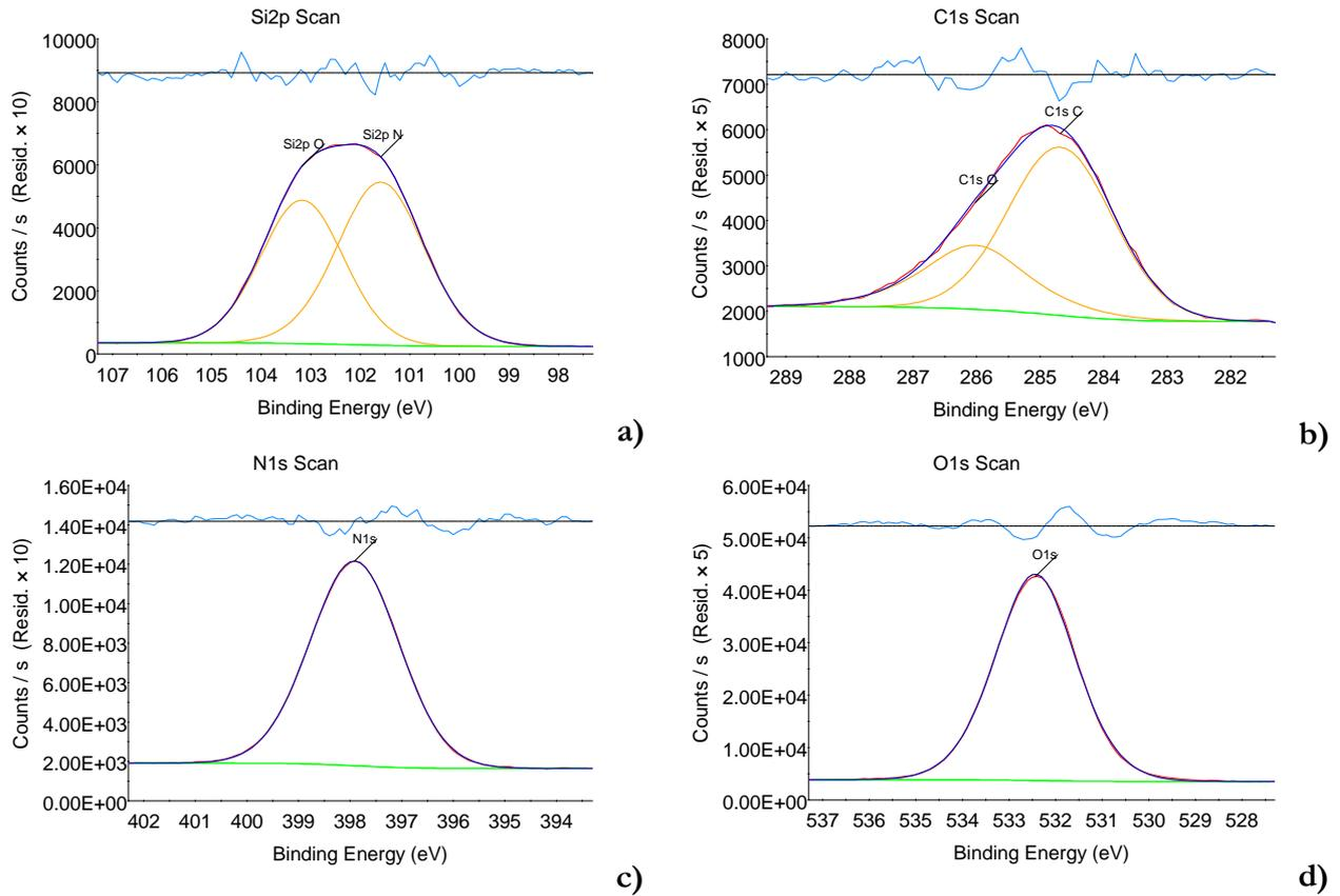
**Figure 4-2 :** Résultats XPS pour l'échantillon intégrant 40 nm de  $\text{Si}_x\text{N}_y$ . En (a), le double pic correspond au Silicium et aux liaisons 2p Si-C et Si-N. En (b), le double pic du Carbone correspond aux liaisons 1s C-C et C-Si. En (c), le pic correspond à l'Azote et en (d), le pic correspond à l'Oxygène.
