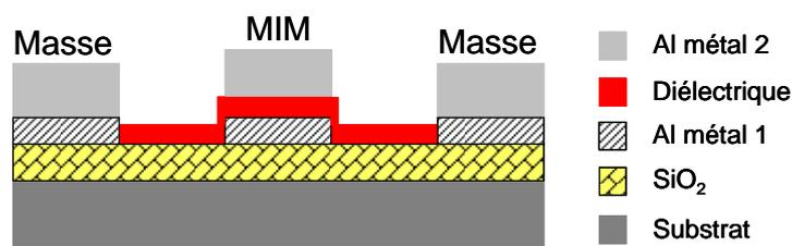
Figure 2-17 : Empilement complet réalisé à la PTA
