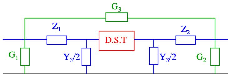
**Figure 3-15 :** Modèle électrique simplifié obtenu à partir du modèle de Van Damne.
