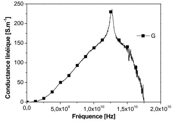
Figure 4-16 : Extraction de la conductance linéique du DST.
