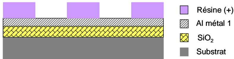
Figure 2-22 : Dépôt de la résine positive après insolation et développement afin de former le niveau métallique inférieur (masque 1). Les zones insolées deviennent plus solubles au développement que les zones non exposées ; une image positive du masque 1 est formée.
