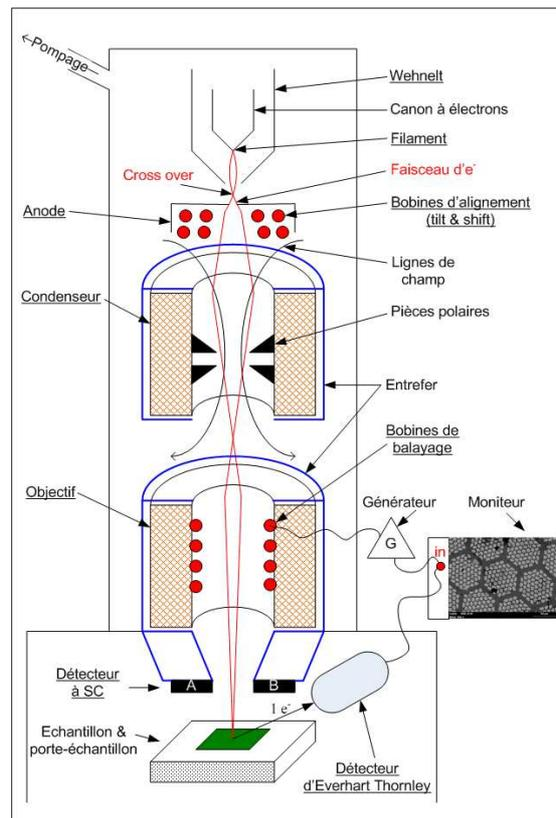
**Figure I-2 : Schéma d'un MEB.**
