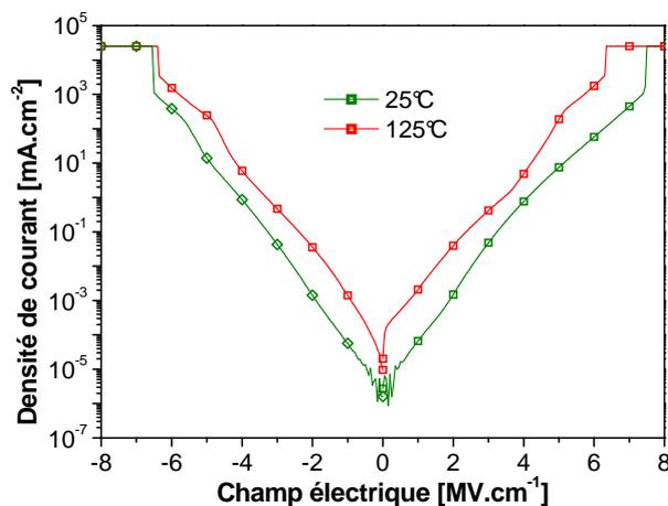
Figure 4-11 : Densité de courant  $J$  en fonction du champ électrique appliqué  $E$  et de la température pour une épaisseur d'AlN de 100 nm.
