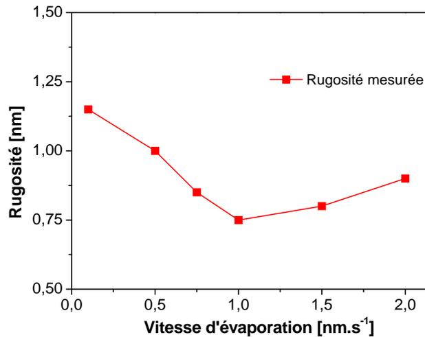
**Figure 2-21 : Evolution de la rugosité mesurée en fonction de la vitesse d'évaporation de l'aluminium en  $\text{nm.s}^{-1}$ . L'optimum est obtenu pour une vitesse d'évaporation de  $1 \text{ nm.s}^{-1}$ .**
