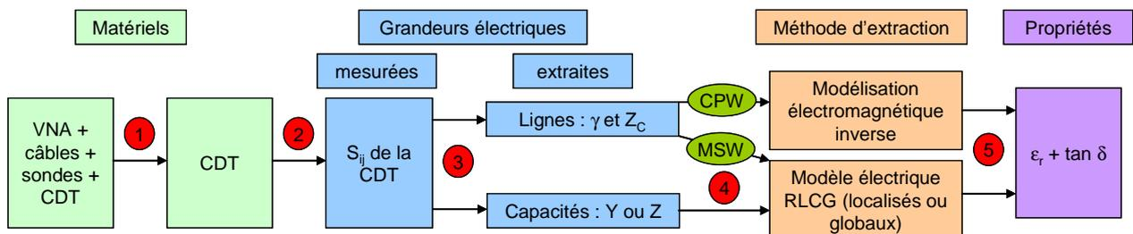
Figure 3-10 : Principe général de la caractérisation hyperfréquence.
