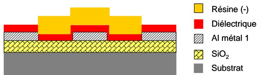
**Figure 2-35 : Dépôt de la résine négative après étalement, insolation et développement. Les zones de résine insolées étant moins solubles dans le développeur, une image négative du masque 2 est formée sur l'échantillon.**
