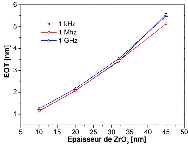
Figure 5-25 : Epaisseur d'oxyde équivalente en fonction de l'épaisseur de ZrO<sub>2</sub>
