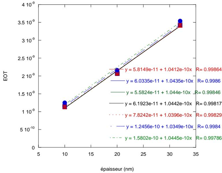
Figure 5-26 : EOT en fonction de l'épaisseur du  $\text{ZrO}_2$ .
