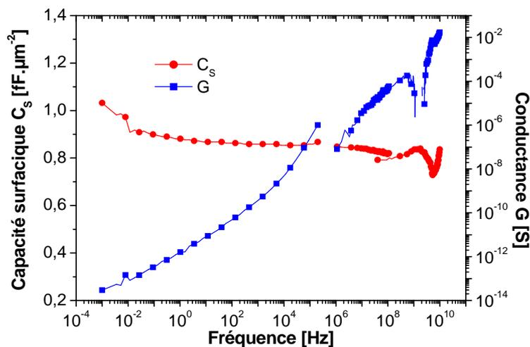
Figure 4-20 : Caractéristique très large bande d'une capacité MIM à base d'AlN. La densité surfacique  $C_s$  et la conductance G de la structure sont extraites de  $10^{-3}$  Hz à 10 GHz. Une capacité surfacique de  $0,9 \text{ fF} \cdot \mu\text{m}^{-2}$  est obtenue jusqu'à 10 GHz.
