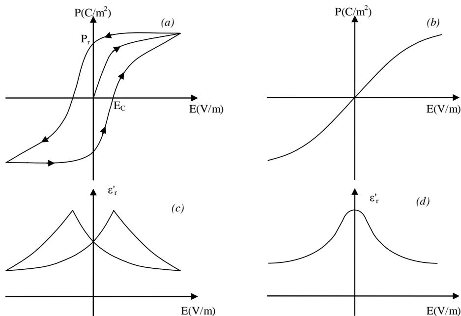
**Figure 1-15 : La polarisation  $P$  en fonction du champ électrique  $E$  d'un matériau ferroélectrique (a) et d'un paraélectrique (b) ; la permittivité réelle en fonction du champ  $E$  d'un matériau ferroélectrique (c) et d'un paraélectrique (d).**
