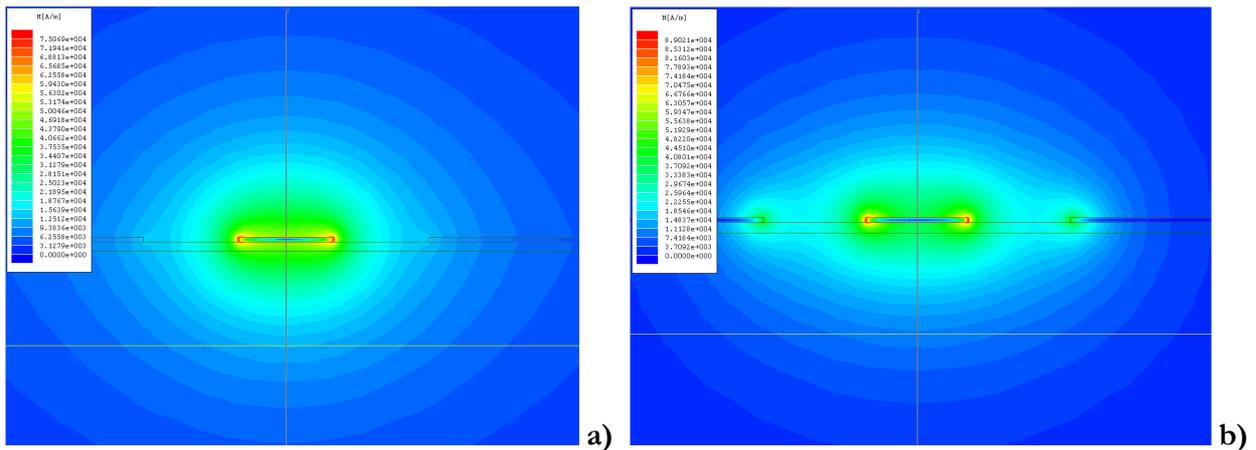
**Figure 2-7 :** Simulations avec Maxwell 2D d'Ansoft du champ magnétique H dans une structure de type ligne coplanaire en basses fréquences (10 Hz) en (a) et en hautes fréquences (10 GHz) en (b). En (b), le maximum de champ est concentré entre la ligne de signal centrale et le bord des lignes de masse extérieures en traversant le diélectrique.
