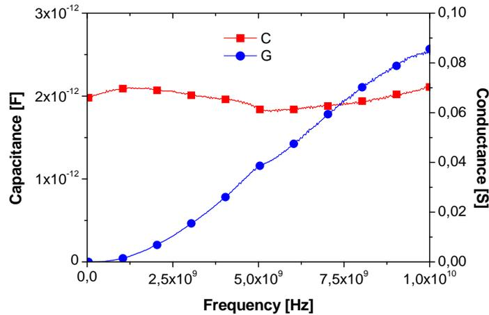
Figure 4-19 : Extraction de la capacité C et de la conductance G en hautes fréquences (de 40 MHz à 10 GHz) sur une capacité parallèle de 2500  $\mu\text{m}^2$  de surface.
