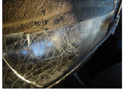
FIG. (II) 1.2: Photographie d'un OM de la ligne 6 [img26]. L'effet de « verre brisé » correspond aux « biosalissures », et de la sédimentation est visible sur le ruban adhésif. Cet OM est un cas extrême : les biosalissures observées sur les autres OMs sont moins importantes.
