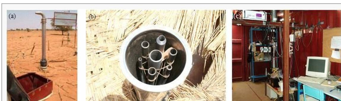
**Figure 2.10 : Système de prélèvement utilisé à la station de Banizoumbou au Niger pour les campagnes de mesures intensives d'AMMA.** (a) Préleveur Isocinétique de Particules (PIP) (b) vue intérieure du PIP avec une division en 7 voies d'échantillonnage (c) instruments connectés au PIP.
