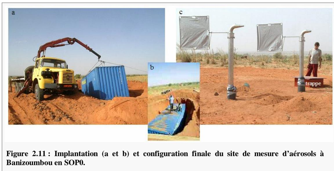
En SOP1-2, un des deux PIP a été surélevé à 5m du sol afin de mener, par méthode des gradients, l'étude des flux d'émission de particules terrigènes lors des évènements convectifs. Les filtres de prélèvements pour l'analyse de la chimie, de la minéralogie et du fer des aérosols produits localement sont placés sur le PIP surélevé afin de collecter des aérosols qui ont le plus de chance d'être transportés.
