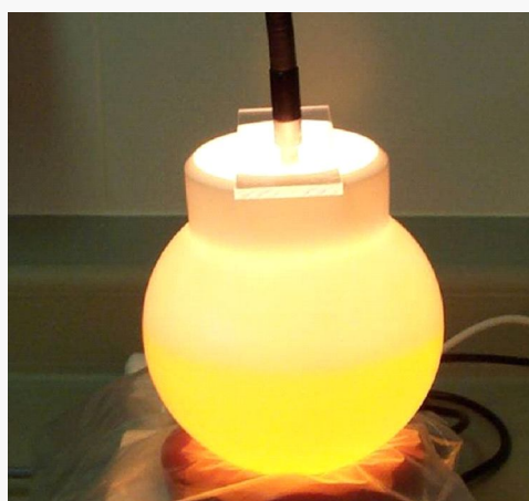
Figure 3.13 : Réacteur de dissolution utilisé pour les expériences réalisées sous irradiation
