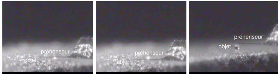
FIG. 1.16 – Saisie statique d'une microsphère [Haliyo 2002].
