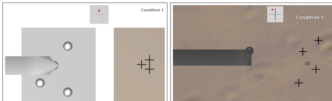
FIG. 2.6 – Exemples de rendus graphiques utilisés dans les études pilotes sur l'évaluation des assistances haptiques. Le point rouge dans le repère situé en haut de l'image indique la valeur de la force appliquée sur la poutre.
