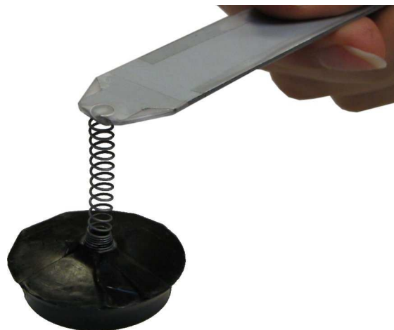
FIG. 3.3 – Dispositif aimant-ressort dont le comportement est hystérétique.
