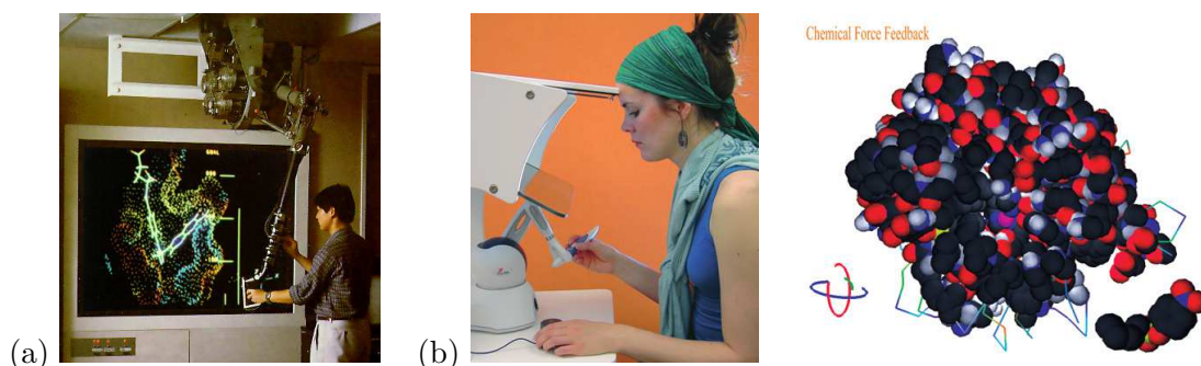
FIG. 1.12 – Simulateurs de docking moléculaire avec retour d'effort. (a) Premier prototype, issu du projet GROPE III [Brooks, Jr. et coll. 1990]. (b) Plate-forme pédagogique étudiée dans [Persson et coll. 2007] ; à droite, le rendu graphique montrant la protéine, le ligand et une représentation du couple d'interaction.
