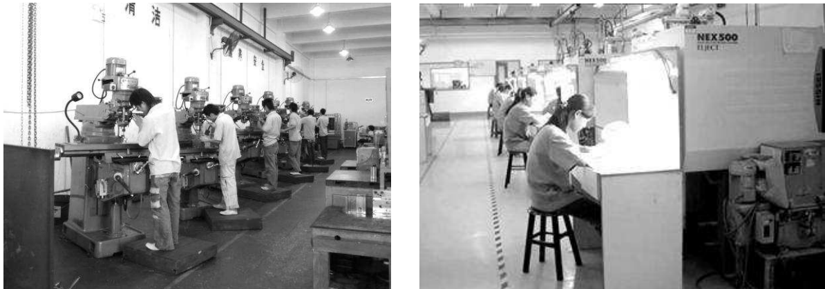
Figure 0.1 Plasturgie en Chine 1 : fabrication d’empreintes par usinage conventionnel ; opératrices sur presse à injecter.
