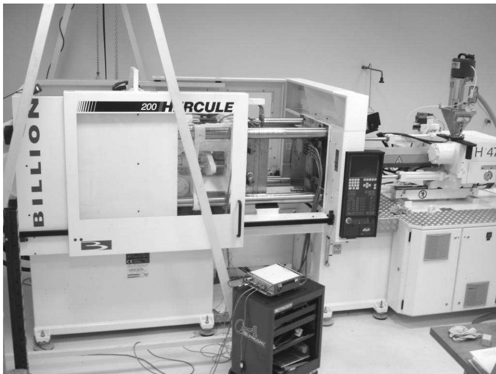
Figure 4.1 Presse à injecter Billion Hercule H470 200T du Site de Plasturgie de l'INSA de Lyon
