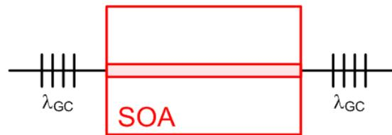
FIG. 3.45 – Principe du blocage du gain.
