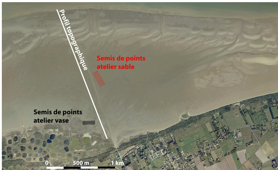
Figure 2.5 : Localisation du profil et des semis de points pour l'établissement des MNT des zones ateliers vase et sable. (Source orthophotoplan 2005 PPige)
