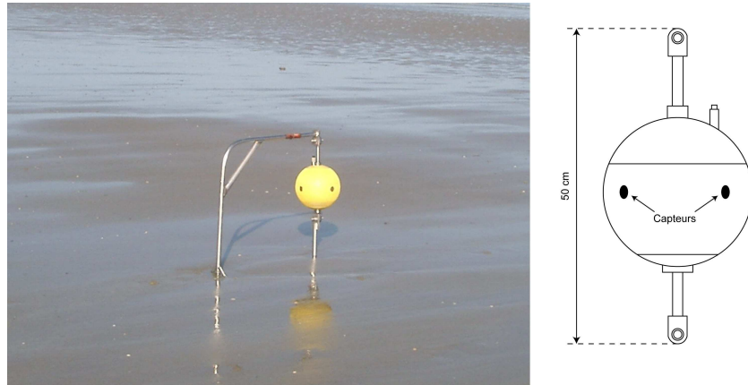
Figure 2.11 : S4 déployé en bas de plage et schéma de l'appareil
