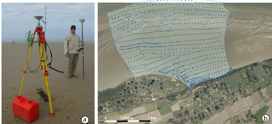
Figure 2.6 : a) DGPS System 1200 avec station fixe positionnée sur un relais de point géodésique et récepteur mobile, b) exemple du semis de points réalisé en septembre 2007 pour l'établissement du MNT de l'ensemble du site d'étude. (Sources Cliché A.A. et orthophotoplan 2005 PPige)
