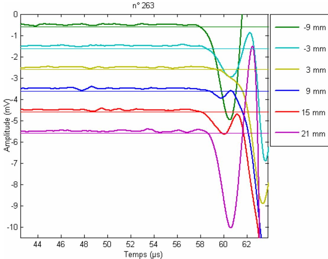
**Figure 17 : Premier signal observé pour l'ensemble des positions le long de l'axe du col pour l'échantillon n°263. Les signaux sont décalés en amplitude pour les comparer entre eux. Les positions le long de l'axe du col sont indiquées dans l'encadré sur le côté droit.**
