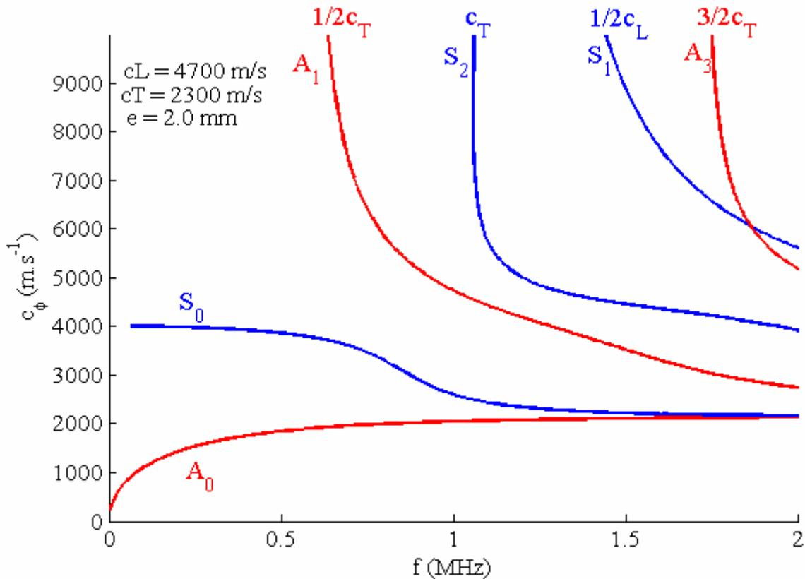
Figure 2 : Vitesses de phase des modes de Lamb en fonction de la fréquence dans une plaque libre de cuivre isotrope ( $c_L=4700$  m/s et  $c_T = 2300$  m/s). Les courbes ont été obtenues à partir d'un code de calcul développé par Josquin Foiret et Maryline Talmant dans le cadre de la thèse de Josquin Foiret.
