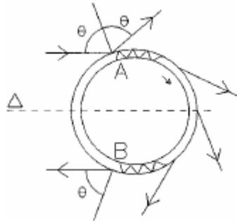
Figure 8 : Schéma des points A et B de génération et de rayonnement vers la barrette des ondes de Lamb dans un tube. Les ondes sont générées à un angle d'incidence  $\theta$  et se propagent en circonférence du tube en rayonnant sous le même angle  $\theta$ . Ces points de génération se comportent comme des diffuseurs ou sources secondaires. (source : [4])
