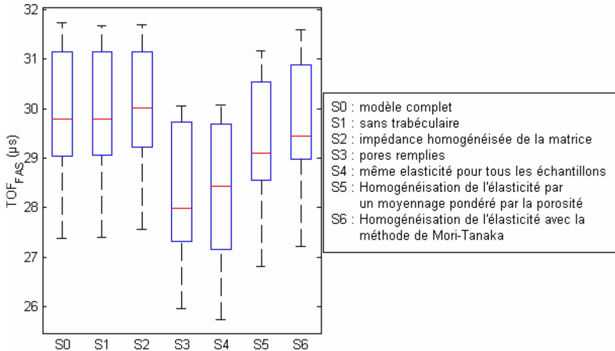
**Figure 22 : Boîte à moustaches représentant la distribution de  $TOF_{FAS}$  pour chaque modèle  $S_i$  (i allant de 1 à 6). La valeur médiane est indiquée par un trait rouge, les 25<sup>ème</sup> et 75<sup>ème</sup> centiles sont données par les bornes inférieures et supérieures de l'encadré en bleu et les valeurs extrêmes sont indiquées par les extrémités de la barre vertical en pointillé.**
