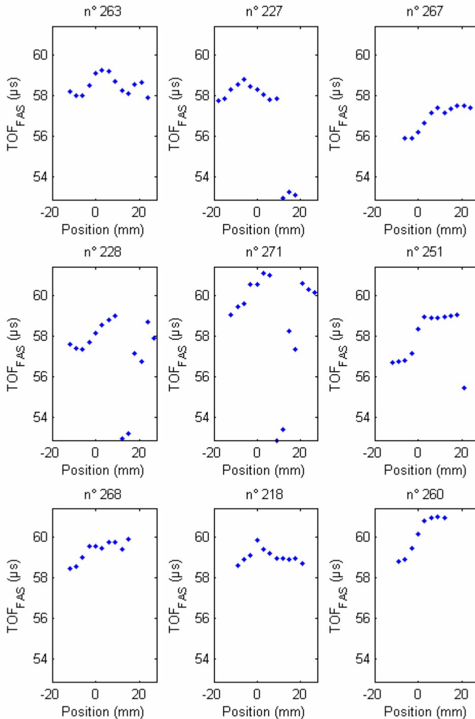
**Figure 13 : Représentation de  $TOF_{FAS}$  en fonction de la position le long de l'axe du col pour l'ensemble des échantillons. La position 0 mm correspond au milieu du col, les positions à valeur négative à la région vers la tête et les positions à valeur positive à la région vers le trochanter.**
