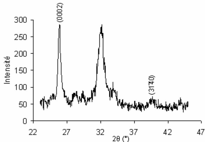
**Figure 6 : Diagramme de diffraction par rayons-X obtenus pour l'échantillon n°251 dans la région antéro-médiale. Le pic (0002) est associé à la quantité de cristaux alignés avec l'axe de l'os.**
