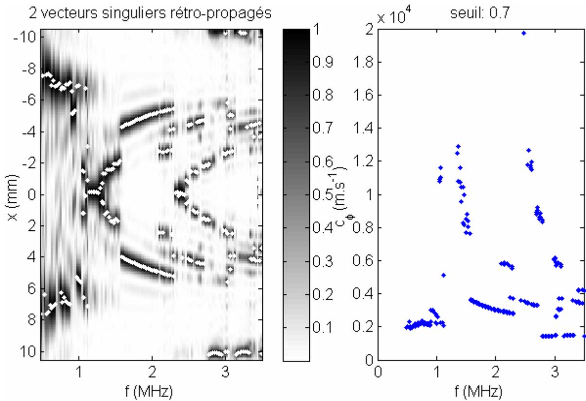
Figure 14.a : Champ de pression au centre du tube et courbes de dispersions obtenues pour la rétro-propagation des deux premiers vecteurs singuliers. Le champ est normalisé par son maximum à chaque fréquence.
