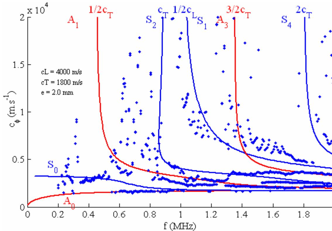
**Figure 20 :** Superposition des courbes de dispersion du tube d'os de référence chargé d'eau (points bleus) obtenues avec la méthode DORT par simulation avec les courbes théoriques pour une plaque d'os de référence libre de même épaisseur (modes antisymétriques en rouge et modes symétriques en bleu).
