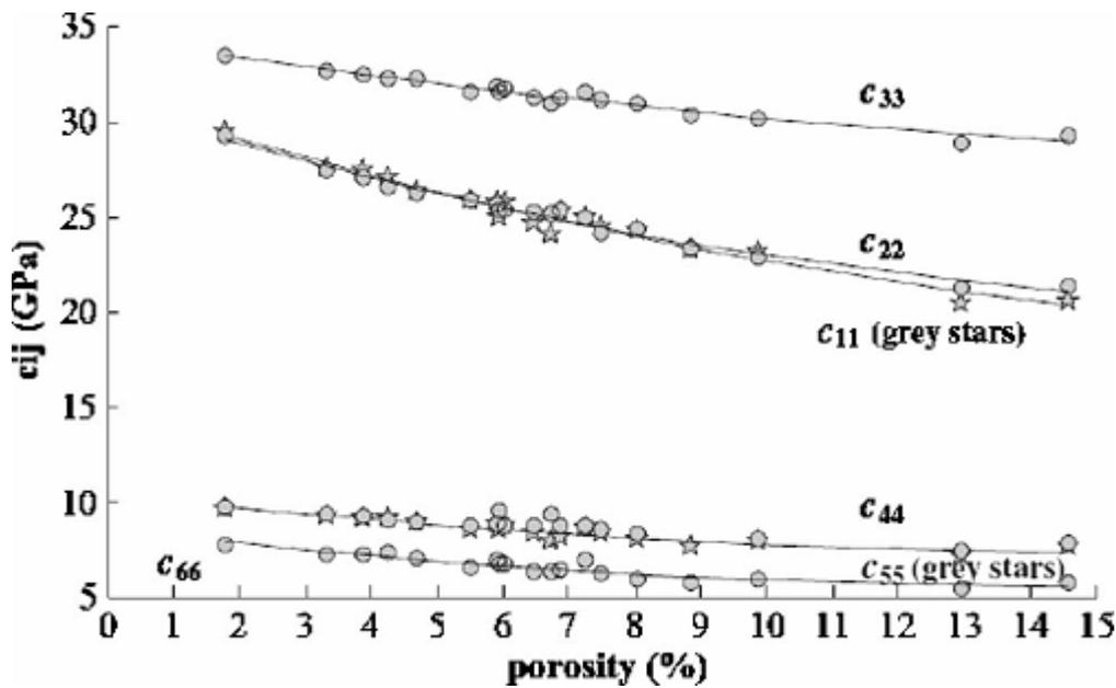
Figure 19 : Coefficients élastiques effectifs en fonction de la porosité. Les résultats ont été obtenus à partir d'une étude en simulation 3-D (source :[46]).
