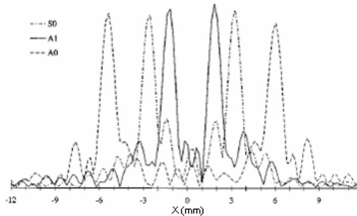
**Figure 10 :** Superposition des champs de pression obtenus sur une droite perpendiculaire à l'axe de la barrette et passant par le milieu du tube (axe X de la Figure 6) après rétro-propagation numérique des vecteurs singuliers significatifs. Les maxima des champs de pression correspondent aux points de focalisation. (source : [4])
