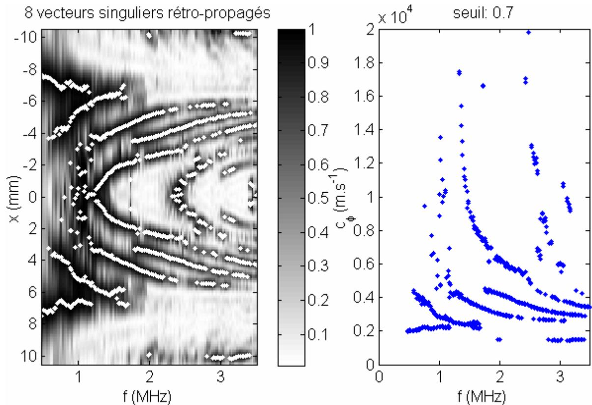
Figure 14.d : Champ de pression au centre du tube et courbes de dispersion obtenues pour la rétro-propagation des huit premiers vecteurs singuliers.
