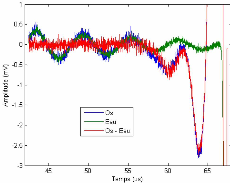
**Figure 6 : Signaux reçus avec l'os intercalé (ligne bleue) et sans l'os intercalé (ligne verte). La soustraction entre ces deux signaux est également représentée (ligne rouge) pour filtrer le bruit basse fréquence.**
