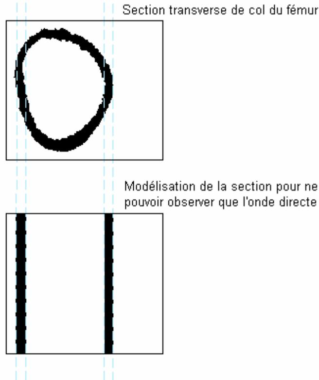
**Figure 7 : Modélisation de la section transverse du col du fémur par deux rectangles dont la largeur est égale à l'épaisseur corticale moyenne dans les régions antérieure et postérieure afin d'estimer le TOF de l'onde traversant le canal médullaire.**
