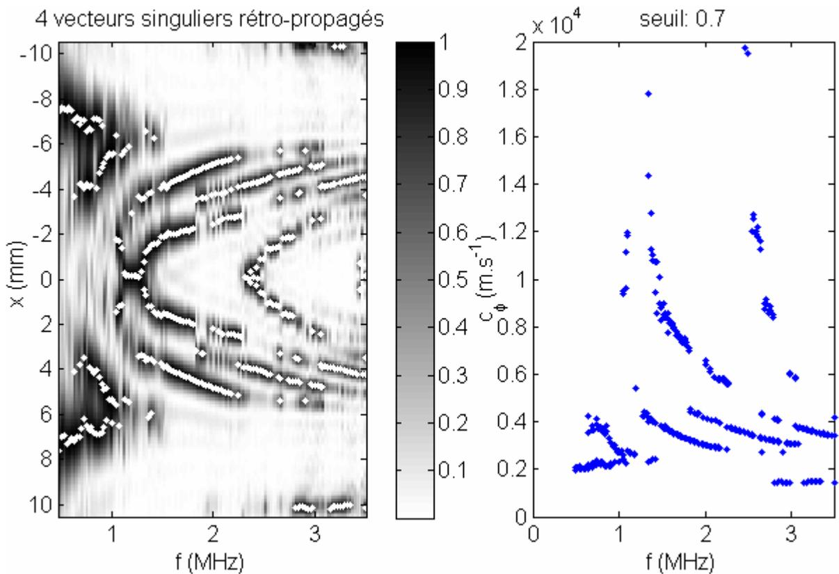
Figure 14.b : Champ de pression au centre du tube et courbes de dispersion obtenues pour la rétro-propagation des quatre premiers vecteurs singuliers.
