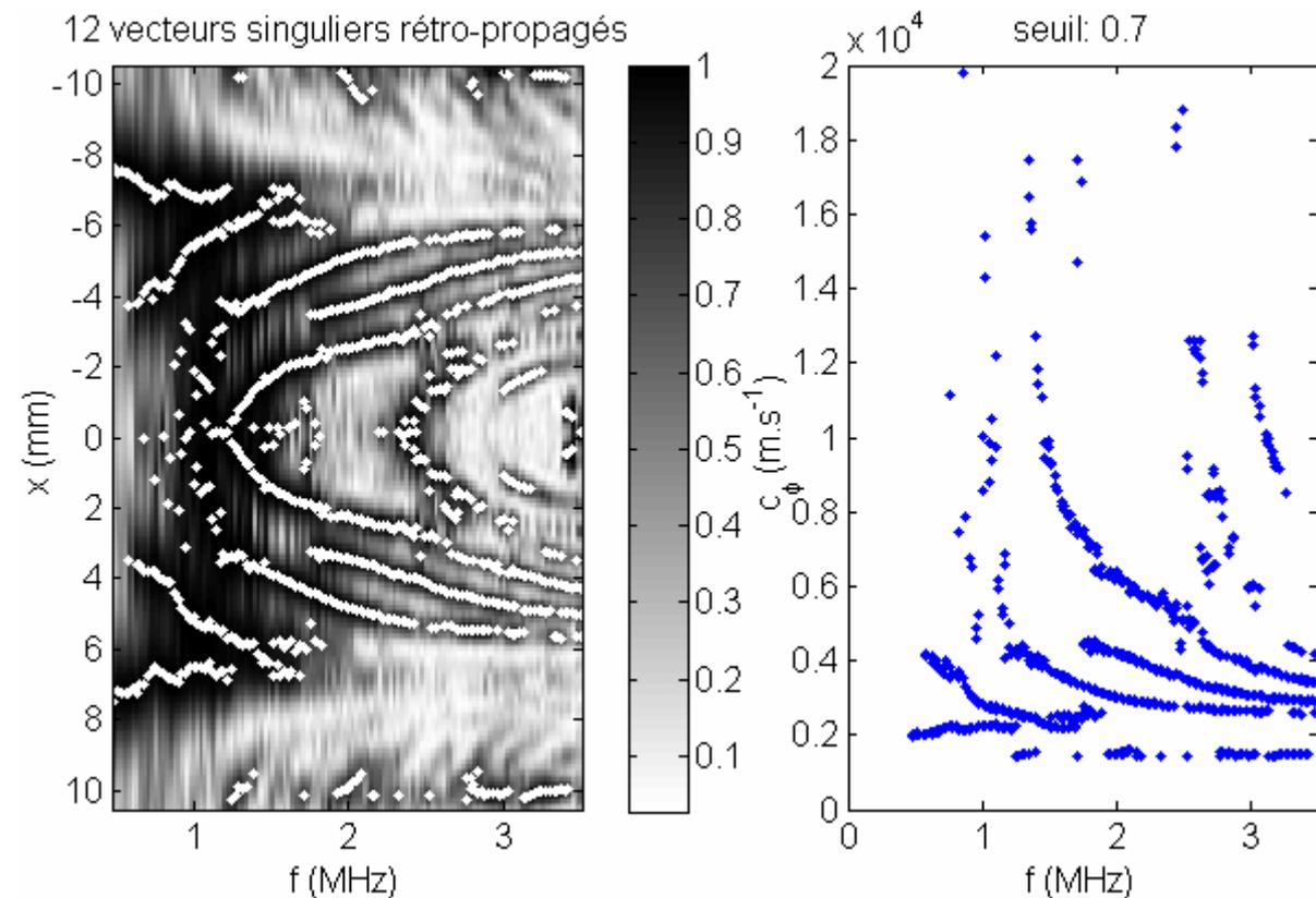
Figure 14.f : Champ de pression au centre du tube et courbes de dispersion obtenues pour la rétro-propagation des douze premiers vecteurs singuliers.
