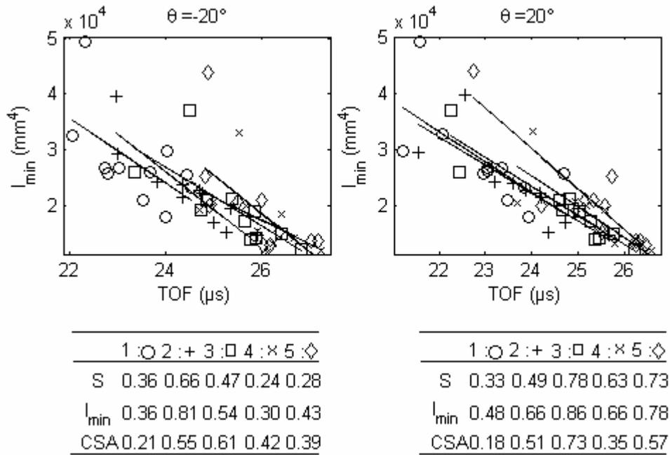
Figure 12 : Représentation de  $I_{min}$  en fonction de  $TOF_{FAS}$  pour différentes directions de propagation données par l'angle  $\theta$ . Les coefficients de corrélation  $R^2$  entre  $TOF_{FAS}$  et  $W$ ,  $I_{min}$  et  $CSA$  sont indiqués dans le tableau. Les symboles représentent la position le long du col ( $\circ$ : proximale,  $+$ : proximale-milieu,  $\square$ : milieu,  $\times$ : milieu-distale,  $\diamond$ : distale).
