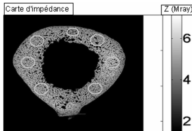
**Figure 7 : Image d'impédance de l'échantillon n°218. Les régions d'intérêt dans lesquelles sont calculées l'impédance moyenne et la porosité sont indiquées par un marquage circulaire.**
