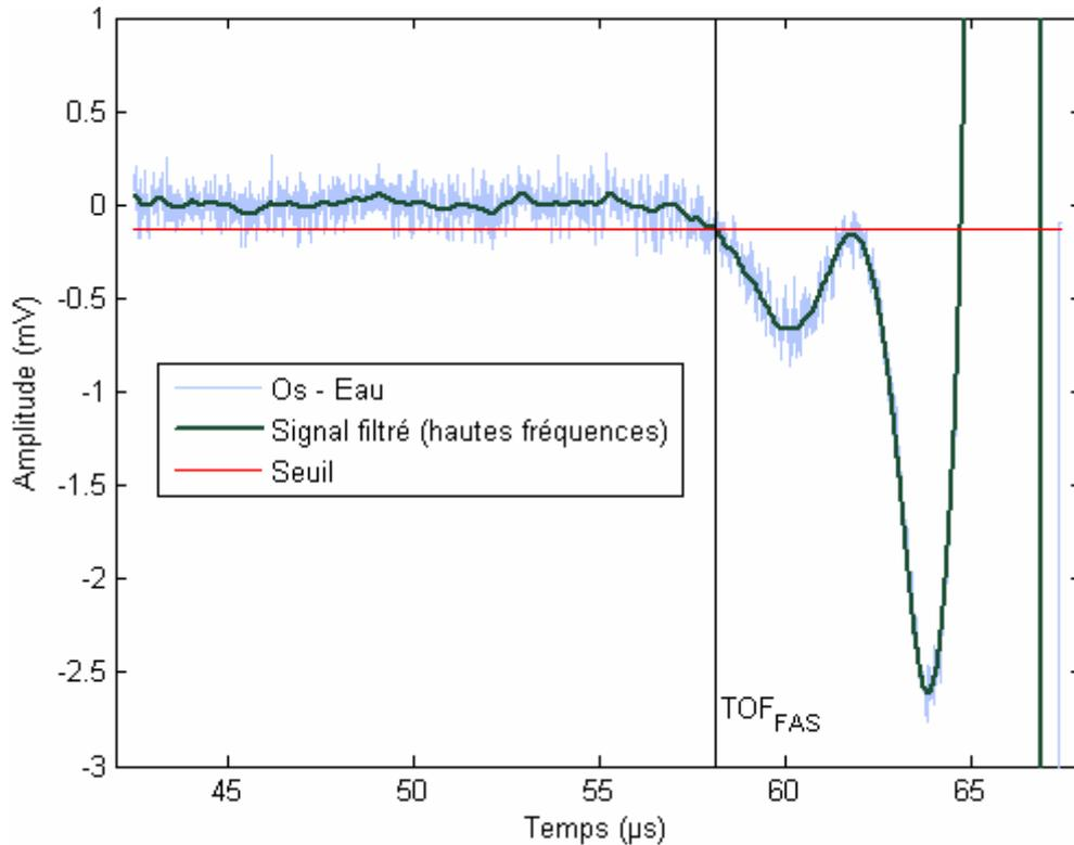
**Figure 7 : Signaux ayant subi un filtrage basse fréquence (ligne bleue) puis haute fréquence (ligne verte). Le seuil utilisé pour calculer  $TOF_{FAS}$  est indiqué par une ligne rouge et son intersection avec le signal filtré en haute fréquence donne  $TOF_{FAS}$ .**
