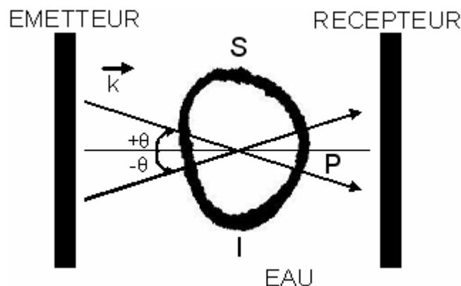
**Figure 4 : Configuration spatiale de la simulation numérique en faisant varier la direction du tir ultrasonore d'un angle  $\pm\theta$ . En pratique, une rotation d'un angle  $\pm\theta$  de la section transverse de l'os était réalisée et le tir ultrasonore était perpendiculaire aux capteurs.**
