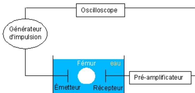
Figure 3 : Schéma du montage expérimental ultrasonore.
