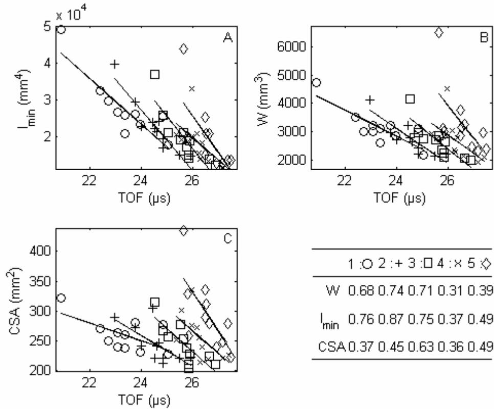
**Figure 10 :** Relation entre  $TOF_{FAS}$  et  $I_{min}$  (A),  $W$  (B) et  $CSA$  (C) pour 5 les sections transverses des 11 cols du fémur. Les coefficients de corrélation  $R^2$  sont indiqués dans le tableau. Les symboles représentent la position le long du col (○: proximale, +: proximale-milieu, □: milieu, ×: milieu-distale, ◇: distale).
