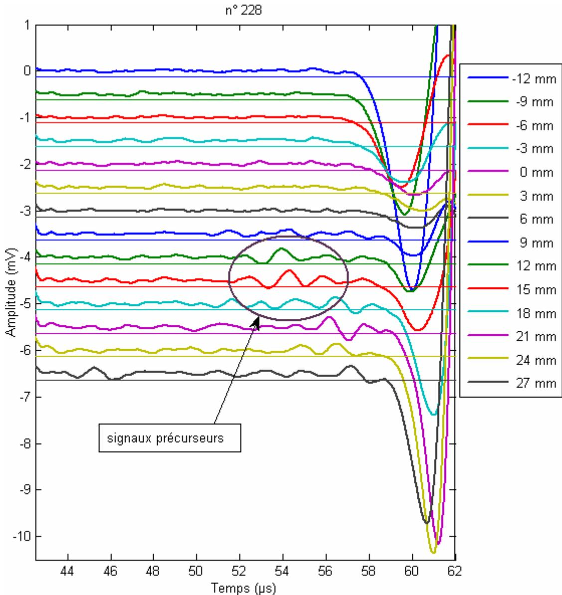
**Figure 12 :** Premier signal observé pour l'ensemble des positions le long de l'axe du col pour l'échantillon n°228. Les signaux sont décalés en amplitude pour les comparer entre eux. Les positions le long de l'axe du col sont indiquées dans l'encadré sur le côté droit. Un signal précurseur est observé pour certaines positions.
