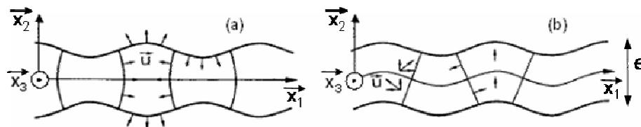
Figure 1 : Déformation d'une plaque due à la propagation des ondes de Lamb correspondant à un mode symétrique (a) et antisymétrique (b). Le vecteur  $\vec{x}_1$  correspond à la direction de propagation, et le vecteur  $\vec{u}$  correspond au vecteur déplacement. (source : [2])
