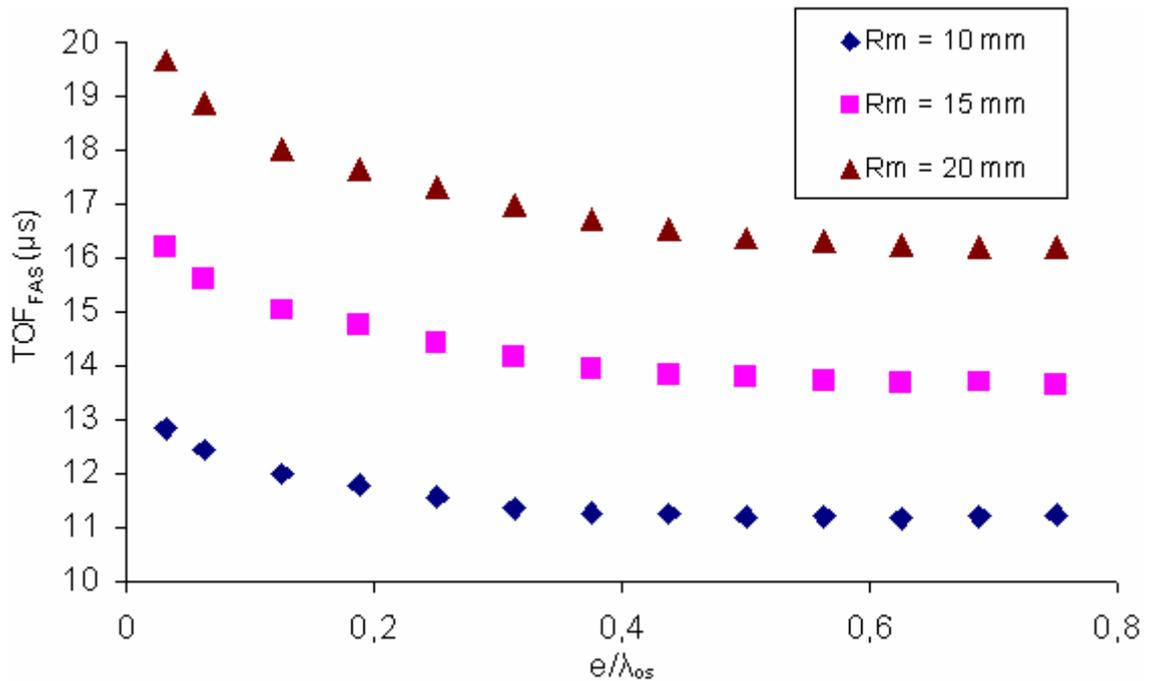
**Figure 4 : Variation de  $TOF_{FAS}$  en fonction de l'épaisseur de l'ellipse ( $e$ ) normalisée par la longueur d'onde dans l'os ( $\lambda_{os}$ ) pour différents rayons moyens ( $R_m$ ) de l'ellipse.**
