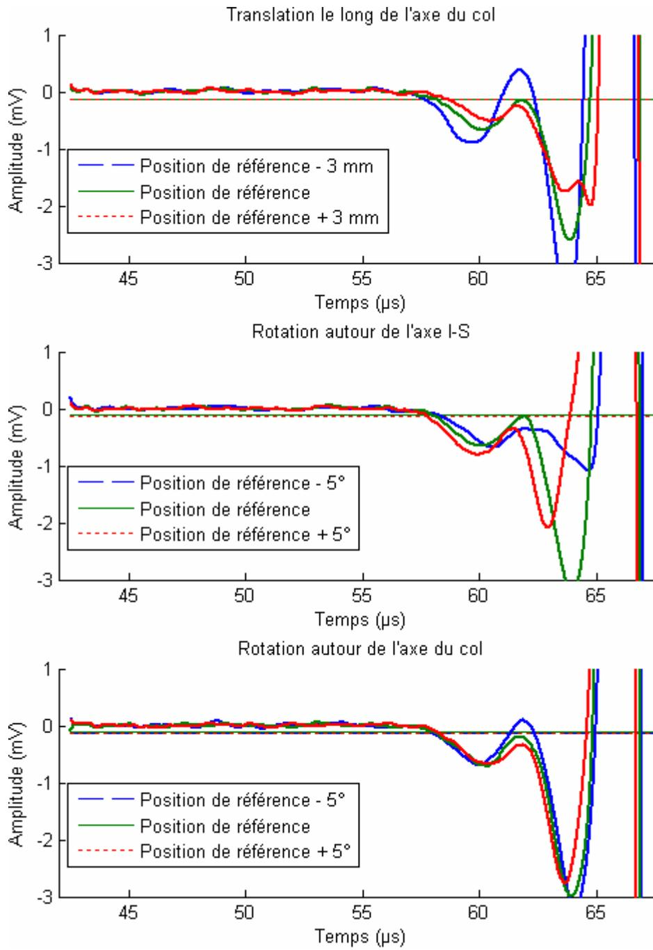
Figure 8 : Signaux reçus pour un même échantillon pour les trois types de positionnement. Le seuil utilisé pour le calcul de  $TOF_{FAS}$  est représenté pour chaque signal.
