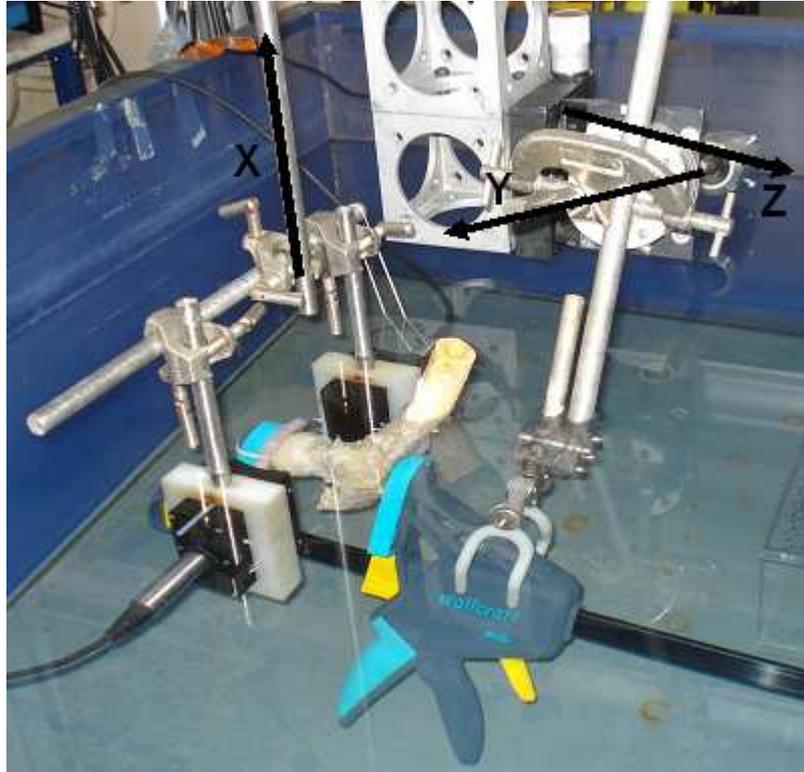
**Photo du montage expérimental illustrant le positionnement des capteurs par rapport au fémur. Les vecteurs X, Y et Z indiquent les axes par rapport auxquels il est possible de réaliser une rotation de manière contrôlée.**
