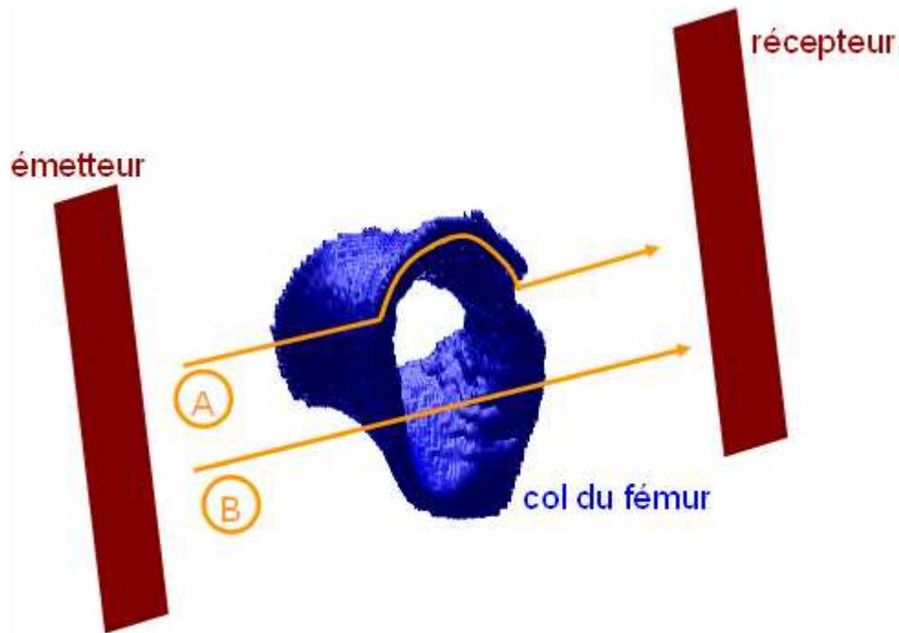
**Figure 6 : Schéma des deux principaux trajets dans le col du fémur en transmission transverse. Seule la coque corticale du col fémoral est représentée. Trajet A : onde circéférentielle, trajet B : onde directe (se propageant en ligne droite).**
