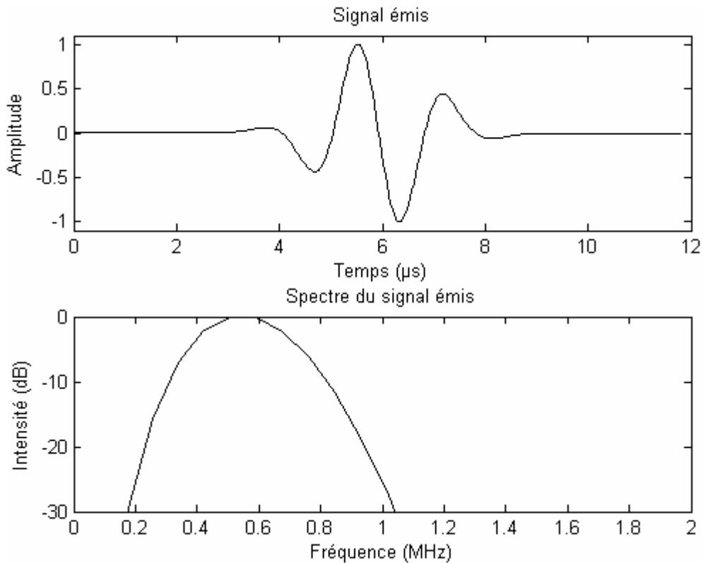
**Figure 5 : Signal d'émission et son spectre.**
