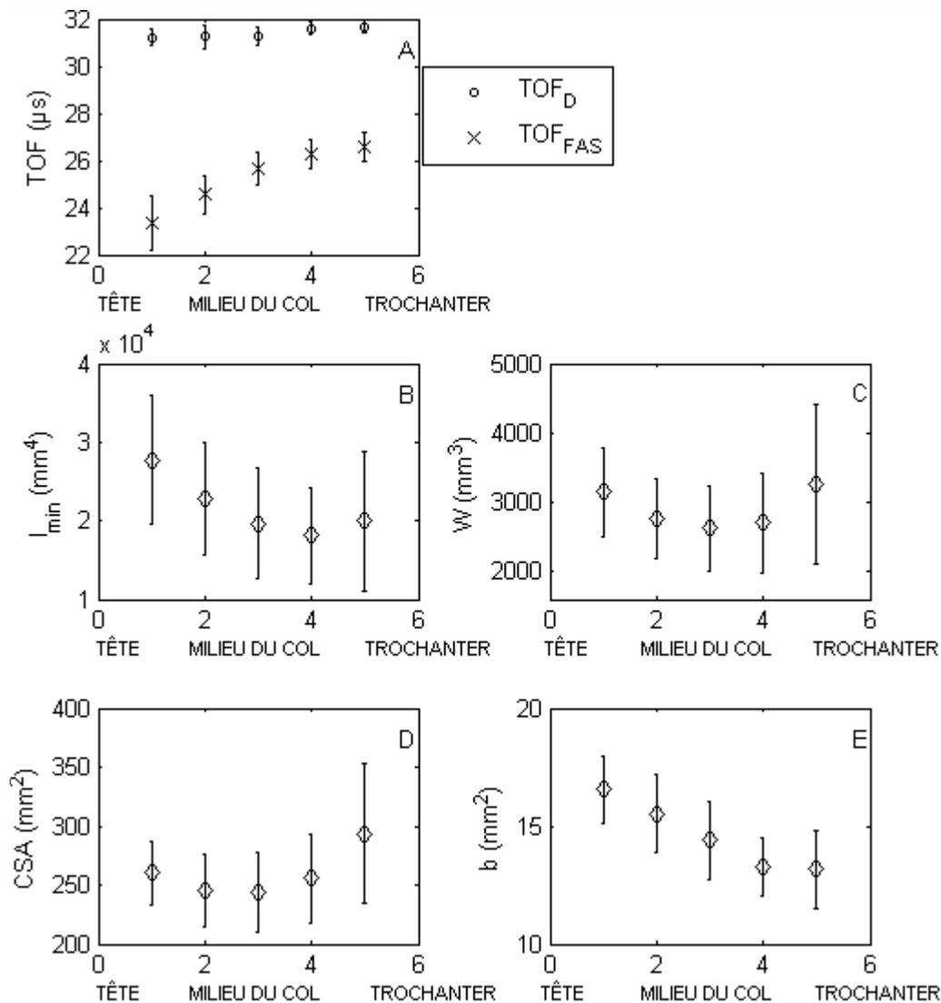
Figure 9 : Variation de  $TOF_{FAS}$ ,  $TOF_D$  (A),  $I_{min}$  (B), W (C), CSA (D) et b (E) en fonction de la position le long du col. Les valeurs moyennes sont représentées par des symboles et l'écart type par des barres d'erreurs. La position 1 est la position proximale et la position 5 la position distale.
