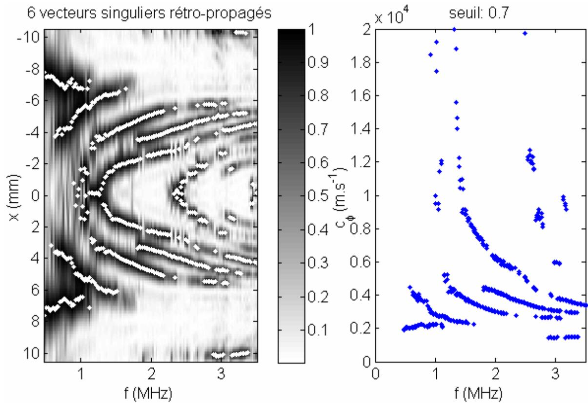
Figure 14.c : Champ de pression au centre du tube et courbes de dispersion obtenues pour la rétro-propagation des six premiers vecteurs singuliers.
