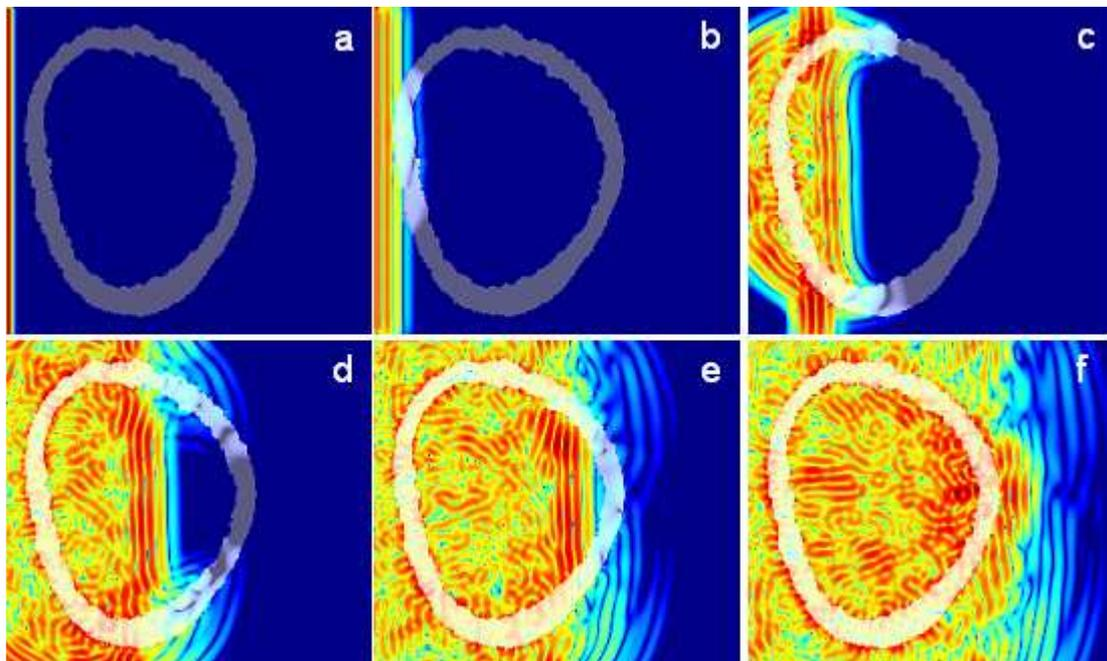
Figure 8 : Snapshots du champ de déplacement à différents temps de propagation. (a) :  $t = 0\mu s$ , (b) :  $t = 5\mu s$ , (c) :  $t = 10\mu s$ , (d) :  $t = 15\mu s$ , (e) :  $t = 20\mu s$ , (f) :  $t = 25\mu s$ . Les figures 8d et 8e montrent clairement que le FAS est associé à l'onde circumférentielle.
