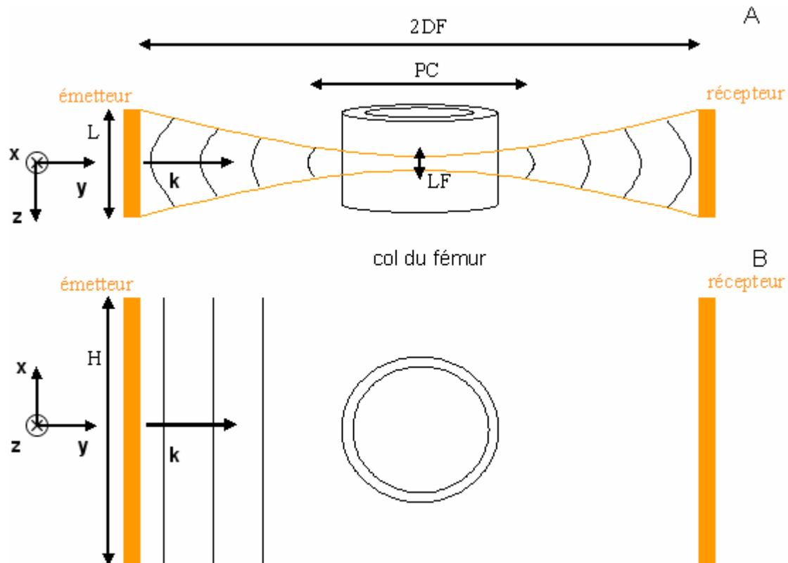
Figure 1 : Configuration des capteurs par rapport au col du fémur avec une vue dans un plan perpendiculaire à la hauteur des capteurs (A) et un plan perpendiculaire à la largeur des capteurs (B). La distance focale (DF), la profondeur de champ (PC), la largeur focale (LF) ainsi que la largeur (L) et la hauteur (H) des capteurs sont représentées. A cause de la faible largeur focale au niveau du fémur, la configuration est proche de celle utilisée lors des simulations 2-D.
