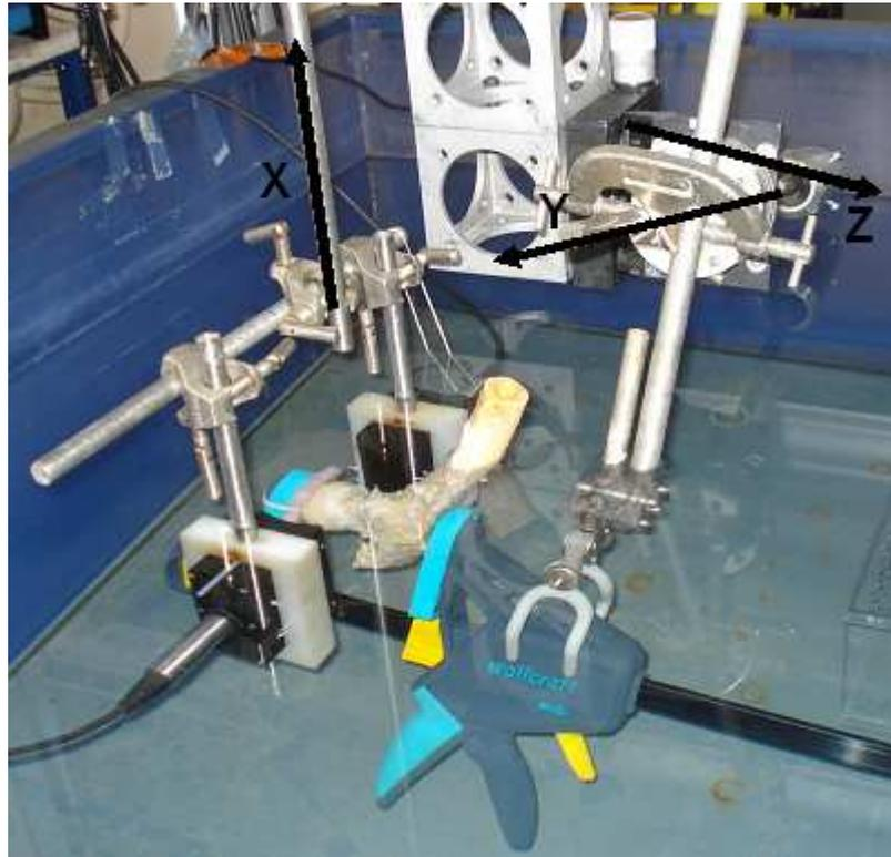
**Figure 5 : Photo du montage expérimental illustrant le positionnement des capteurs par rapport au fémur. Le fémur est maintenu par un serre-joint dont les mâchoires appuient sur la tête fémorale et la base du trochanter. Les vecteurs X, Y et Z indiquent les axes par rapport auxquels il est possible de réaliser une rotation de manière contrôlée.**
