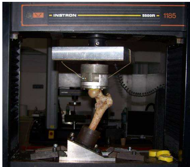
Figure 9 : Machine d'essai mesurant la résistance osseuse du fémur en configuration d'appui monopodal.
