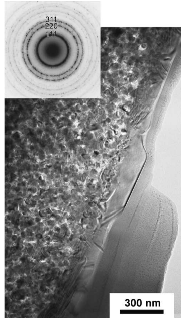
FIGURE 2.3 – Image en microscopie électronique en transmission en champ clair de la couche de SiC avec un cliché de diffraction en aire sélectionnée des cristaux de dimension nanométrique.
