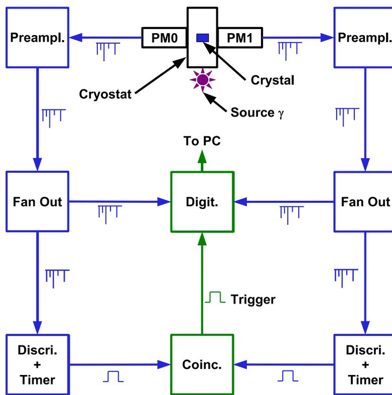
**Figure 4.7** – Schéma de la chaîne d'acquisition électronique avec une coïncidence entre les 2 PMTs. Le signal est tout d'abord préamplifié avant d'être dupliqué par un module Fan In/Fan Out. Un signal logique créé par un module de discrimination permet enfin d'effectuer une coïncidence sur une fenêtre de temps ajustable, qui va servir de déclenchement pour l'acquisition des signaux.
