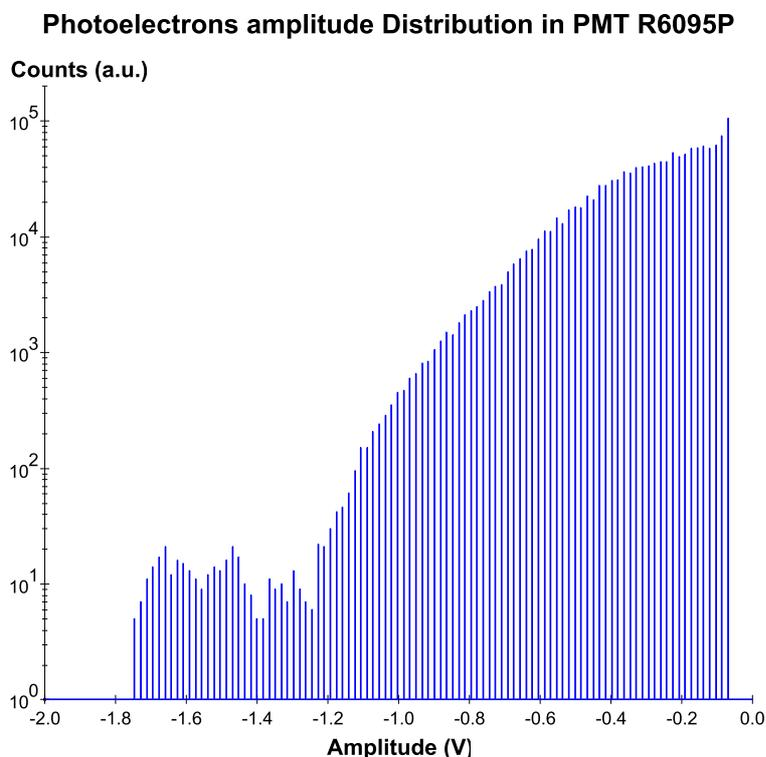
**Figure 4.5** – *Spectre de la distribution des amplitudes des photoélectrons individuels dans un PMT Hamamatsu R6095P monté sur une embase E990-501 et polarisé sous une tension de 1050 V. La numérisation est effectuée sur 8 bits et la gamme verticale est de  $\pm 2$  V. Le grand nombre de photoélectrons de basse amplitude (en valeur absolue) est dû à des rebonds électroniques.*
