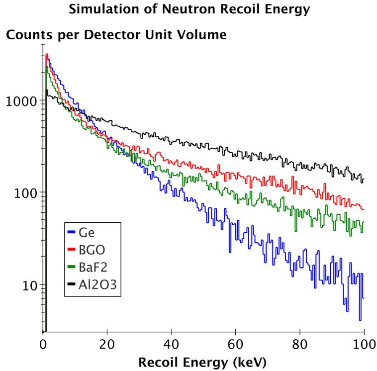
**Figure 2.3** – Spectres en énergie de recul de neutrons obtenus pour différents cristaux cibles par simulations Monte-Carlo produite avec Geant 4 et reproduisant la géométrie et l’environnement de l’expérience EDELWEISS II. Les cristaux ont le même volume et une source d’Am-Be est utilisée. Un seuil en énergie de recul de 1 keV est appliqué.
