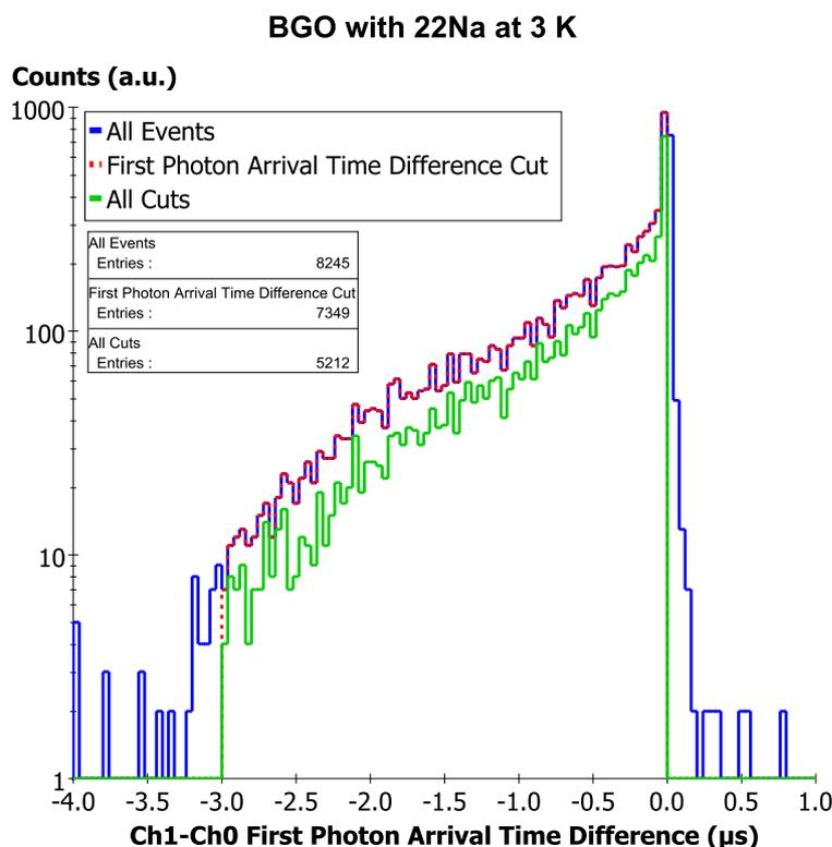
**Figure 4.21** – *Distribution de la différence des temps d'arrivée des premiers photons entre le cristal de référence (Ch1) et le cristal dans le cryostat (Ch0). Bleu : tous les événements. Rouge pointillé : après la coupure sur la différence des temps d'arrivée du premier photon. Vert : après toutes les coupures.*
