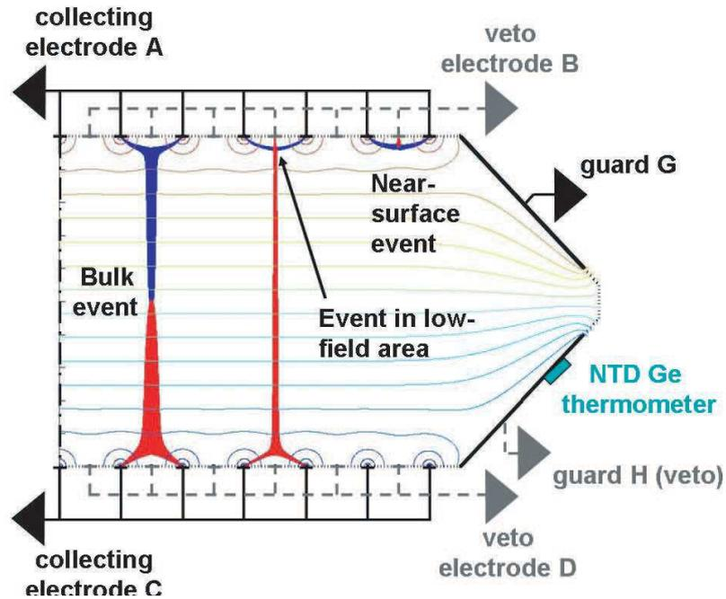
**Figure 3.6** – Schéma de principe d'un détecteur *InterDigit*. Les événements fiduciels (*bulk*) sont lus par les électrodes de collecte tandis que les événements de surface sont lus par les électrodes de veto et peuvent ainsi être rejetés. Le senseur thermique est un NTD.
