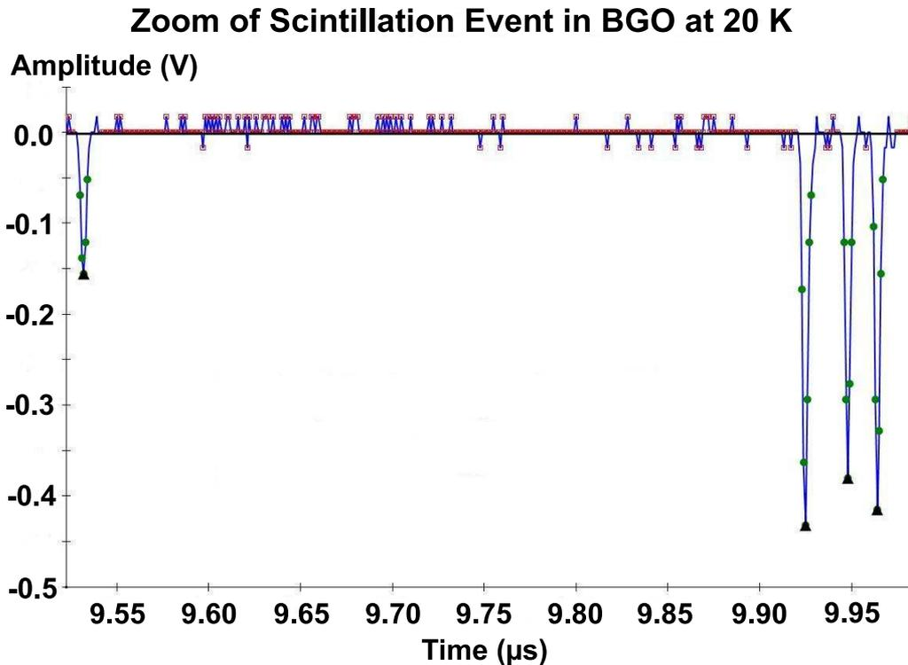
**Figure 4.9** – Exemple d'un évènement numérisé par le PXI-5152 à un taux d'acquisition de 1 GS/s. Les photons ont une largeur à mi-hauteur d'environ 5 ns ce qui permet de bien les résoudre et de les identifier. Noir-vert : photons. Rouge : ligne de base
