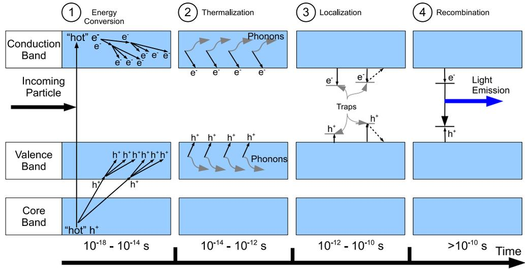
**Figure 4.1** – Schéma général du mécanisme de la scintillation dans un cristal isolant inorganique. Le processus est divisé en quatre étapes et s'étal sur une période allant de 10<sup>-18</sup> s à plus de 10<sup>-8</sup> s.
