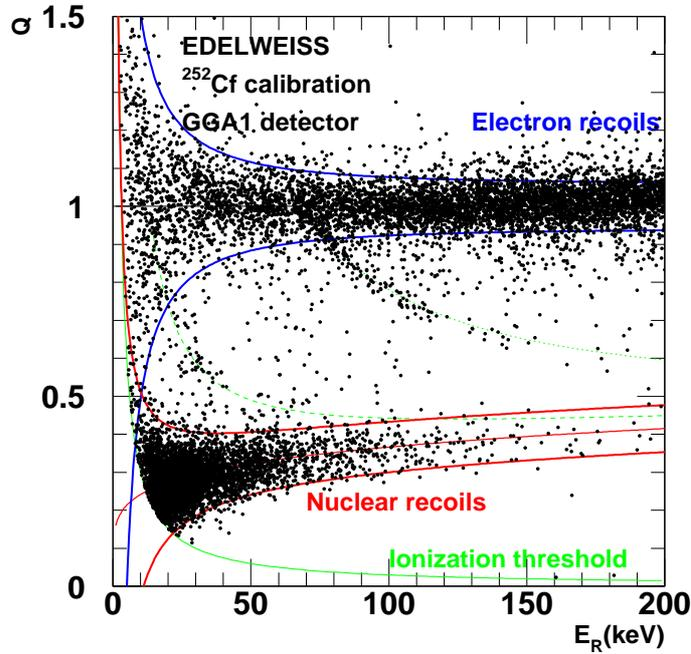
**Figure 3.3** – *QPlot montrant le facteur de quenching en fonction des énergies de recul dans un bolomètre germanium, lors d’une calibration  $\gamma/n$  avec l’expérience EDELWEISS I. Les bandes de recoils électroniques et nucléaires sont pour des valeurs respectivement de  $Q=1$  et  $Q=0.3$ .*
