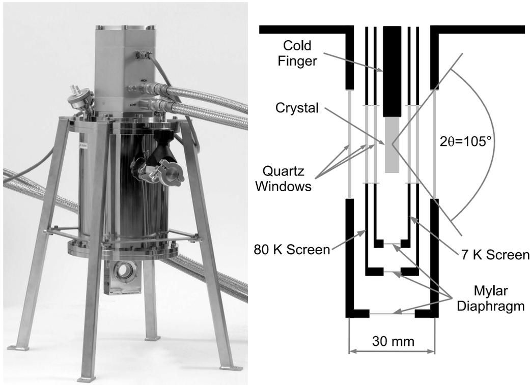
**Figure 4.2** – *Gauche : vue d'ensemble du cryostat. Droite : géométrie optique dans le plan vertical perpendiculaire aux fenêtres circulaires (pas à l'échelle). La distance entre le centre du cryostat et les fenêtres extérieures a été réduite à 15 mm pour augmenter l'efficacité de la collecte de lumière. Dans cette géométrie "see-through", le centre optique voit chaque fenêtre avec une fraction de l'angle solide total de 20 %.*
