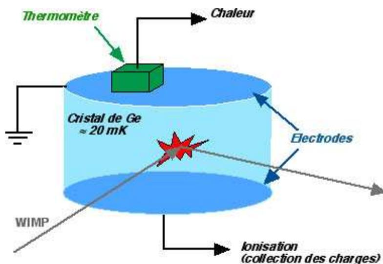
**Figure 3.2** – Schéma d'un bolomètre double voie ionisation-chaaleur en germanium. Lors de l'interaction d'une particule dans le cristal, les deux signaux sont créés. Un senseur thermique Ge-NTD collecte les phonons, tandis qu'une électrode collecte la charge électrique.
