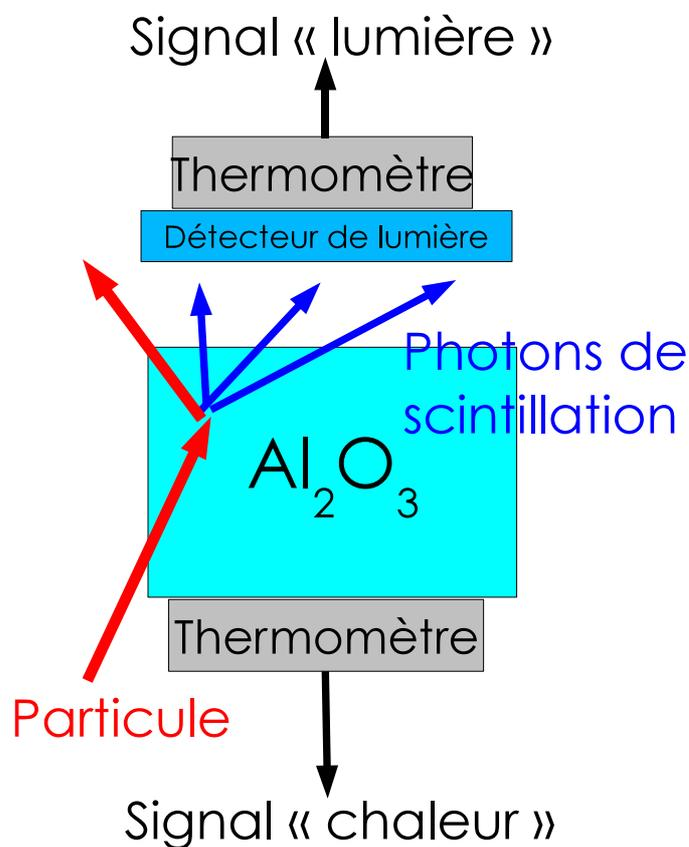
**Figure 3.8** – Schéma d'un bolomètre à double voie scintillation-chaueur. Lors de l'interaction d'une particule dans le cristal (ici du saphir), les deux signaux sont créés. Un senseur thermique collecte les phonons, tandis qu'un second cristal permet de collecter les photons et produit à son tour des phonons, qui seront mesurés par un autre senseur thermique.
