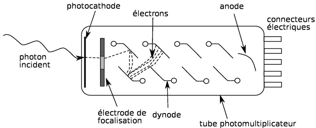
**Figure 4.4** – Schéma de fonctionnement d'un PMT. Lorsqu'un photon lumineux est absorbé par la photocathode, il peut y avoir éjection d'un photoélectron qui sera accéléré par le champ électrique entre l'anode et la photocathode. Chaque collision avec les dynodes multipliera le nombre d'électrons dont le signal de sortie sera proportionnel au nombre de photons incidents.
