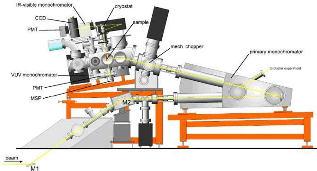
**Figure 6.1** – *L'expérience Superlumi à Hasylab (Hambourg, Allemagne). Le faisceau VUV est sélectionnable en énergie par le monochromateur primaire. La luminescence des cristaux, placés dans un cryostat à hélium, est mesurée par un PMT ou un détecteur CCD, après sélection par un monochromateur secondaire.*
