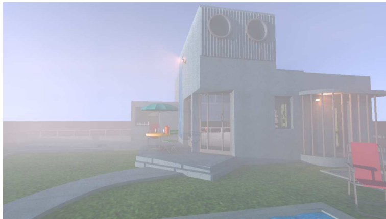
FIG. 2.20: Résultat obtenu avec la scène de la villa Arpel vue de l'extérieur et une fumée homogène dont les caractéristiques sont \alpha = 0,01 et \sigma = 0,06 . L'éclairage est composé d'éclairage artificiel et d'un modèle de ciel CIE clair avec un soleil rasant.
