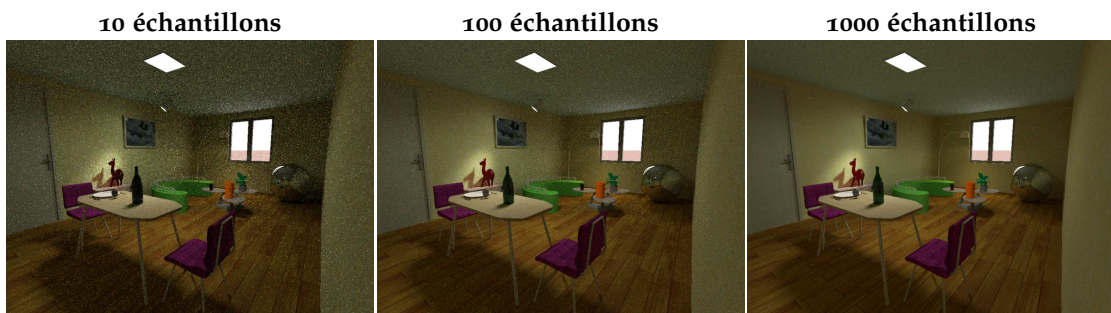
FIG. 2.2: Réduction de la variance en sur-échantillonnant avec la méthode de tracé de chemins monodirectionnel : plus il y a d'échantillons, moins il y a de bruit mais plus les temps de calcul sont longs.
