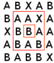
FIG. 2.2: Le tracé rouge délimite le voisinage de Moore de rayon 1 de l'agent B qui est encadré.
