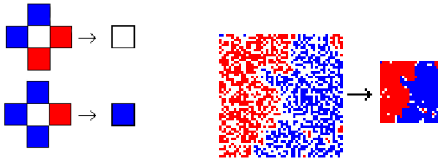
FIG. 2.12: Exemple de renormalisation. La renormalisation est réalisée sur une configuration à T = \frac{1}{5} et \rho = 50\% .
