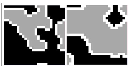
FIG. 3.5: Types d'interfaces de lacunes : interfaces d'épaisseur 1 (gauche) et d'épaisseur 2 (droite).
