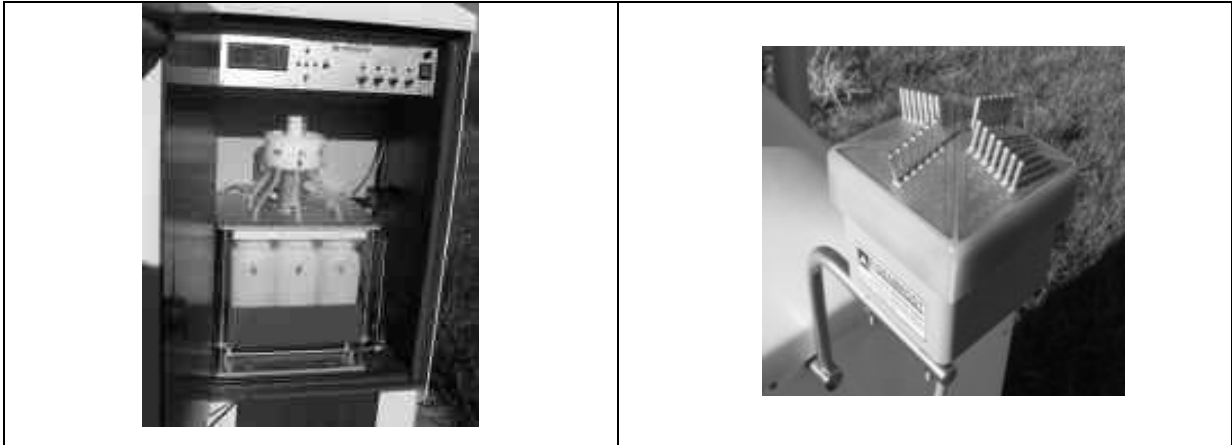
Figure I-12 : Pluviomètre journalier et capteur d'humidité permettant l'ouverture automatique.
