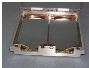
Figure 2.13 – Le détecteur Si(Li) : 2 ème étage du télescope MUST2, avec 4,5 mm d'épaisseur. Il peut arrêter les protons jusqu'à 32 MeV.
