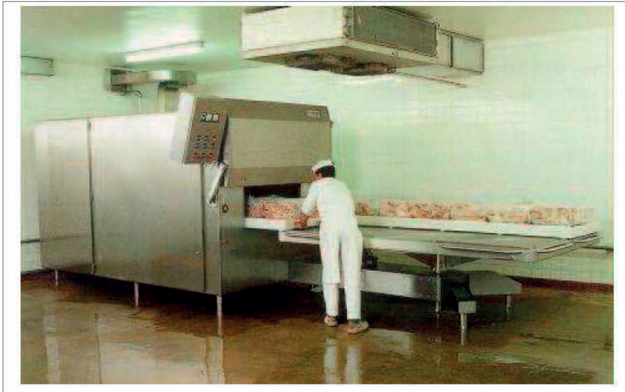
Figure 7 : Décongélation de viandes et poissons assistée par micro-ondes (Virot, 2009).
