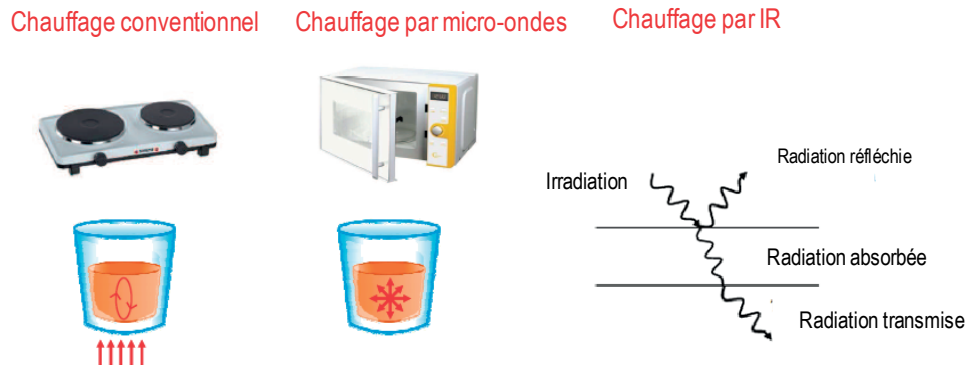
Figure 5: Comparaison entre chauffage conventionnel, chauffage par micro-onde, chauffage par infrarouge (Krishnamurthy, Khurana et al. , 2008; Bozkurt et Icier, 2010).
