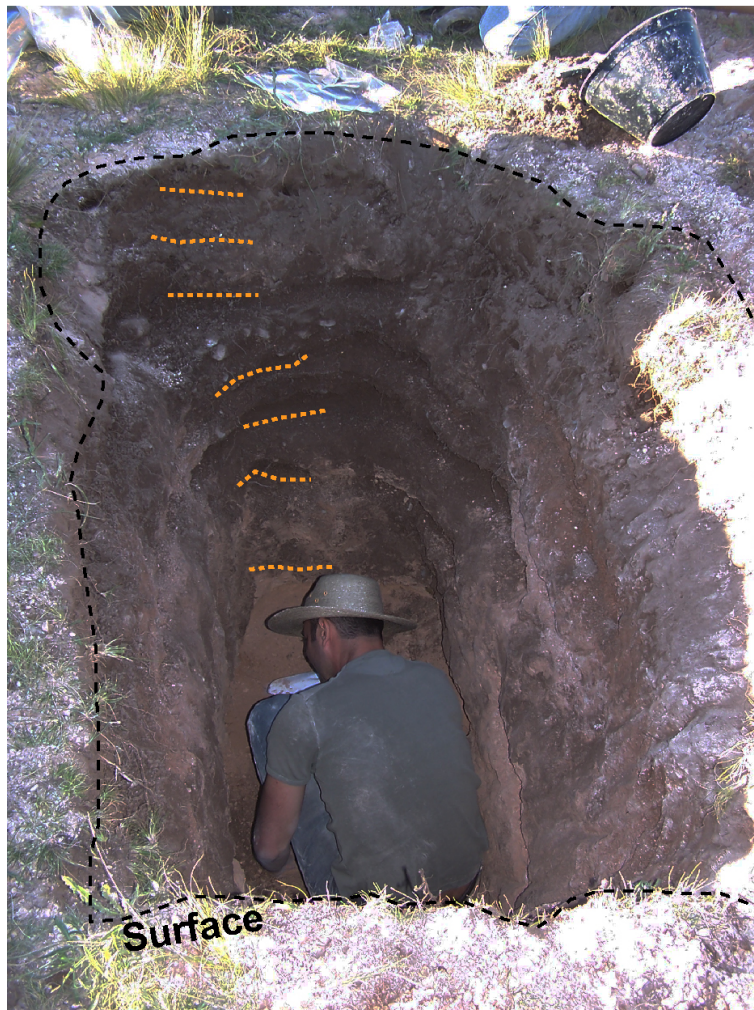
FIGURE 5.38 – Echantillonnage de T3 pour effectuer un profil en profondeur. Les lignes pointillées orange indiquent les profondeurs des échantillons traités (cf. table 5.2). Le plus profond est à 1,55 m (photographie R. Charrier, 2008).
