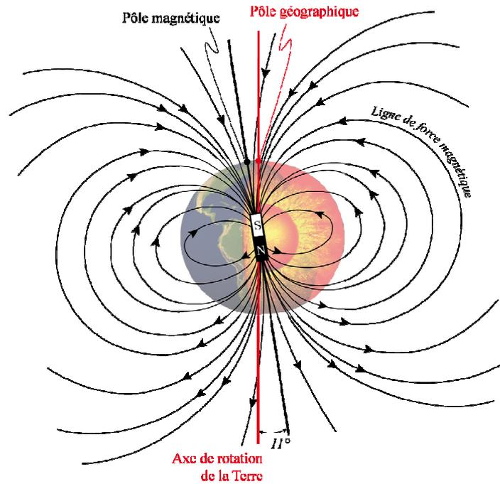
Figure A1.7 : Le champ magnétique terrestre est assimilable au champ créé par un dipôle magnétique placé au centre de la Terre et globalement orienté parallèlement à l'axe de rotation de la Terre.
