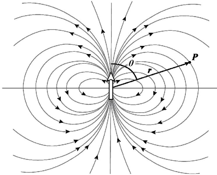
Figure A1.6 : Lignes de force du champ magnétique d'un dipôle. La flèche symbolise le dipôle magnétique,  $r$  est la distance vectorielle et  $\theta$  la colatitude, se référant à un point  $P$  de coordonnées polaires.
