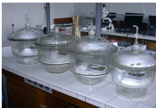
Photographie 8: Enceinte d'exposition des mousses en conditions contrôlées – volume 20 litres (Photo Faburé, 2008)
