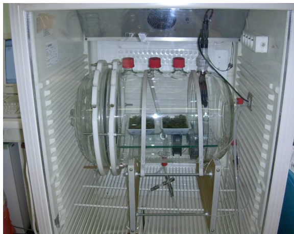
Figure 31: Dispositif d'exposition aux BTEX en enceinte, à faibles concentrations (d'après Pennequin-Cardinal, 2005) – (photo Faburé 2008)
