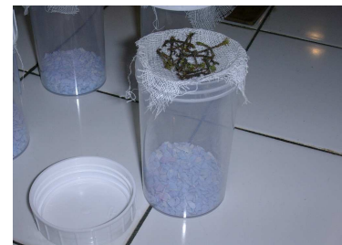
Figure 25: Dispositif de déshydratation lente des mousses (Photo Faburé, 2007)
