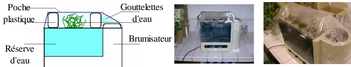
Figure 27 : Dispositif de réhydratation lente des mousses (photo Faburé, 2007)
