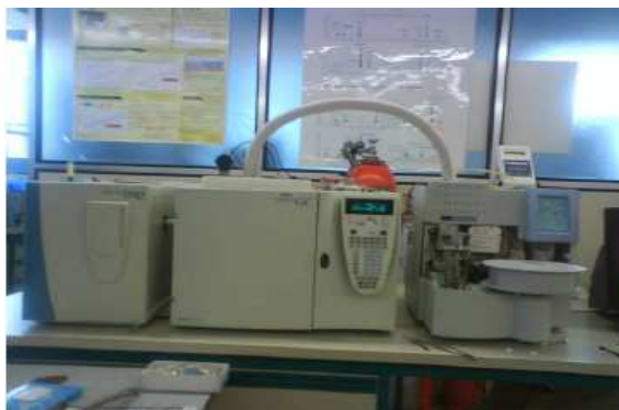
Photographie 1: Thermodésorbeur ATD 400 Perkin Elmer couplé à un chromatographe en phase gazeuse doté d'une détection par ionisation de flamme et d'un spectromètre de masse (Photo Faburé, 2007)
