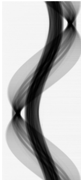
Figure 87 : L'ensemble des profils d'atténuation forme un sinogramme.
