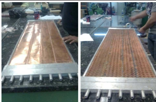
Figure 2.22 – Les panneaux solaires thermiques développés à l'université de Rutgers (El-Sawi et al., 2010)
