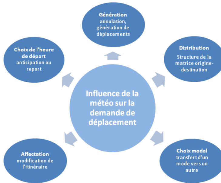
Figure 1.5 – Modifications possibles des choix de déplacement en cas de conditions météorologiques dégradées (adapté de [21] avec la permission de l'auteur).
