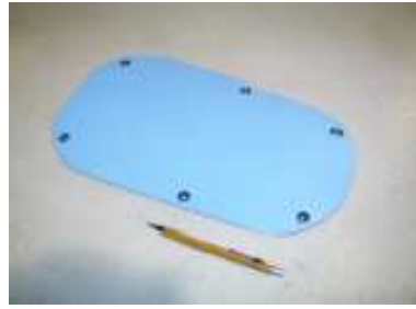
Fig. 1.16 – Trappe d'accès en carbone/époxy [CHE08]
