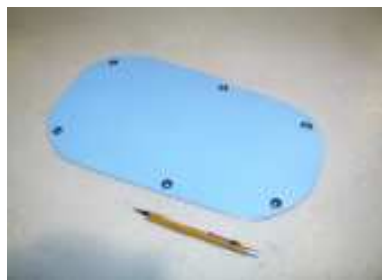
Fig. 1.16 – Trappe d'accès en carbone/époxy [CHE08]
