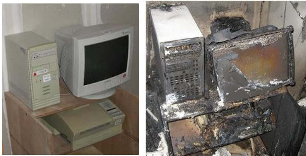
367. Ensemble informatique placé dans la chambre avant et après l'expérience
