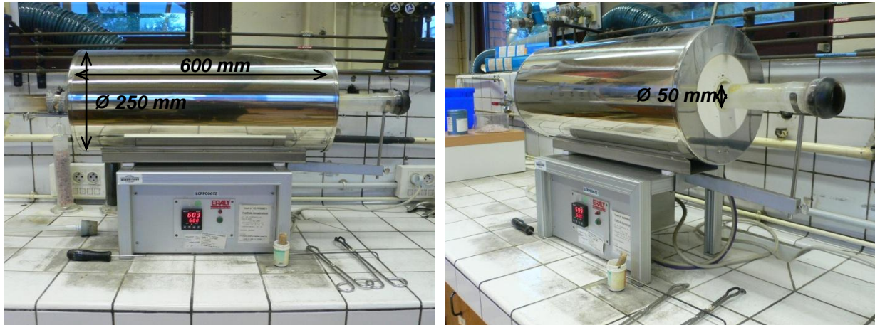
356. Four tubulaire chauffant un échantillon à 603°C
