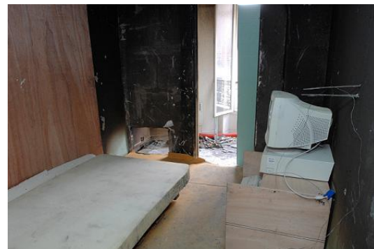
218. Volume expérimental recréé et charge combustible disposée
