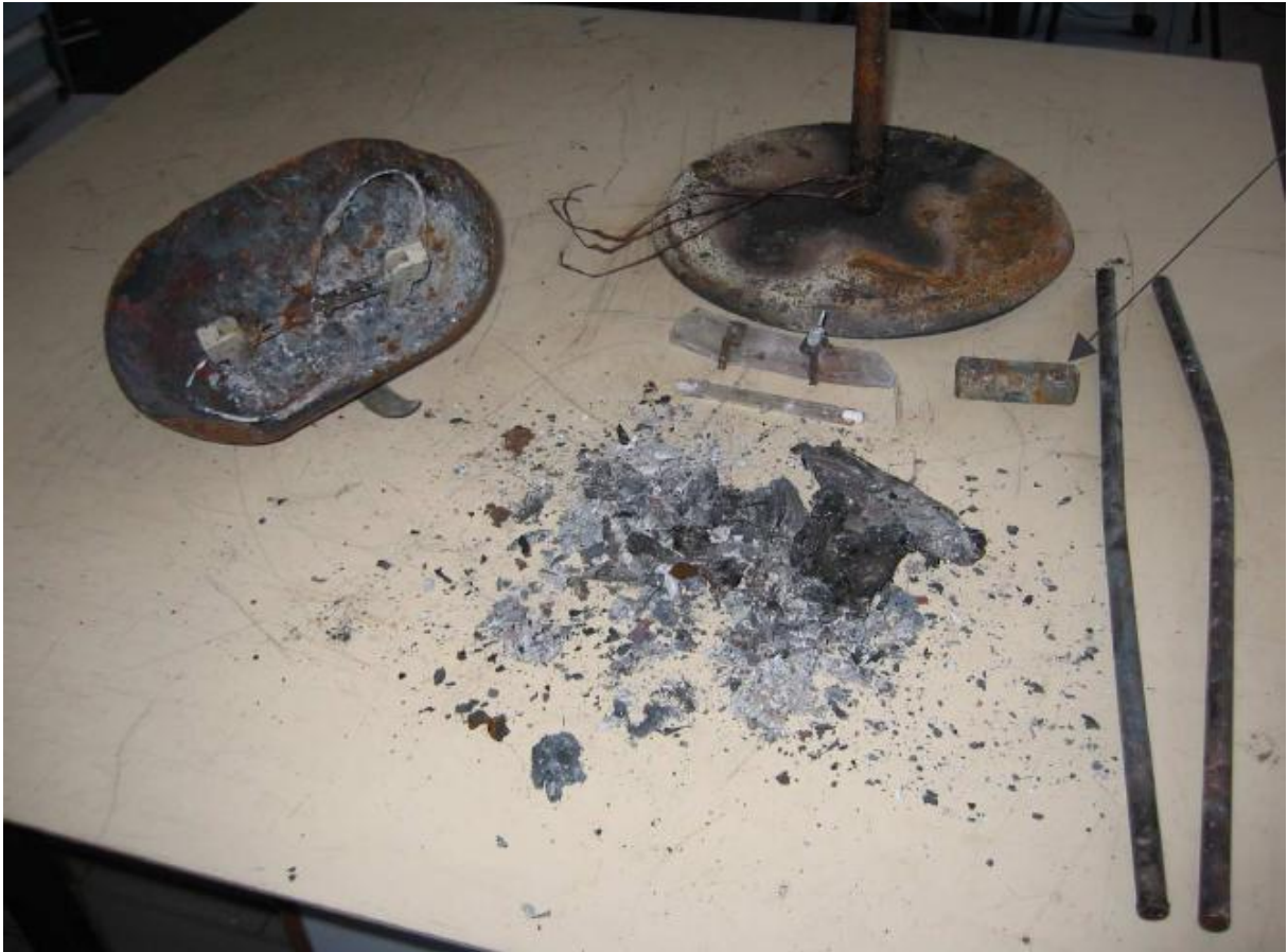
403. Fragments du lampadaire halogène collectés sur les lieux de l'incendie
