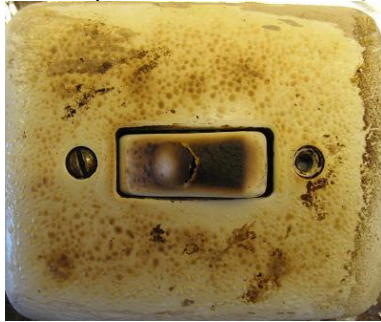
Interrupteur à t_0 + 90 s
