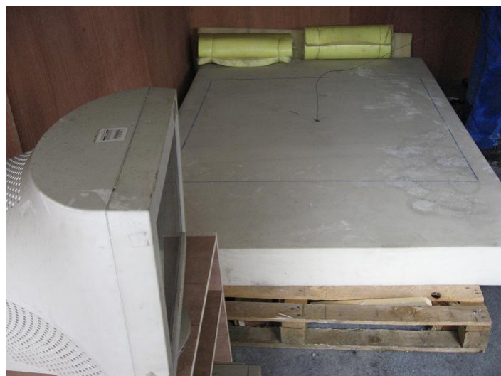
256. Charge calorifique disposée dans la chambre foyer
