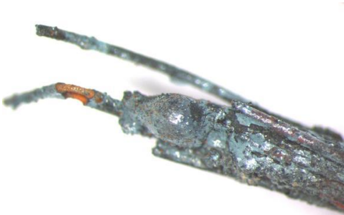
405. Perlage trouvé sur un conducteur électrique au niveau de la fixation d'un des deux tubes supportant la vasque sur l'articulation métallique
