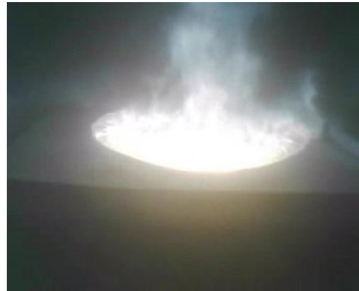
258. Photo du foyer 110 s après l'allumage : les flammes se propagent au coussin
