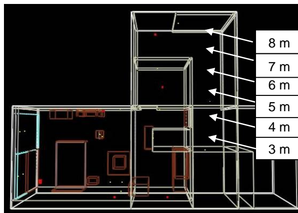
335. Emplacement des points de mesure dans le couloir
