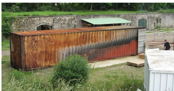
237. Vue extérieure du caisson de transport maritime utilisé pour la combustion d'un matelas
