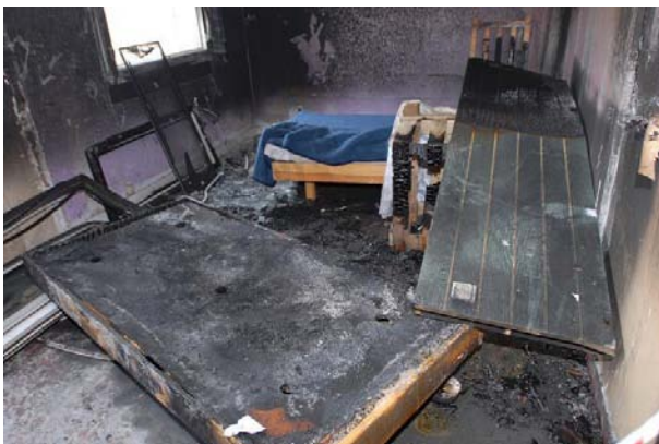
21. Vue de la chambre après l'essai pour lequel l'embrasement généralisé n'est pas atteint
