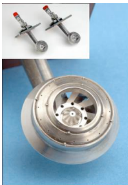
FIGURE 2.10: Photo d'un système d'injection multi-points : vue globale et rapprochée (source SNECMA)
