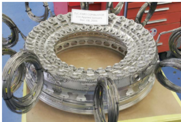
FIGURE 2.13: Photo d'une chambre annulaire TVC avec instrumentation
