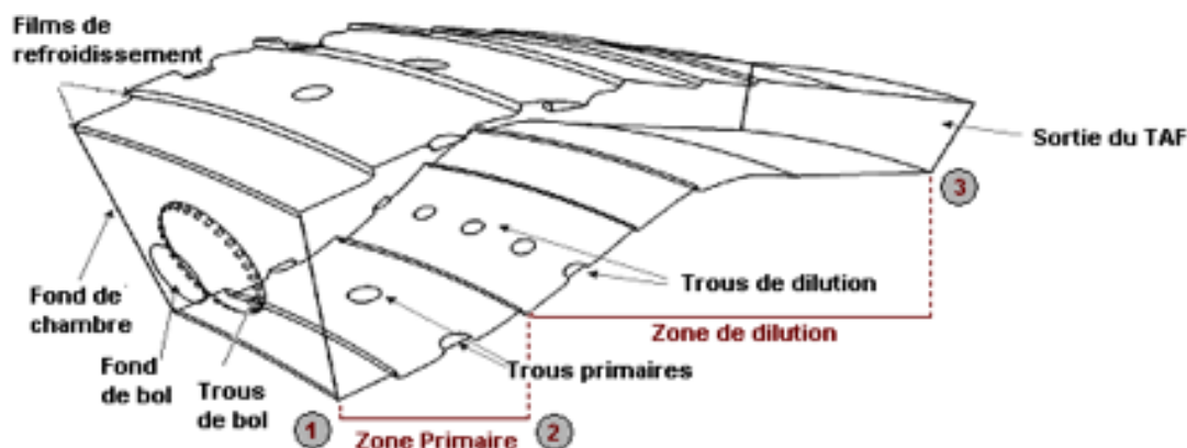
FIGURE 2.8: Schéma d'un tube à flamme
