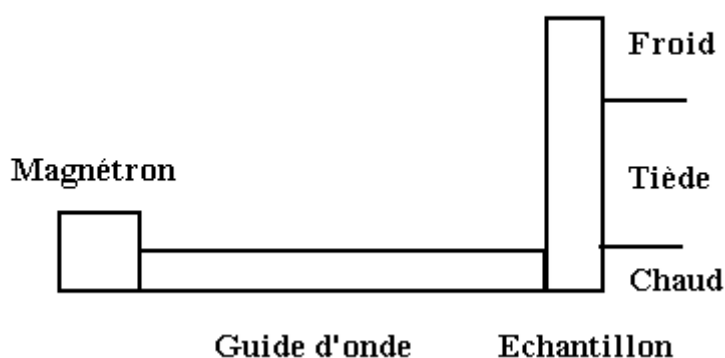
Figure 2.2: Principe de fonctionnement d'un four multimode
