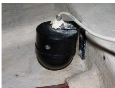
Le compas fluxgate pour être précis doit être monté loin des masses métalliques telles que moteur, ancre ou chaînes. Il est intéressant de le monter le plus près possible du centre de gravité du bateau afin qu'il soit moins exposé aux mouvements du bateau.
