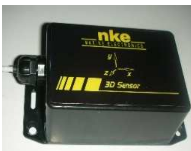
La centrale inertielle fait la taille d'une boîte d'allumette et pèse 270g. Elle délivre ses informations à 25Hz.
