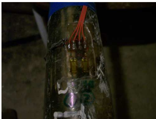
Deux des quatre jauges collées directement sur la mèche de safran. Un méplat a été pratiqué sur la surface conique de la mèche de safran car les jauges sont plates et doivent le rester si on veut conserver leurs caractéristiques techniques. Un autre méplat identique a été creusé de l'autre côté pour accueillir les deux autres jauges qui sont alors reliées entre-elles pour former un pont de Wheatstone.
