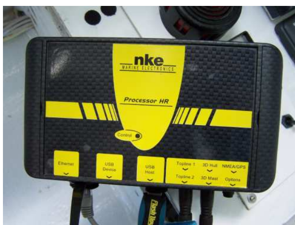
Le processorHR a été conçu à l'origine pour traiter les données de centrales inertielles à hautes cadences. Il prend finalement en charge la commande de barre et permet d'intervenir à façon sur l'ensemble de l'installation (on peut par exemple définir un autre graphisme pour les caractères ou symboles apparaissant sur les répéteurs).
