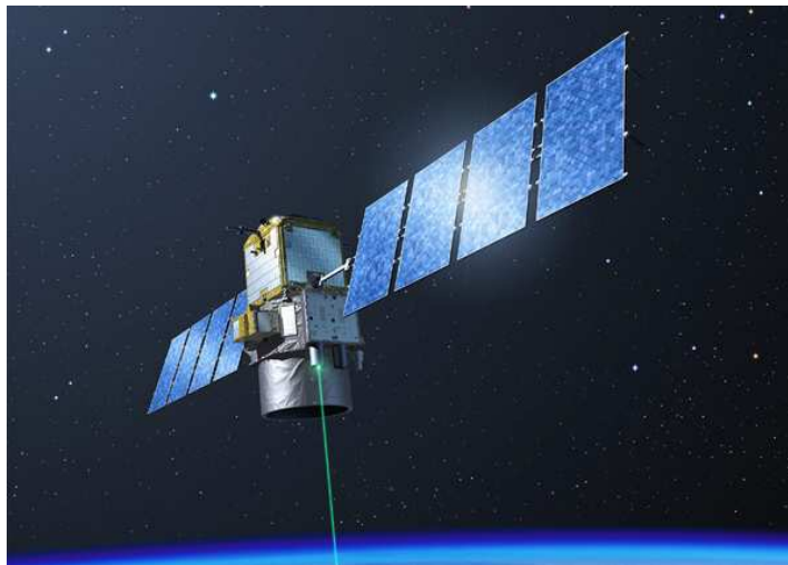
Fig. II.3 : Vue d'artiste du satellite CALIPSO embarquant à son bord le lidar CALIOP. (Image CNES)
