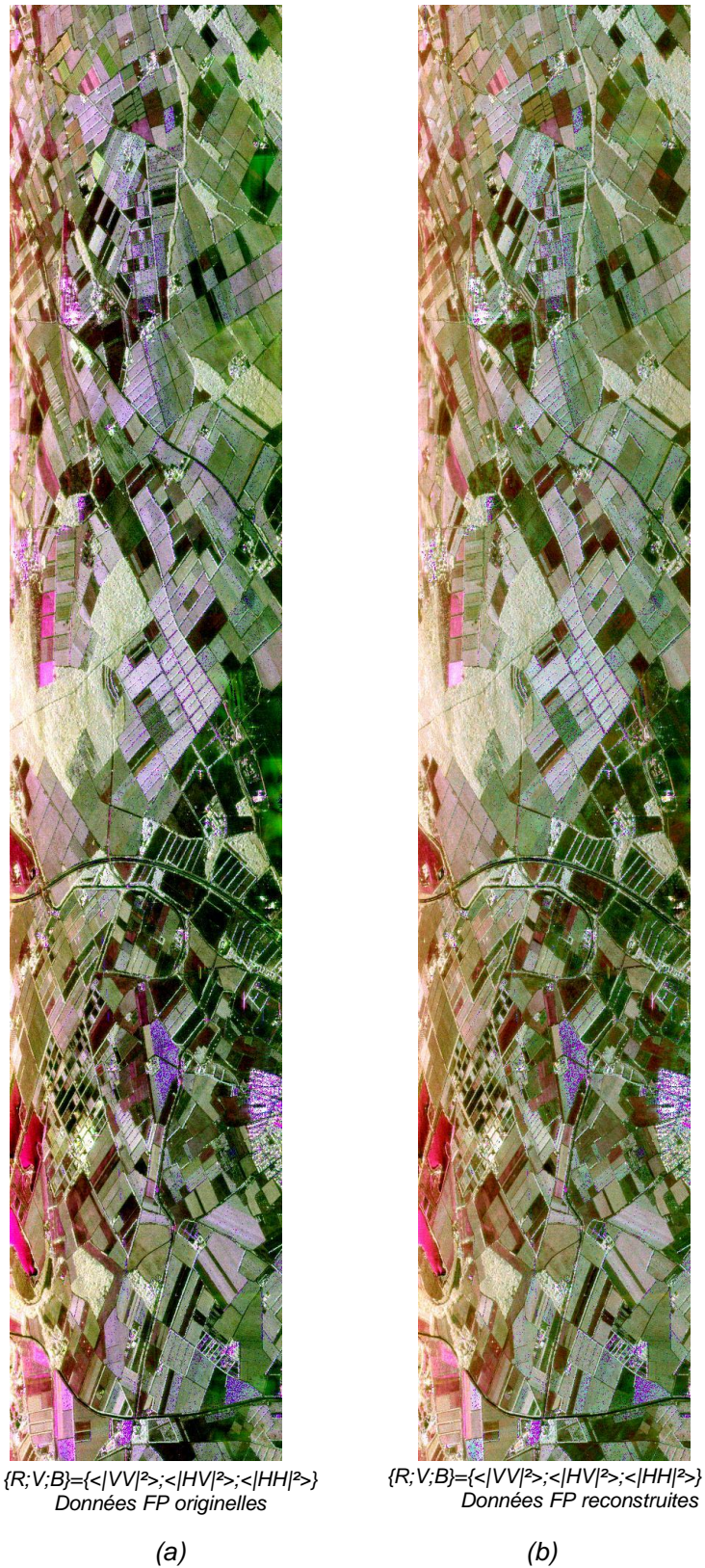
Fig.9.3 : (a) Représentation colorée des données full-pol originelles et (b) full-pol reconstruites à partir des données compact-pol en utilisant l'algorithme de Souyris et al.. Les données compact-pol utilisées sont celles construites à partir des données full-pol brutes (processus 2).
