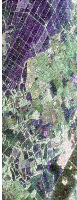
Fig.2.2 : Représentation de Pauli  $\{R;V;B\} = \{S_{HH}-S_{VV}; 2*S_{HV}; S_{HH}+S_{VV}\}$
