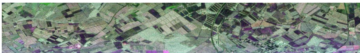
Fig.4.10 : Image FP \{R;V;B\}=\{S_{HH},S_{HV},S_{VV}\} acquise par le radar SETHI en bande L sur la zone de Garons.
