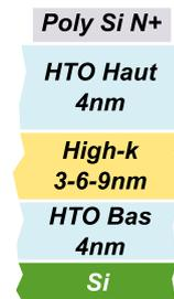
FIG. 3.6: Structure capacitive tricouche étudiée.
