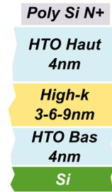
**FIG. 3.11:** Structure capacitive tricouche étudiée.
