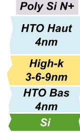
FIG. 3.24: Structure capacitive tricouche étudiée.
