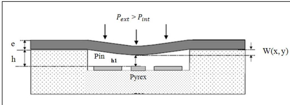
Fig II. 15. Schéma en coupe du Capteur en fonctionnement
