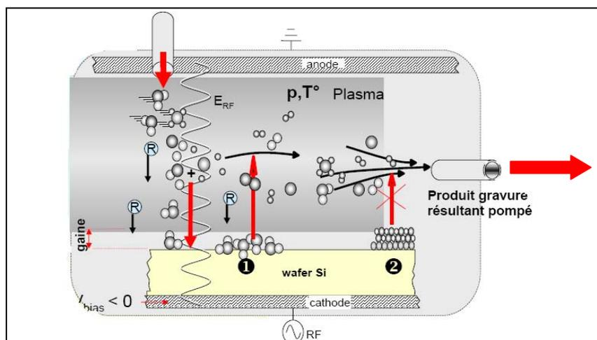
Fig III. 11. Principe de la gravure RIE
