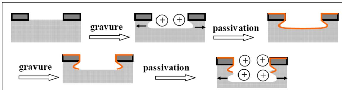
Fig III. 12. Principe de la gravure DRIE
