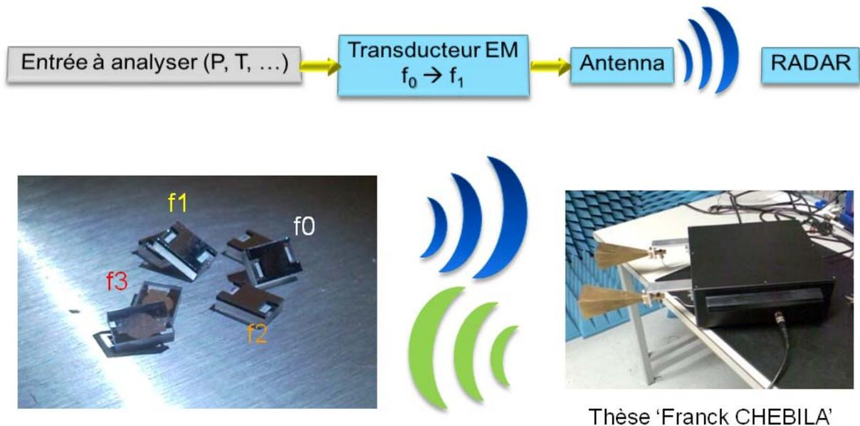
**Fig IV. 1. Chaîne de mesure Radar**
