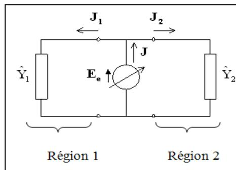
Fig II. 5. Représentation par un schéma équivalent des conditions aux limites
