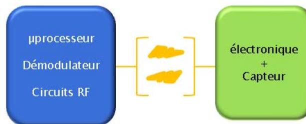
**Fig I. 2. Principe de fonctionnement d'un dispositif RFID**
