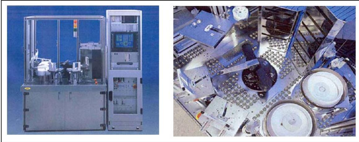
**Fig III. 8. Machine d'enduction et de développement de résine automatique (EVG 620)**
