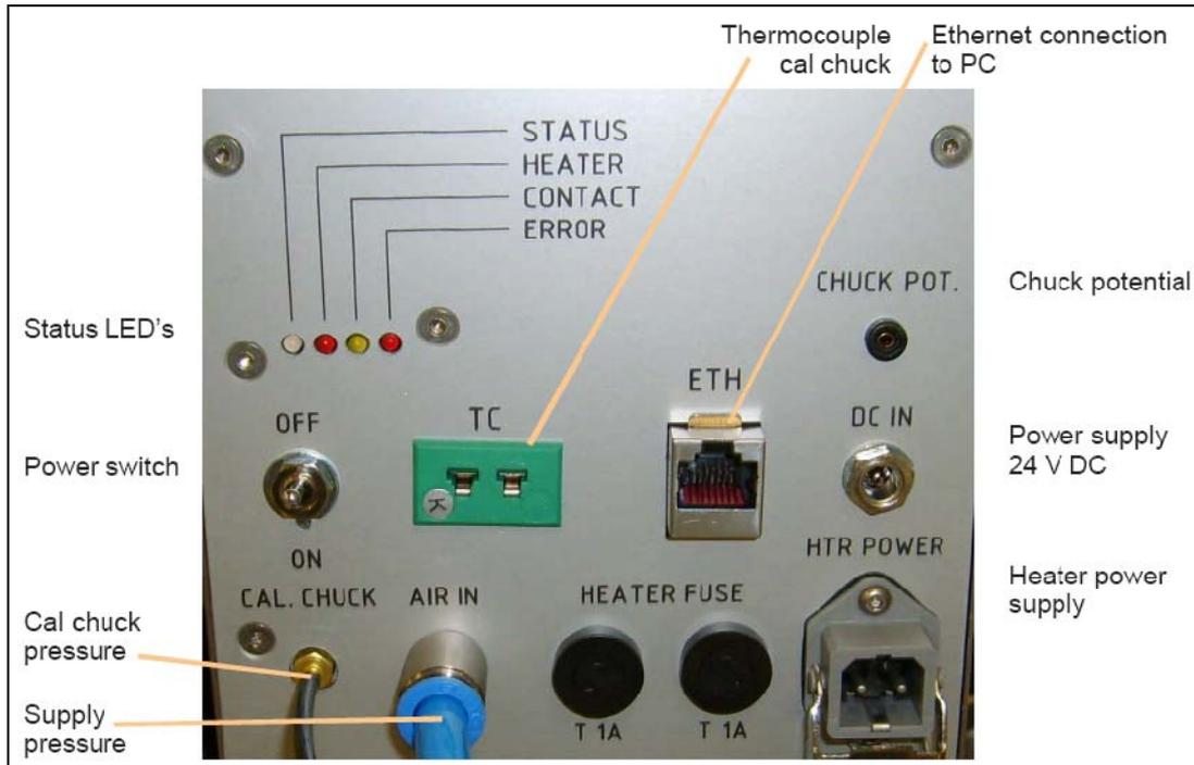
Fig III. 28. Côté arrière de l'unité de pression
