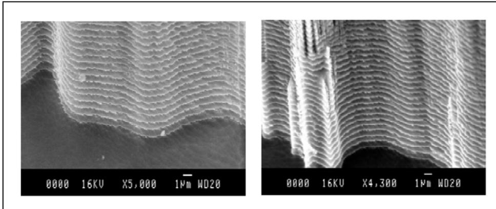
**Fig III. 13. Rugosité des plans de gravure DRIE [24]**
