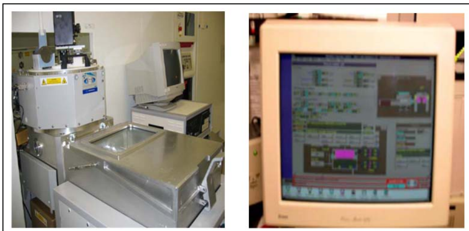
Fig III. 14. Machine de gravure RIE (coté salle blanche) et l'écran de contrôle process
