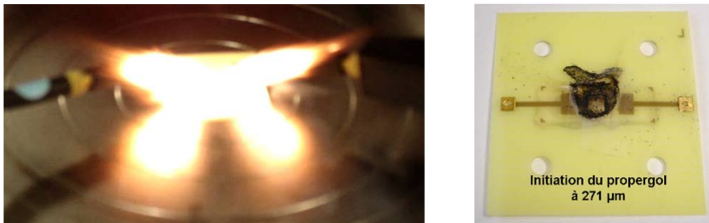
Figure 80. (a) : initiation du propergol par la nanothermite. (b) : état du dispositif après initiation
