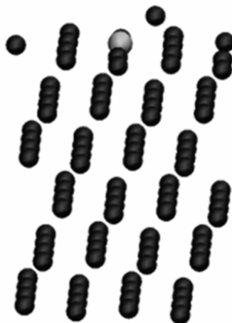
Figure 93. Adsorption d'un atome d'Al sur la surface de Ni - position substitutionnelle (l'atome de Ni se trouve à 0.85 Å de la surface) – l'atome d'Al est représenté en gris et les atomes de Ni en noir
